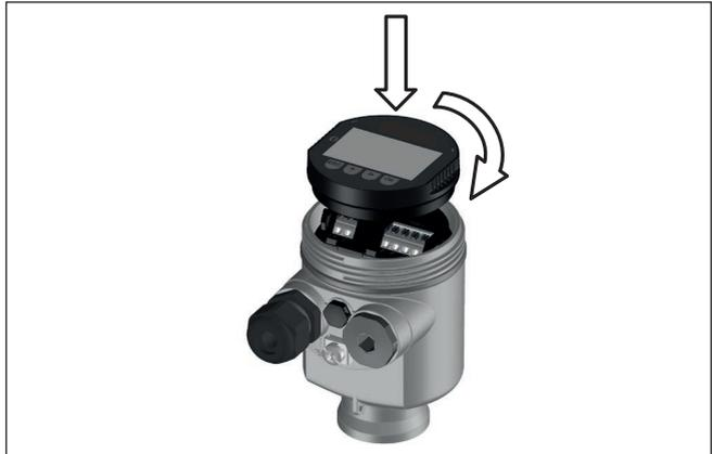
Abb. 17: Einsetzen des Anzeige- und Bedienmoduls beim Einkammergehäuse im Elektronikraum
