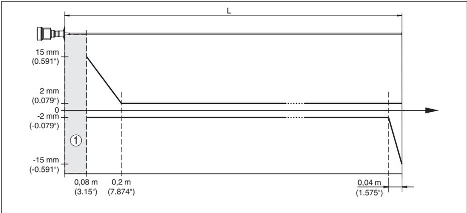
Abb. 30: Messabweichung VEGAFLEX 83 in Stabausführung in Medium Wasser
