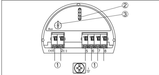
Abb. 12: Elektronikraum - Zweikammergehäuse
