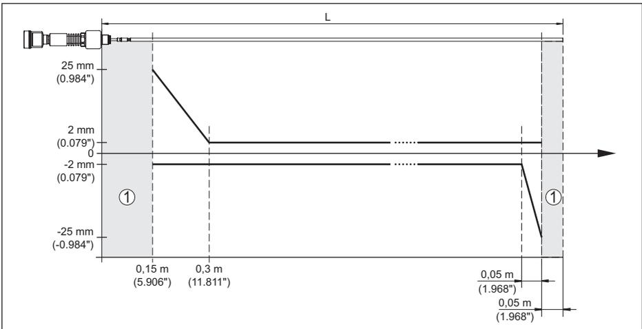
Abb. 35: Messabweichung VEGAFLEX 86 in Stabausführung in Medium Öl
