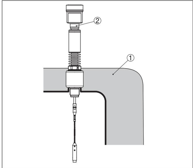
Abb. 11: Montage des Gerätes bei isolierten Behältern.
