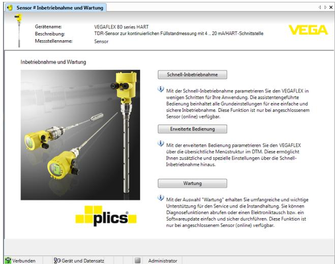
Abb. 28: Schnellinbetriebnahme auswählen
