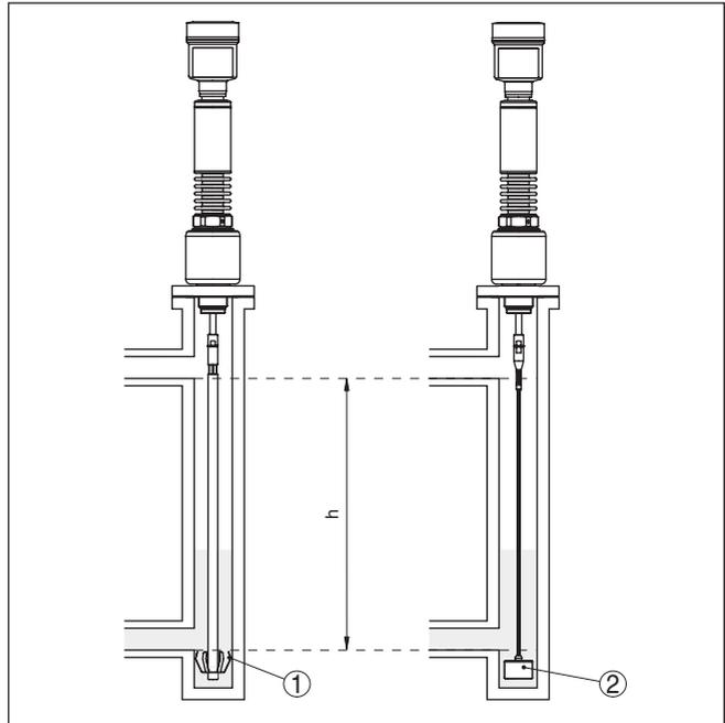
Abb. 9: Position des Zentriersterns bzw. des Zentriergewichts
