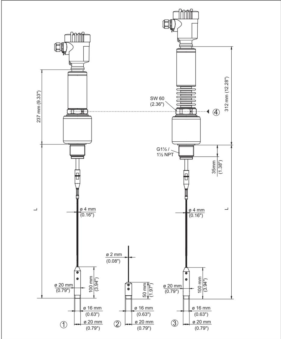
Abb. 51: VEGAFLEX 86, Gewindeausführung mit Straffgewicht (alle Straffgewichte mit Gewinde M8 für Ringschraube)
