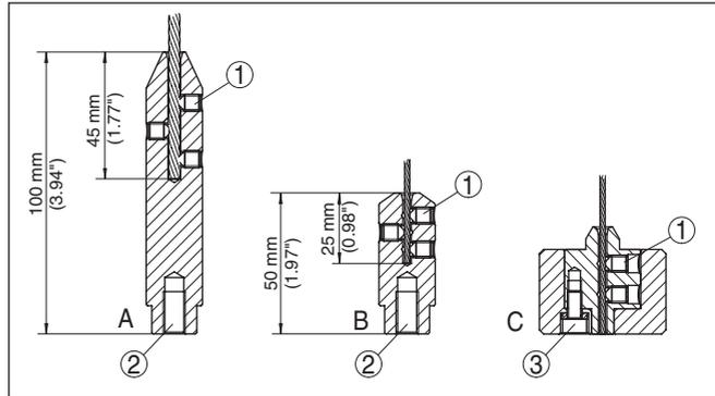
Abb. 32: Seilmesssonde kürzen
