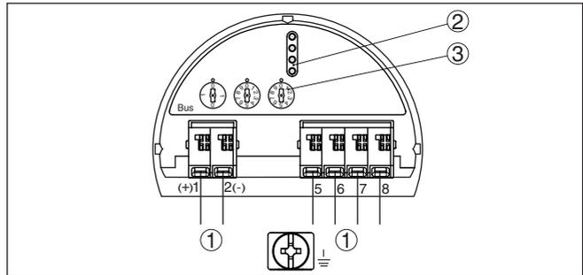
Abb. 16: Elektronikraum - Zweikammergehäuse
