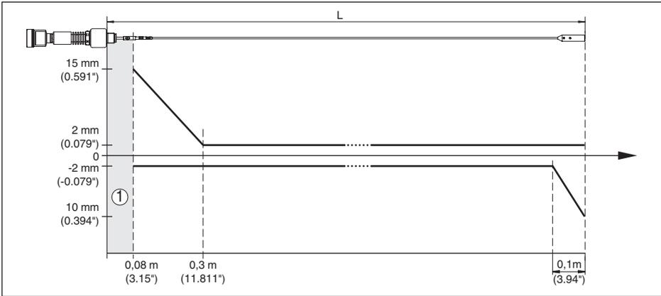
Abb. 36: Messabweichung VEGAFLEX 86 in Seilausführung in Medium Wasser
