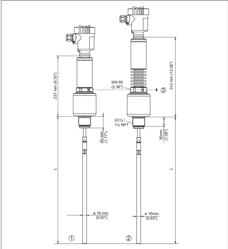
Abb. 53: VEGAFLEX 86, Gewindeausführung
