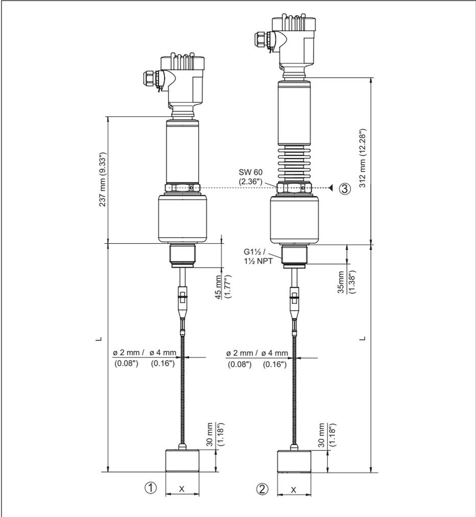
Abb. 52: VEGAFLEX 86, Gewindeausführung mit Zentriergewicht
