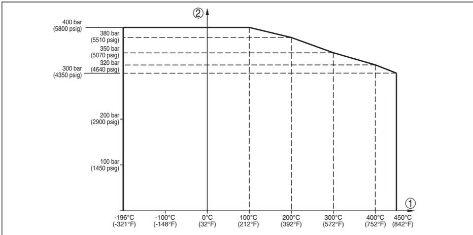
Abb. 42: Prozessdruck - Prozesstemperatur (Ausführung -196 ... +450 °C/-321 ... +842 °F)
