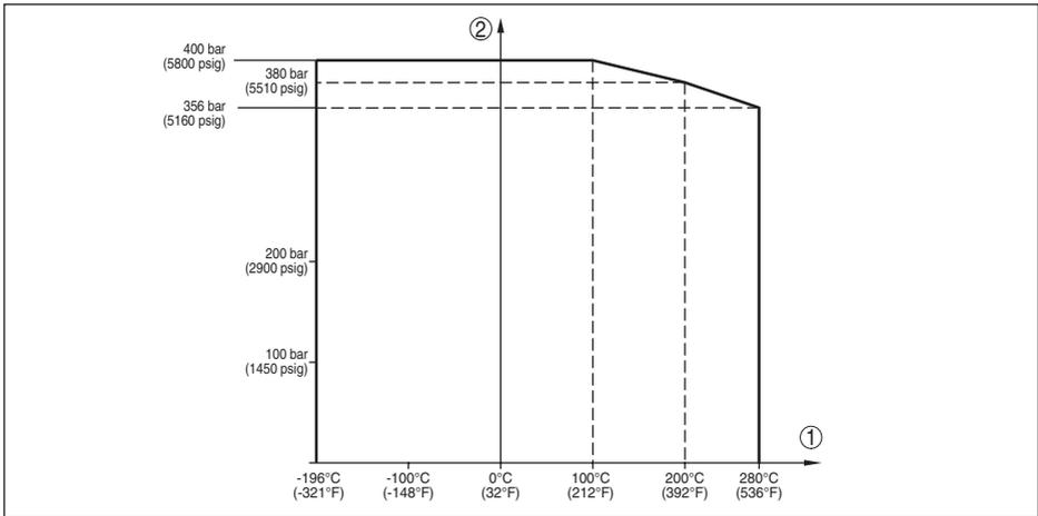
Abb. 41: Prozessdruck - Prozesstemperatur (Ausführung -196 ... +280 °C/-321 ... +536 °F)
