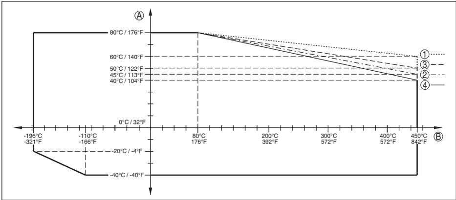
Abb. 40: Umgebungstemperatur - Prozesstemperatur, Standardausführung
