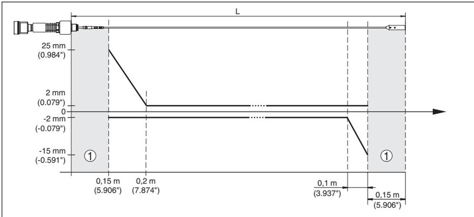
Abb. 38: Messabweichung VEGAFLEX 86 in Seilausführung (4 mm/0.157 in), in Medium Öl
