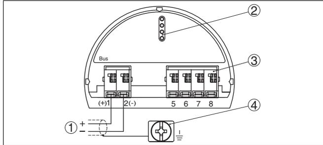
Abb. 17: Anschlussraum - Zweikammergehäuse
