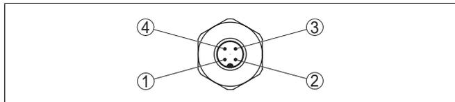
Abb. 19: Sicht auf den M12 x 1-Steckverbinder
