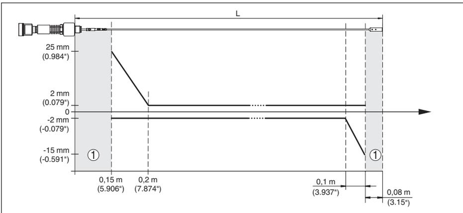
Abb. 37: Messabweichung VEGAFLEX 86 in Seilausführung (2 mm/0.079 in), in Medium Öl
