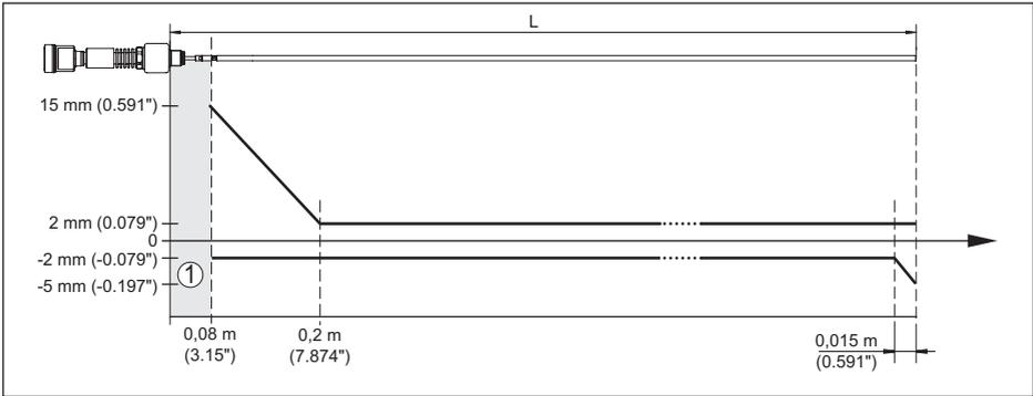
Abb. 34: Messabweichung VEGAFLEX 86 in Stabausführung in Medium Wasser
