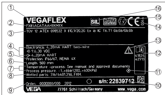
Fig. 1: Opbouw van de typeplaat (voorbeeld)
