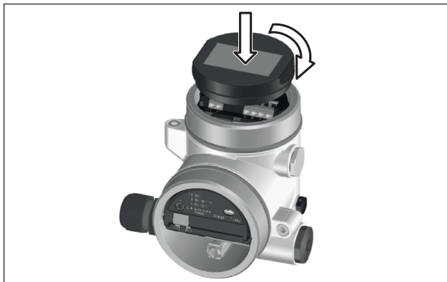
Abb. 16: Einsetzen des Anzeige- und Bedienmoduls
