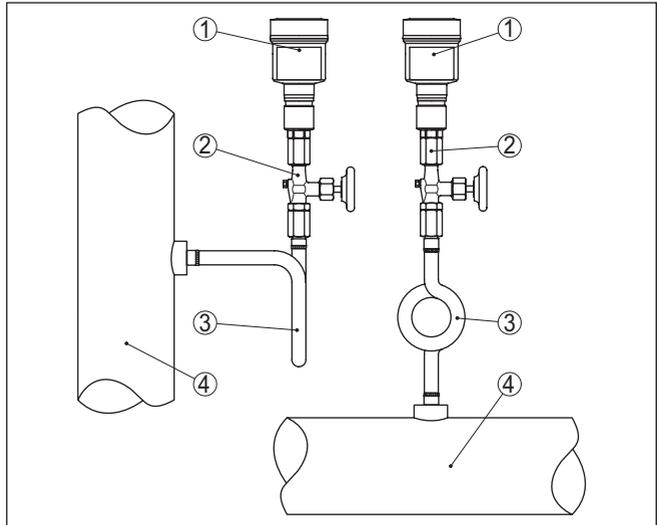
Abb. 12: Messanordnung bei Prozessdruckmessung von Dämpfen in Rohrleitungen
