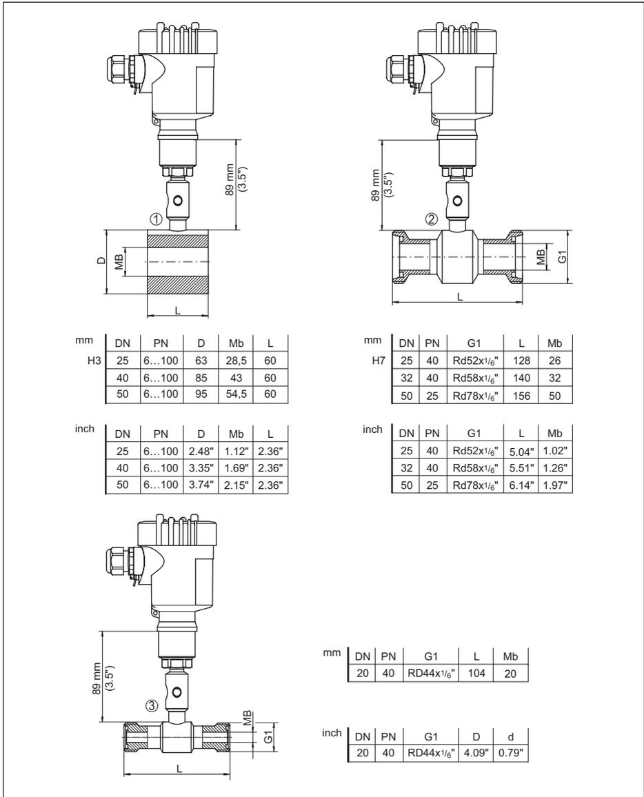
Abb. 59: VEGABAR 81, Rohrdruckmittler
