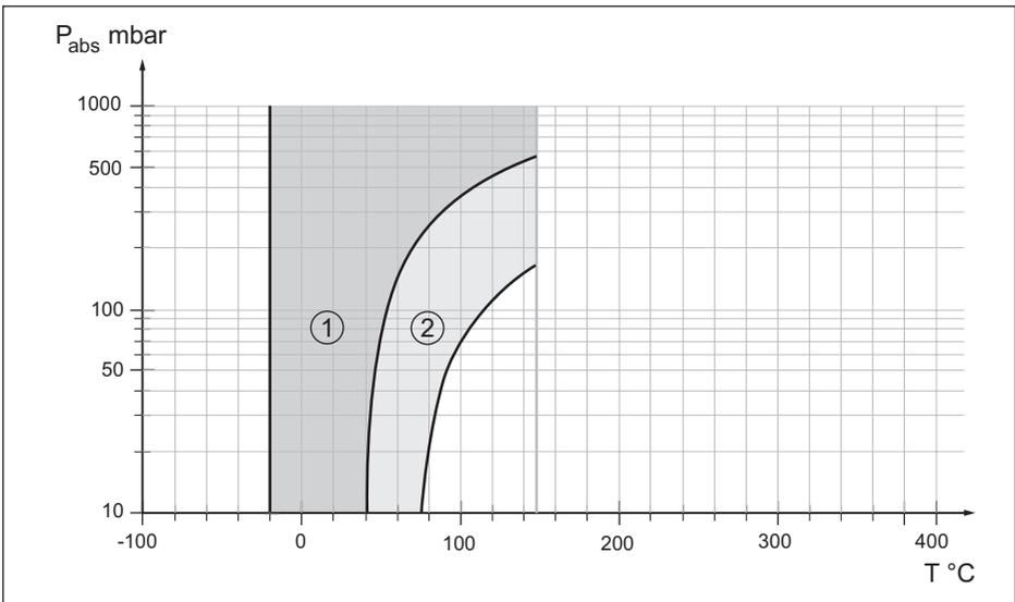
Abb. 50: Einsatzbereich für Neobee M-20 KN 59
