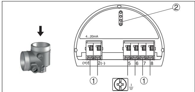
Abb. 18: Elektronikraum - Zweikammergehäuse
