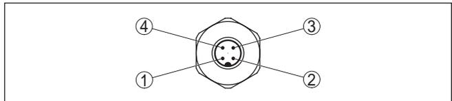
Abb. 25: Sicht auf den M12 x 1-Steckverbinder
