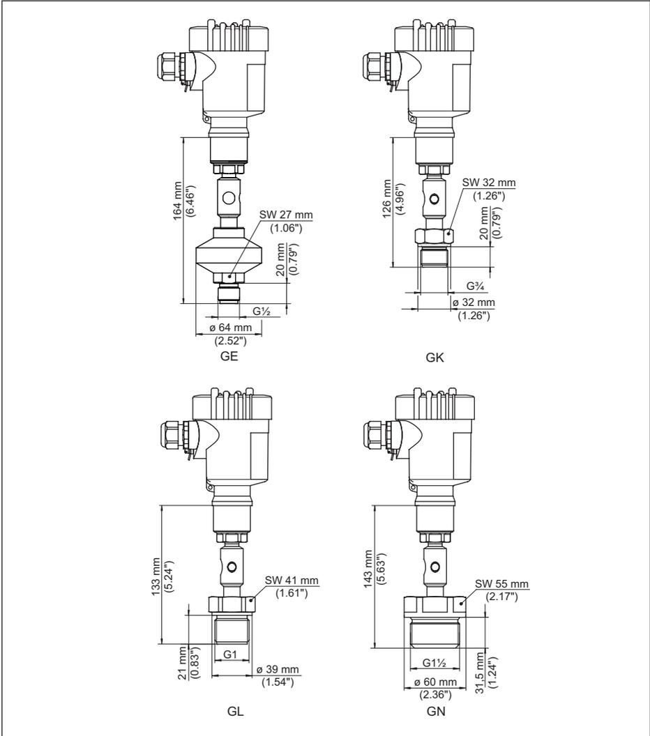
Abb. 58: VEGABAR 81, Gewindeanschluss
