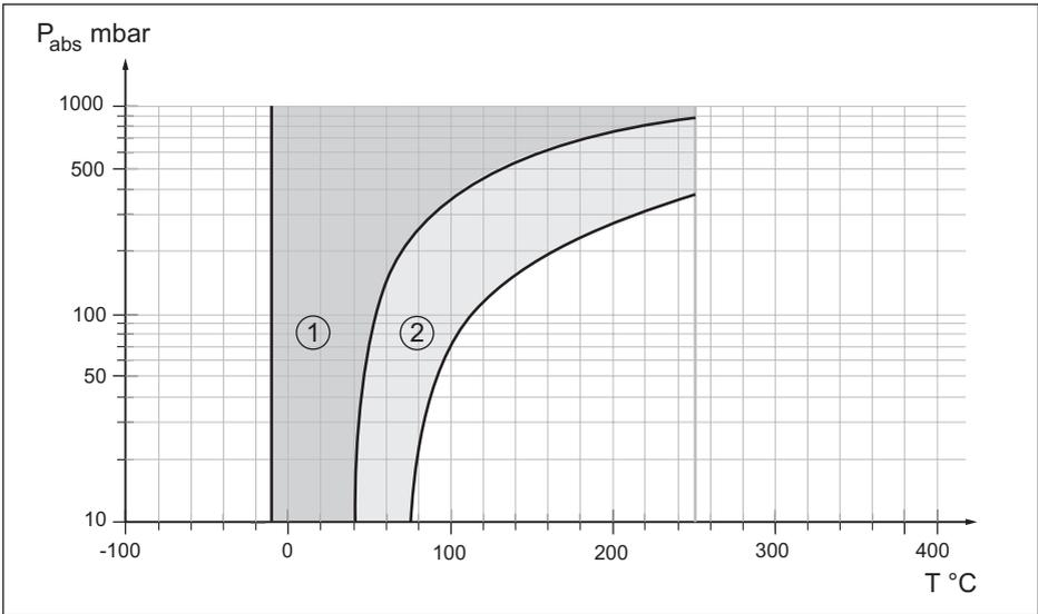
Abb. 49: Einsatzbereich für medizinisches Weißöl KN 92
