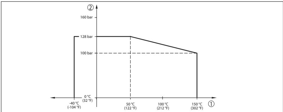
Abb. 44: Temperaturderating VEGABAR 81, Prozessanschlüsse Alloy 400 (2.4360)
