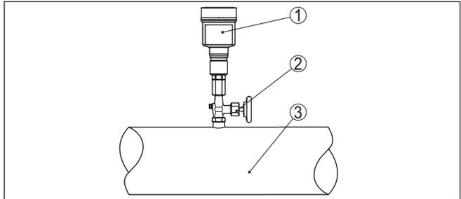
Abb. 11: Messanordnung bei Prozessdruckmessung von Gasen in Rohrleitungen
