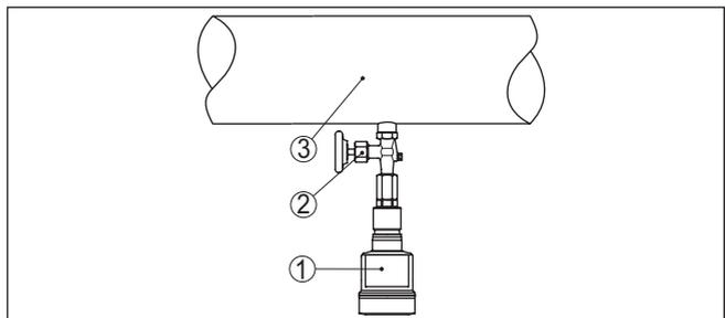
Abb. 13: Messanordnung bei Prozessdruckmessung von Flüssigkeiten in Rohrleitungen
