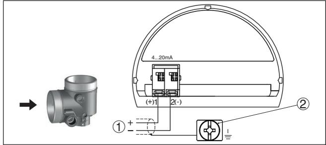
Abb. 23: Anschlussraum - Ex d ia-Zweikammergehäuse
