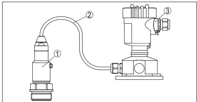
Abb. 27: VEGABAR 81 in IP68-Ausführung 25 bar mit axialem Kabelabgang, externes Gehäuse
