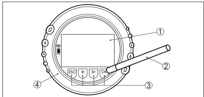
Abb. 35: Anzeige- und Bedienelemente - mit Bedienung über Magnetstift
