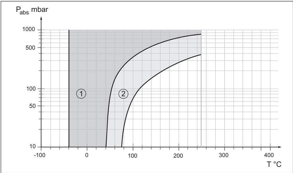
Abb. 45: Einsatzbereich für Silikonöl VE 2.2, KN 2.2
