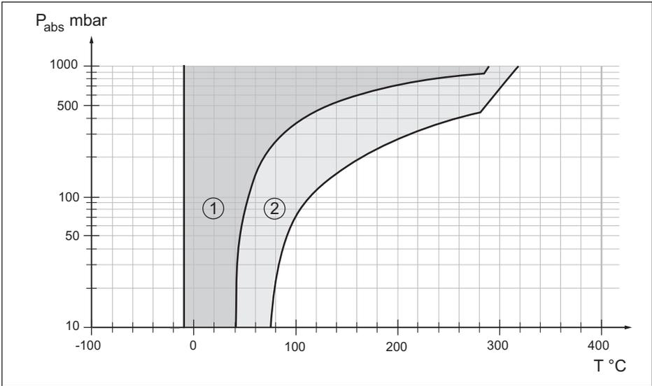
Abb. 47: Einsatzbereich für Hochtemperaturöl VE 32, KN 32
