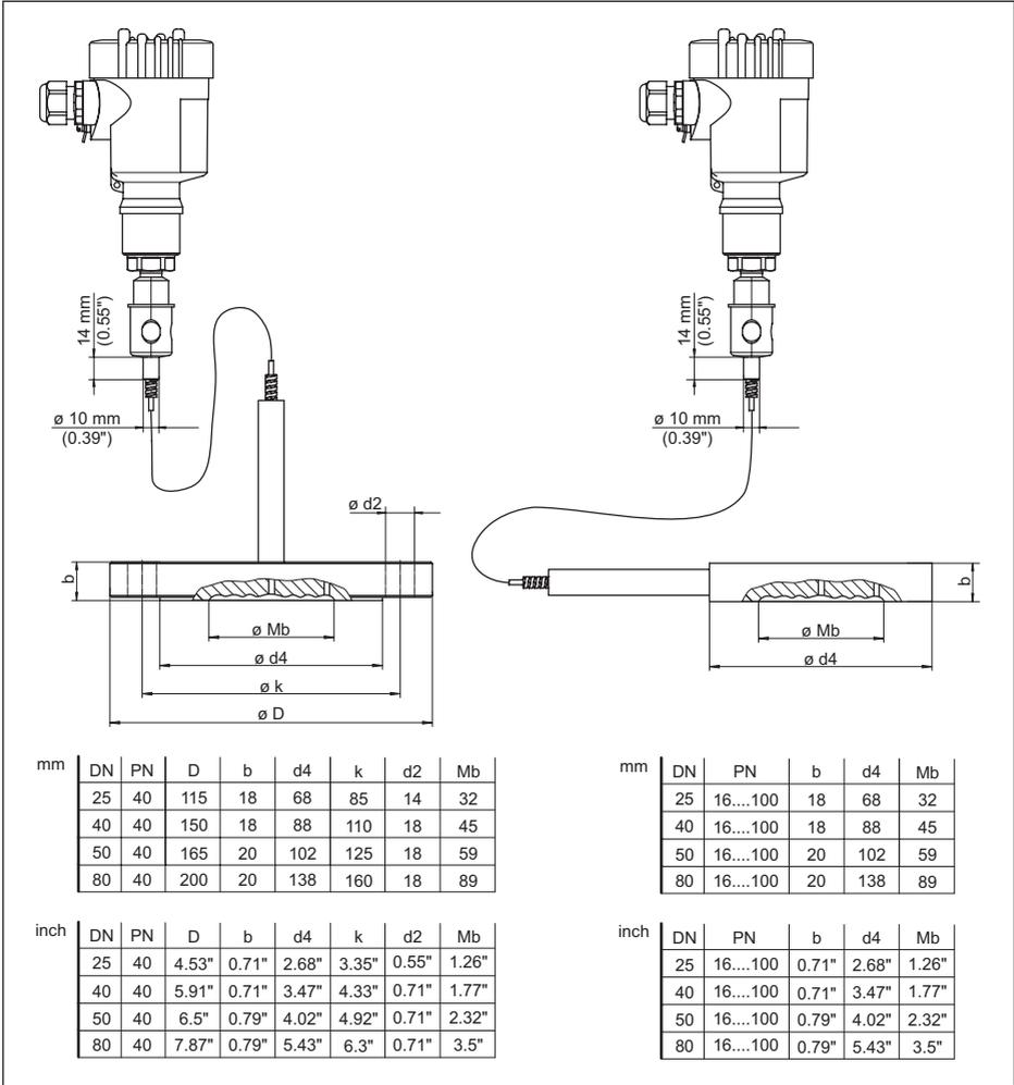
Abb. 62: VEGABAR 81, Flansch- und Zellendruckmittler mit Kapillarleitung
