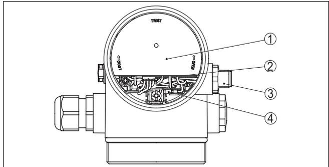
Abb. 24: Sicht auf den Elektronikraum mit VEGADIS-Adapter zum Anschluss der externen Anzeige- und Bedieneinheit
