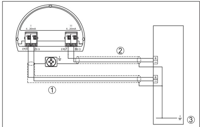
Abb. 31: Anschlussbeispiel VEGABAR 81 zusätzlicher Stromausgang
