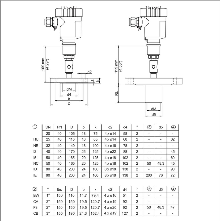
Abb. 60: VEGABAR 81, Flanschanschluss, Maße in mm
