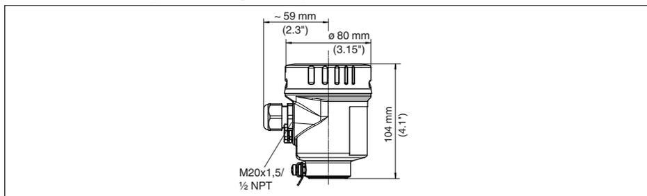
Figura 56: Custodia con grado di protezione IP69K (con tastierino di taratura con display incorporato l'altezza della custodia aumenta di 9 mm/0.35 in)
