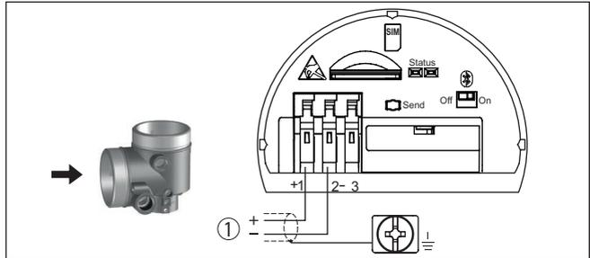
Figura 21: Vano di connessione - modulo radio PLICSMOBILE 81
