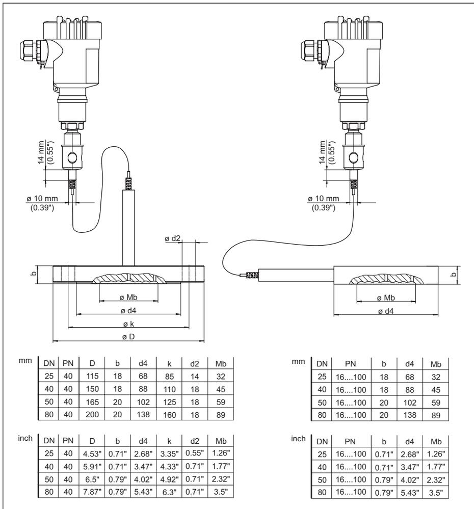
Figura 62: VEGABAR 81, sistema di separazione a flangia e a cella circolare con capillare
