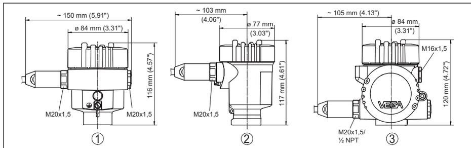
Figura 55: Differenti custodie con grado di protezione IP66/IP68 (1 bar), (con tastierino di taratura con display incorporato l'altezza della custodia aumenta di 9 mm/0.35 in ovv. 18 mm/0.71 in)
