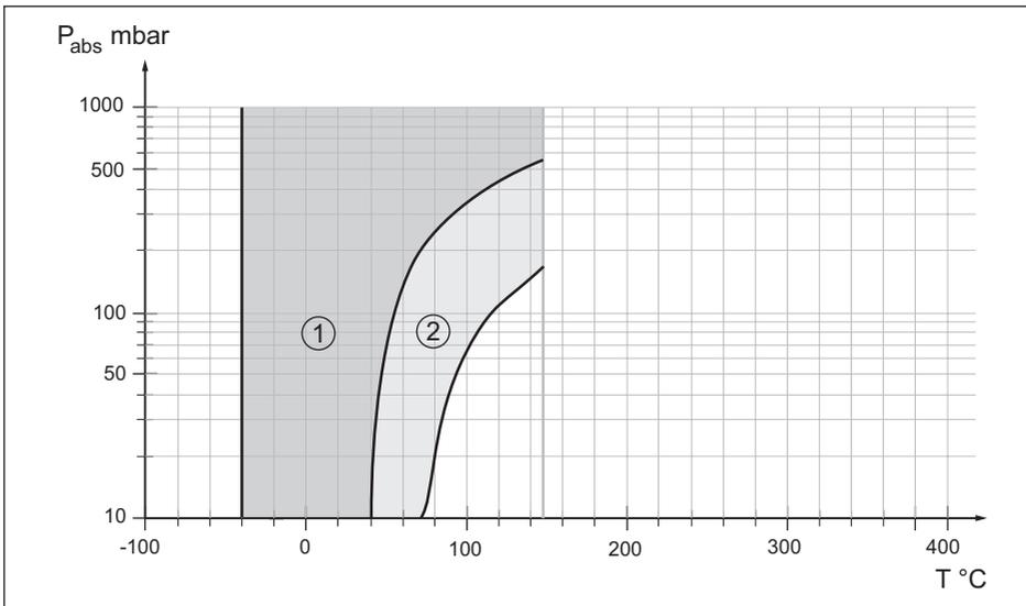
Figura 48: Campo d'impiego per olio Halocarbon KN 21
