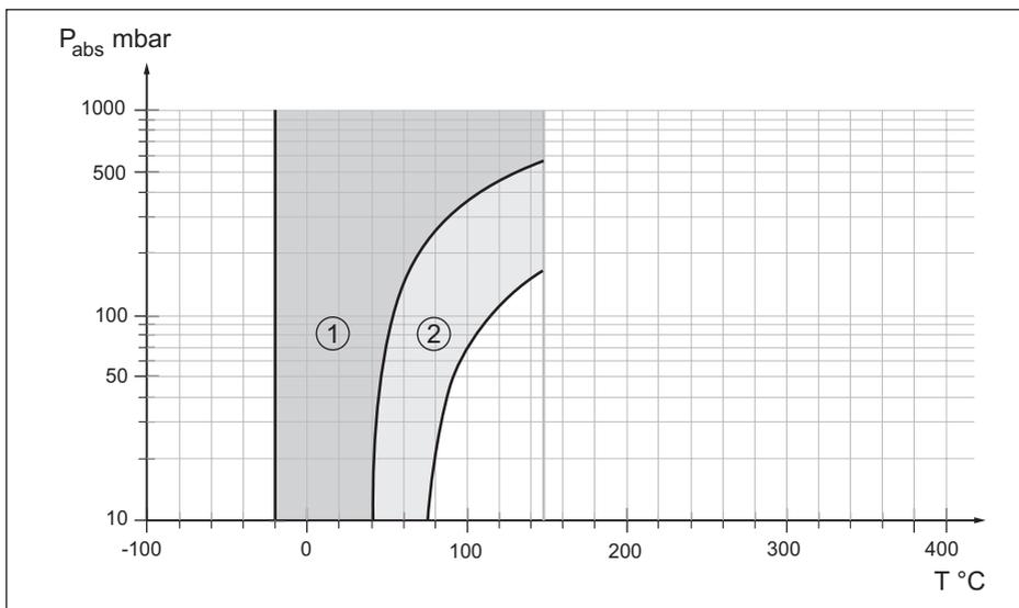
Figura 50: Campo d'impiego per Neobee M-20 KN 59
