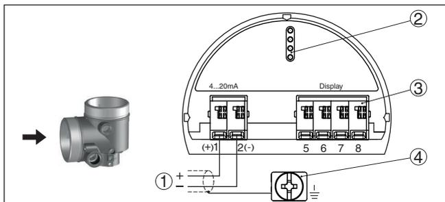
Figura 19: Vano di allacciamento - custodia a due camere
