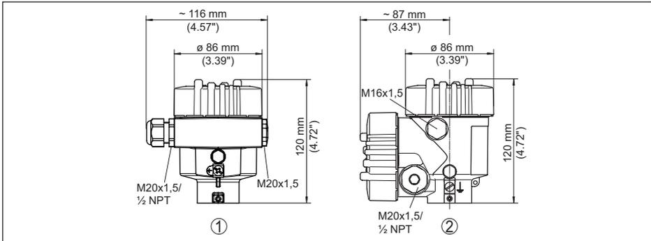
Figura 52: Differenti custodie con grado di protezione IP66/IP68 (0,2 bar), (con tastierino di taratura con display incorporato l'altezza della custodia aumenta di 18 mm/0.71 in)
