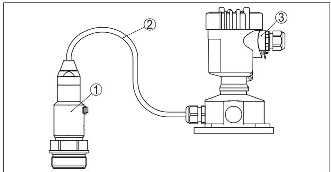
Figura 27: VEGABAR 81 in esecuzione IP68 25 bar con uscita del cavo assiale, custodia esterna
