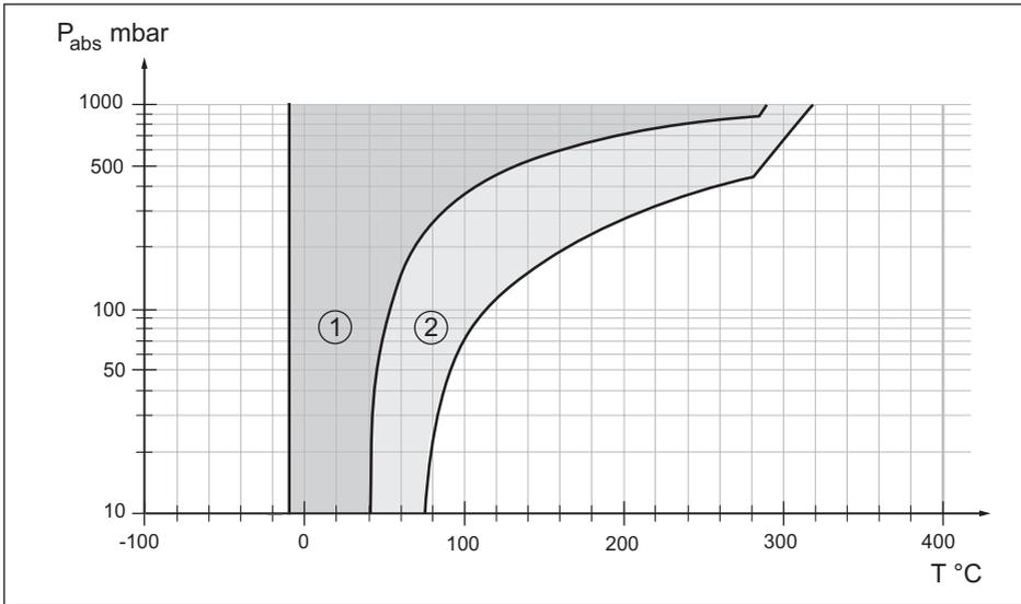
Figura 47: Campo d'impiego per olio per temperature elevate VE 32, KN 32
