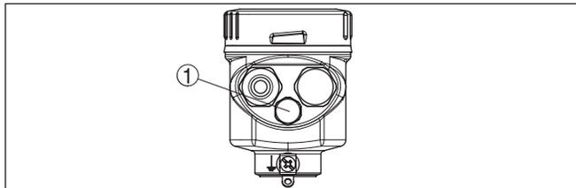
Figura 10: Posizione del filtro - esecuzione IP69K
