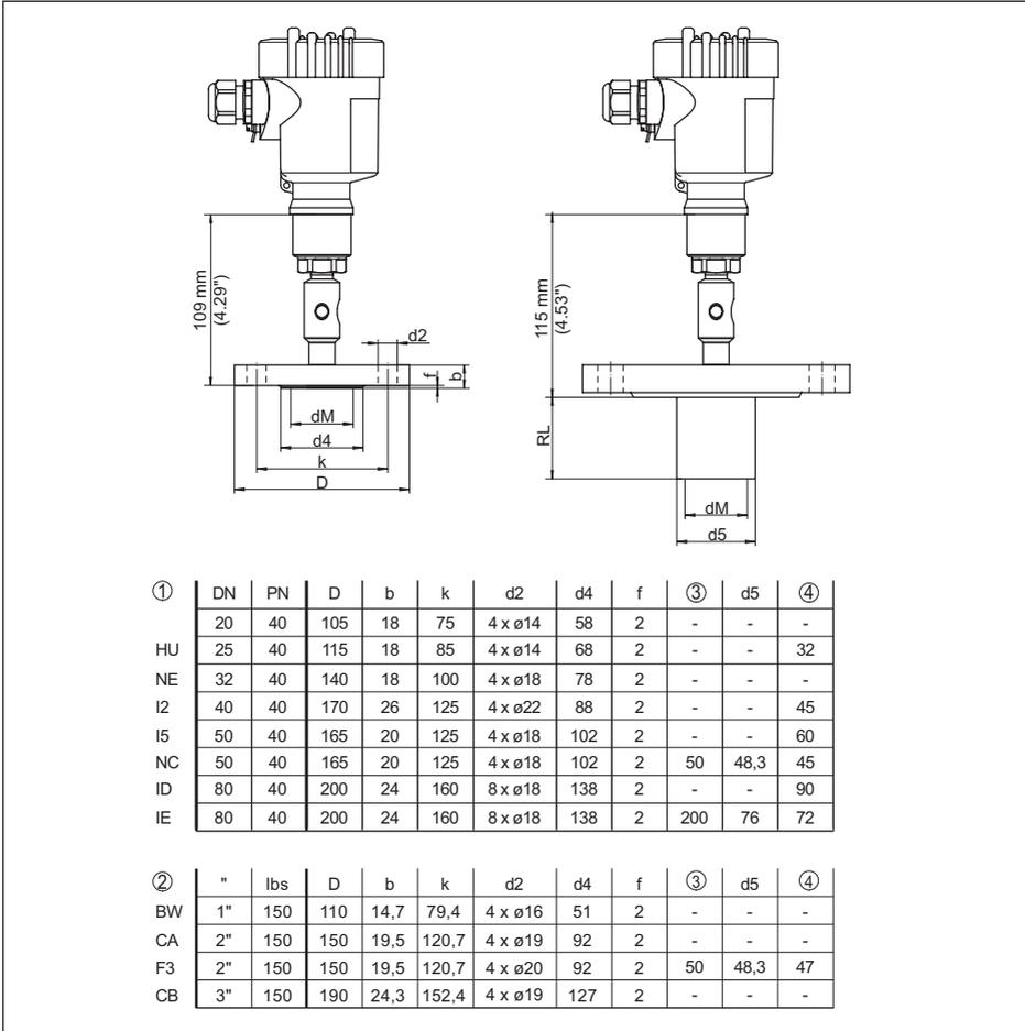
Figura 60: VEGABAR 81 - attacco a flangia, misure in mm
