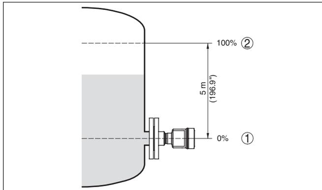
Figura 36: Esempio di parametrizzazione taratura di min./max. per misura di livello
