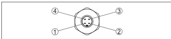
Figura 25: Vista sul connettore a spina M12 x 1
