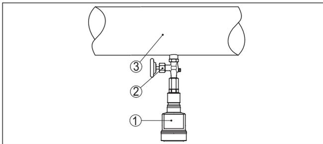
Figura 13: Configurazione di misura per la misura della pressione di processo di liquidi in tubazioni
