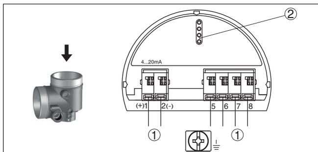
Figura 18: Vano dell'elettronica - custodia a due camere
