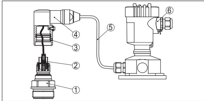
Figura 41: VEGABAR 81 in esecuzione IP68 25 bar e uscita del cavo laterale, custodia esterna
