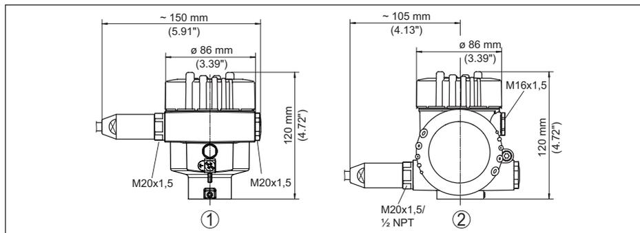
Figura 53: *Differenti custodie con grado di protezione IP66/IP68 (1 bar), (con tastierino di taratura con display incorporato l'altezza della custodia aumenta di 18 mm/0.71 in)*
