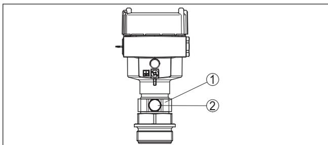
Figura 8: Posizione del filtro - esecuzione Ex d
