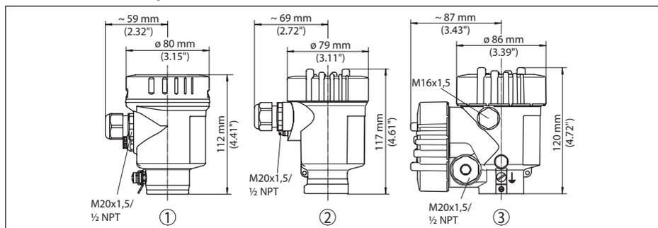
Figura 54: *Differenti custodie con grado di protezione IP66/IP68 (0,2 bar), (con tastierino di taratura con display incorporato l'altezza della custodia aumenta di 9 mm/0.35 in ovv. 18 mm/0.71 in)*
