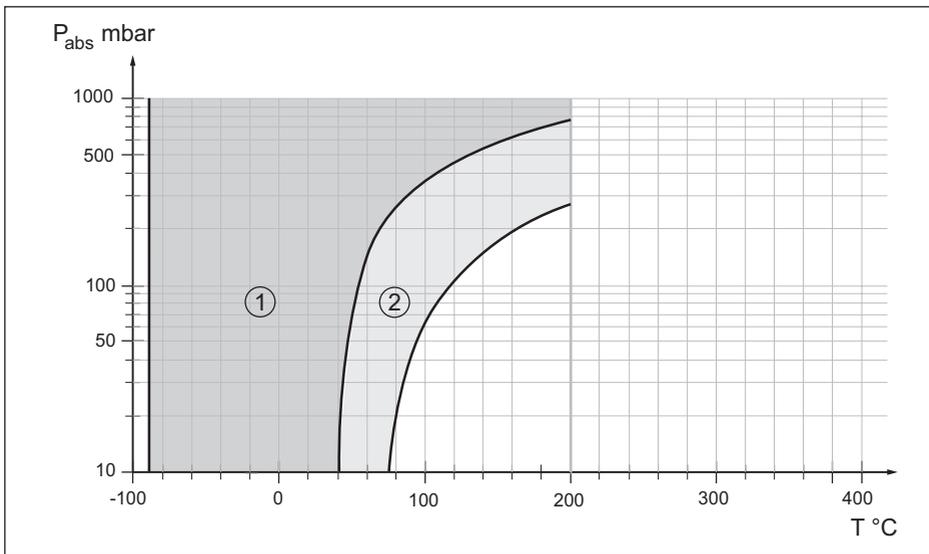
Figura 46: Campo d'impiego per olio silconico KN 17
