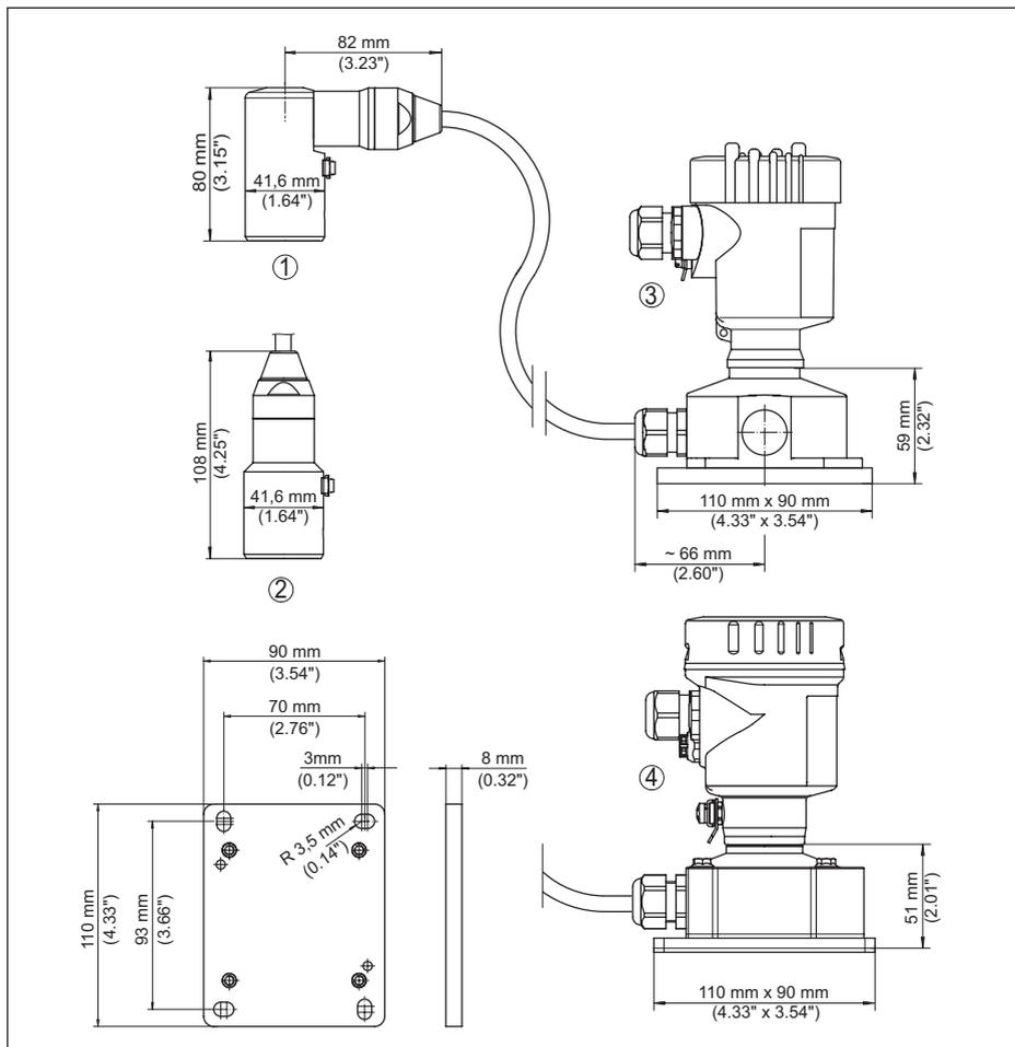
Figura 57: VEGABAR 81, esecuzione IP68 con custodia esterna
