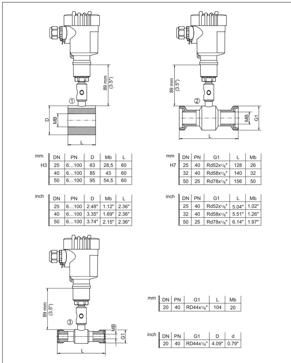
Figura 59: VEGABAR 81- Sistema di separazione su tubo
