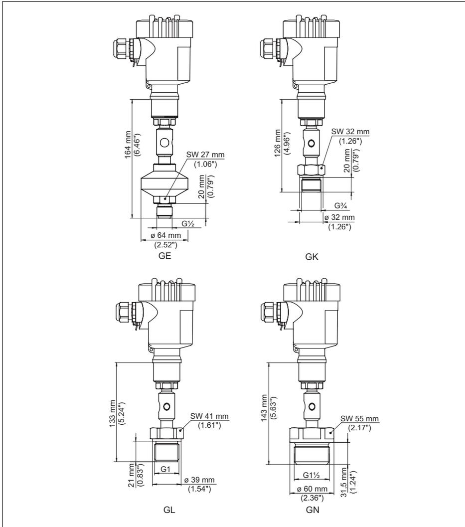
Figura 58: VEGABAR 81, attacco filettato
