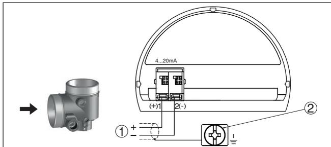
Figura 23: Vano di allacciamento - custodia a due camere Ex d ia
