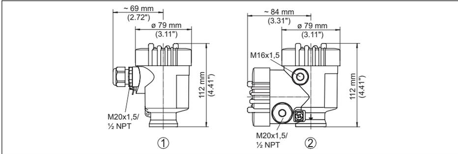
Figura 51: Le differenti custodie con grado di protezione IP66/IP67 (con tastierino di taratura con display incorporato l'altezza della custodia aumenta di 9 mm/0.35 in)
