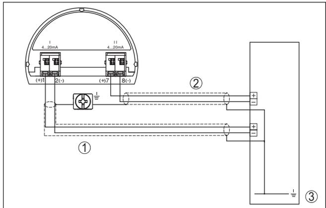
Figura 31: Esempio di connessione VEGABAR 81 uscita in corrente supplementare
