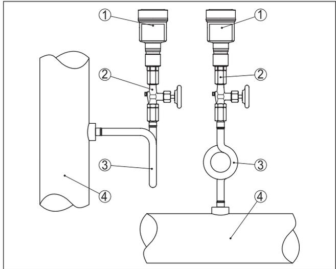
Figura 12: Configurazione di misura per la misura della pressione di processo di vapori in tubazioni
