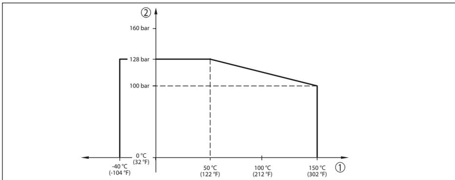
Figura 44: Derating termico VEGABAR 81, attacchi di processo lega 400 (2.4360)
