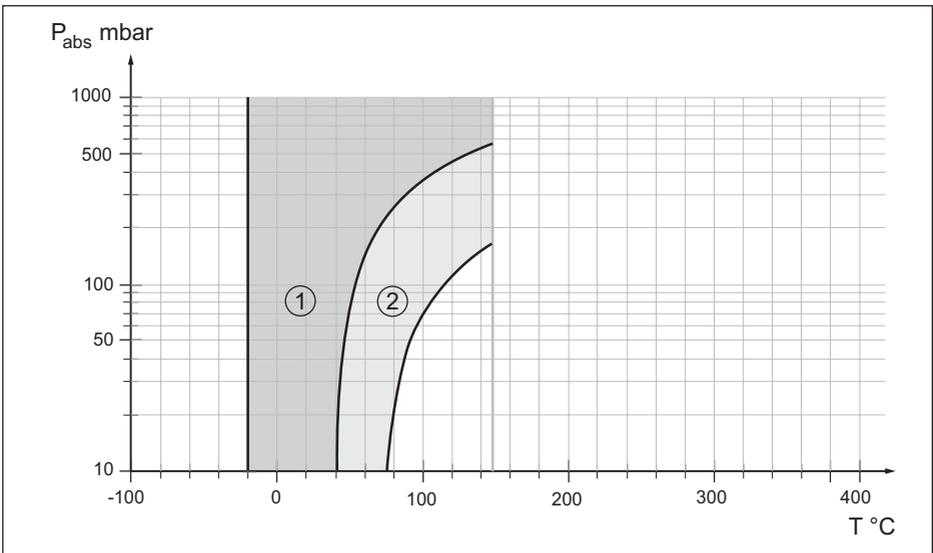
Abb. 42: Einsatzbereich für Neobee M-20 KN 59
