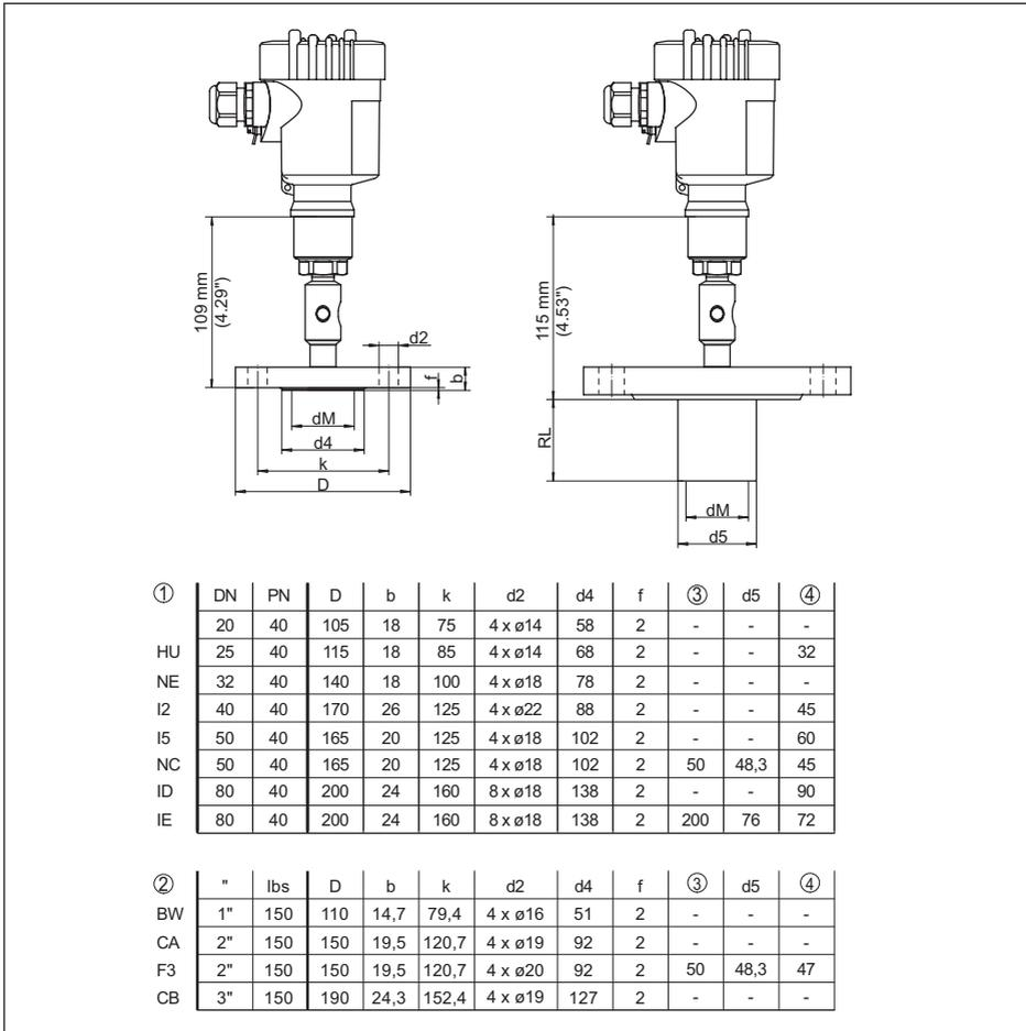
Abb. 55: VEGABAR 81, Flanschsanschluss, Maße in mm
