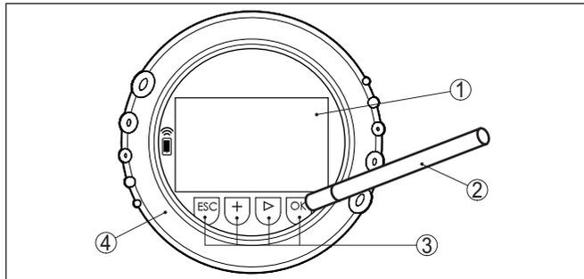
Abb. 29: Anzeige- und Bedienelemente - mit Bedienung über Magnetstift
