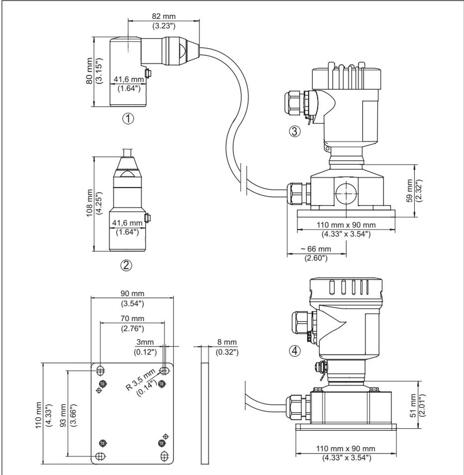
Abb. 52: VEGABAR 81, IP68-Ausführung mit externem Gehäuse
