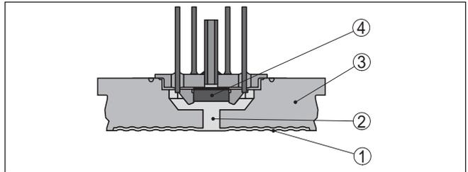
Abb. 3: Aufbau des Messsystems mit piezoresistivem Sensorelement
