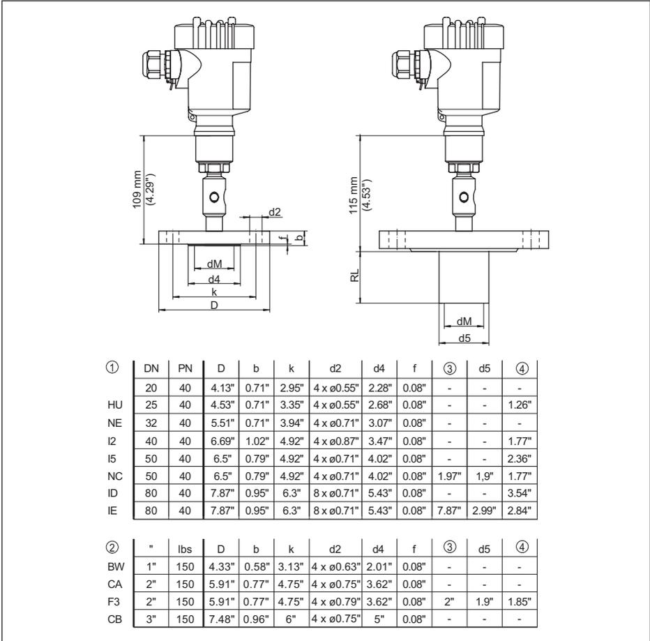
Abb. 56: VEGABAR 81, Flanschanschluss, Maße in inch
