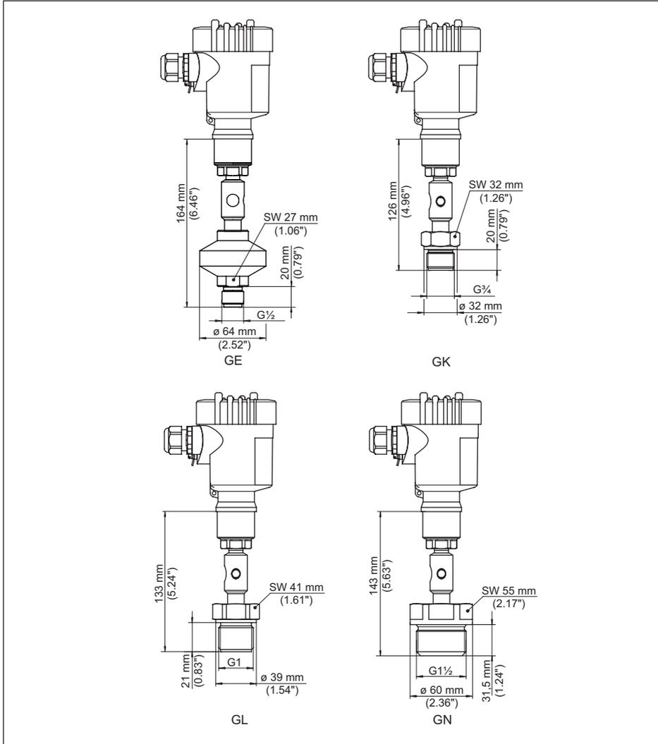
Abb. 53: VEGABAR 81, Gewindeanschluss
