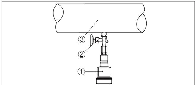
Abb. 12: Messanordnung bei Prozessdruckmessung von Flüssigkeiten in Rohrleitungen
