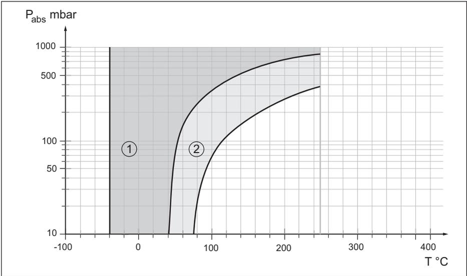
Abb. 37: Einsatzbereich für Silikonöl VE 2.2, KN 2.2
