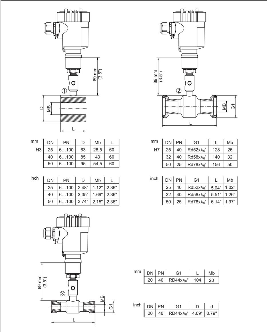
Abb. 54: VEGABAR 81, Rohrdruckmittler
