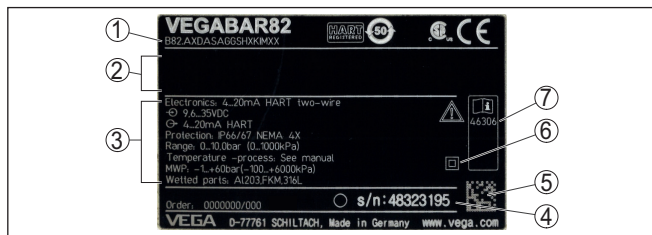
Fig. 1: Opbouw van de typeplaat (voorbeeld)
