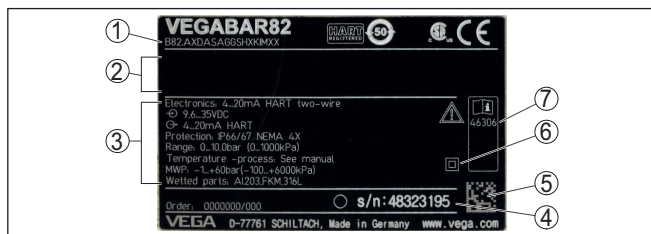
Abb. 1: Aufbau des Typschildes (Beispiel)
