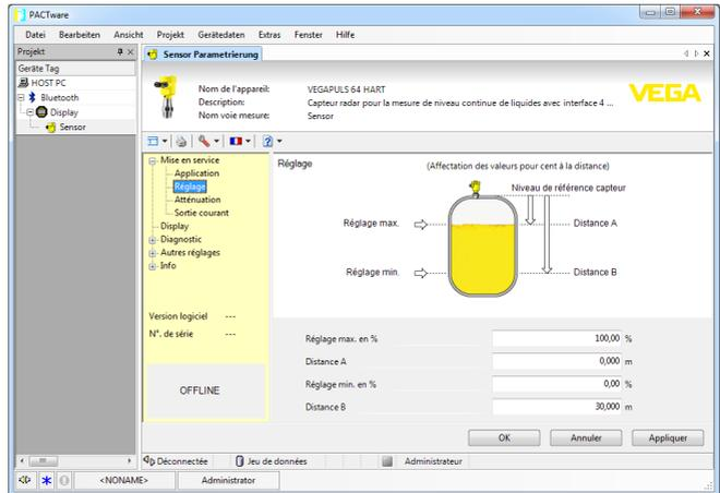
Fig. 31: Exemple de masque DTM
