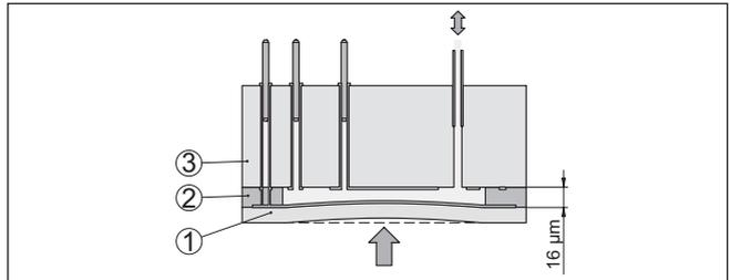
Fig. 2: Structure de la cellule de mesure CERTEC®
