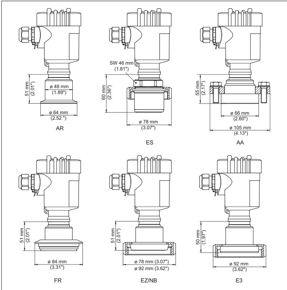
Fig. 45: VEGABAR 82, raccord aseptique
