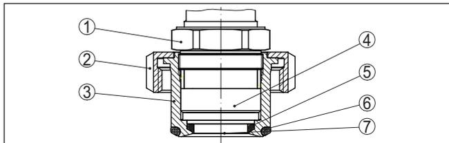
Fig. 32: VEGABAR 82, structure du raccordement hygiénique avec écrou flottant à encoche
