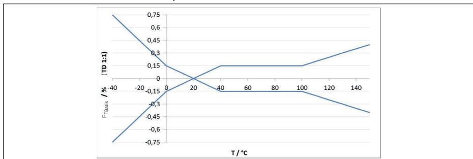
Fig. 35: Erreur de température de base  $F_{T_{Basis}}$  avec TD 1 : 1
