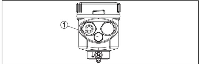
Fig. 13: Position de l'élément filtre - version IP69K
