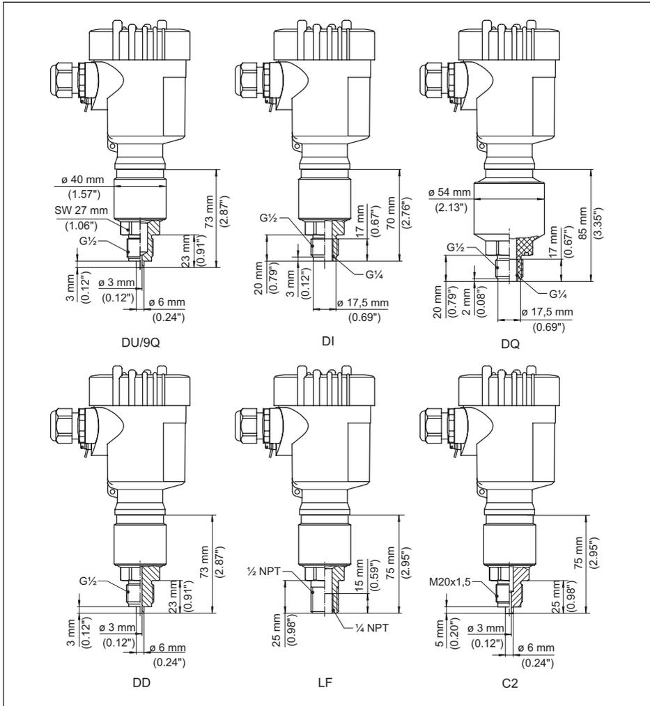
Fig. 42: VEGABAR 82, raccord fileté non arasant
