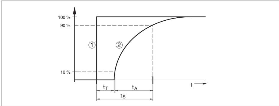
Fig. 34: Comportement en cas de variation brusque de la grandeur process.  $t_T$  : temps mort ;  $t_A$  : temps de montée ;  $t_S$  : temps de réponse impulsionnelle
