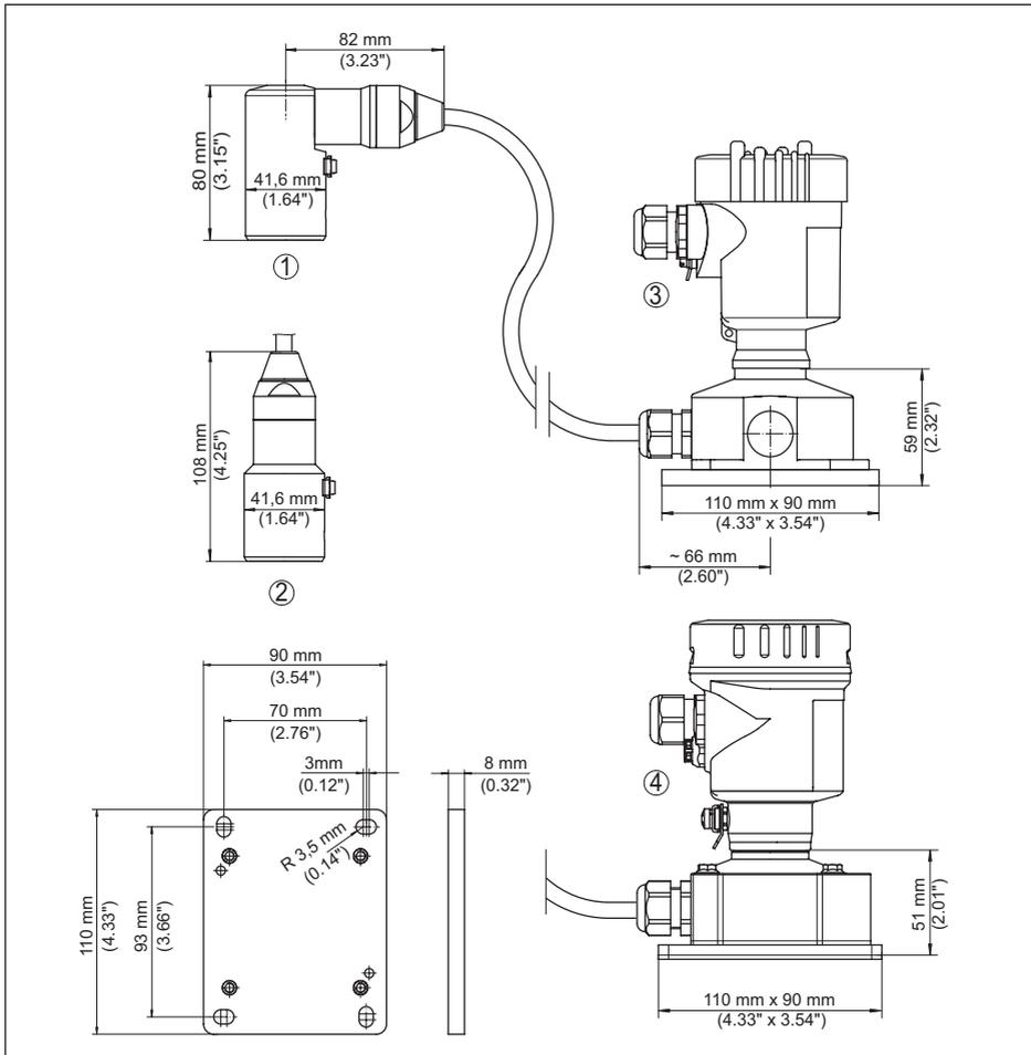
Fig. 41: VEGABAR 82, version IP68 avec boîtier externe
