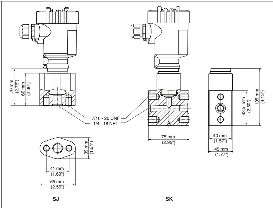
Fig. 49: VEGABAR 82, raccordement selon CEI 61518
