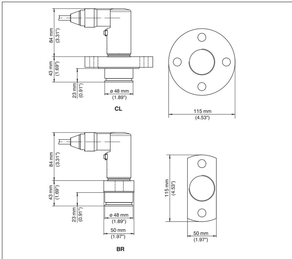
*Fig. 48: VEGABAR 82 - Raccord à bride pour l'industrie papetière : CL = 100 % arasant pour caisse de tête, BR = 100 % arasant pour caisse de tête (bride aplatie des deux côtés)*
