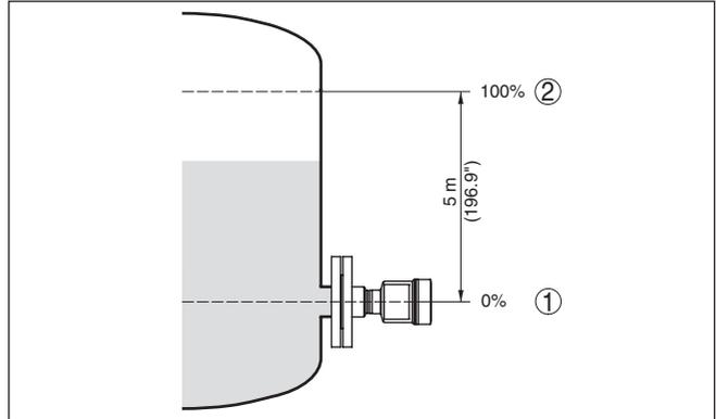
Fig. 29: Exemple de paramétrage réglage min./max. mesure de niveau
