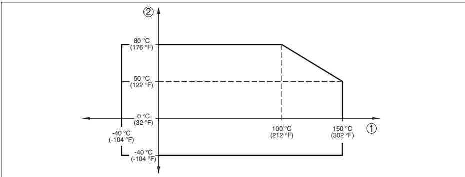
Fig. 38: Derating de température VEGABAR 82, version jusqu'à +150 °C (+302 °F)
