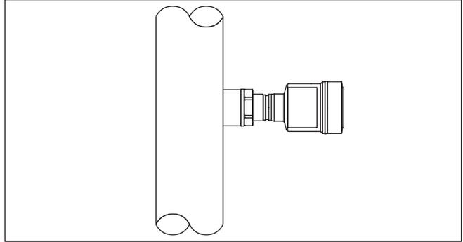
Fig. 1: Mesure de pression process avec VEGABAR 82
