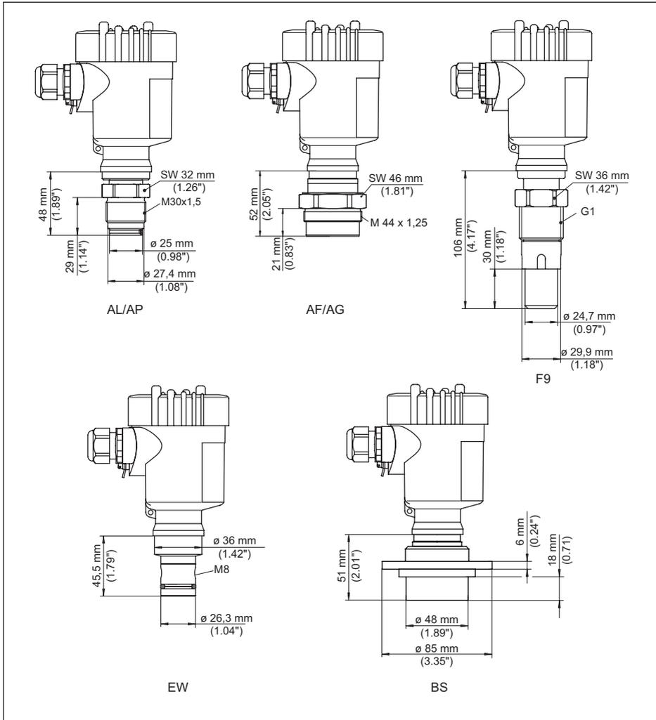
Fig. 47: VEGABAR 82, raccord à tube
