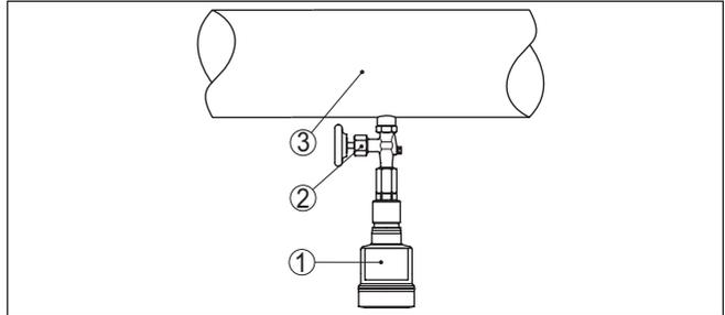
Fig. 16: Mise en œuvre pour la mesure de pression process de liquides dans des conduites
