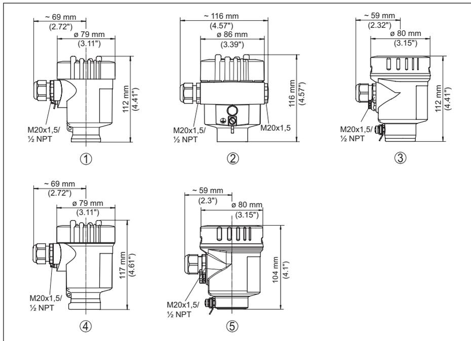
Fig. 40: Variantes de boîtier en protection IP66/IP67 et IP66/IP68 (0,2 bar), (avec un module de réglage et d'affichage intégré, la hauteur du boîtier augmente de 9 mm/0.35 in ou 18 mm/0.71 in)
