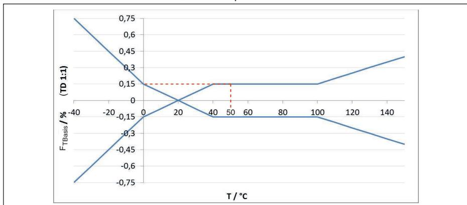
Fig. 39: Détermination de l'erreur de température de base pour l'exemple ci-dessus :  $F_{TBase} = 0,15\%$
