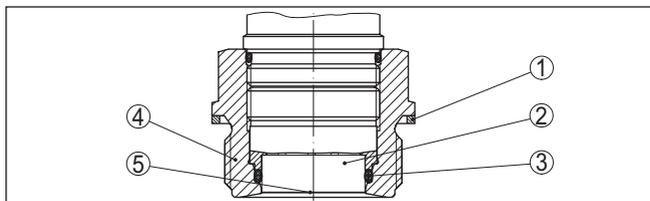
Fig. 4: Montage arasant de la cellule de mesure (exemple : filetage G $\frac{1}{2}$ )
