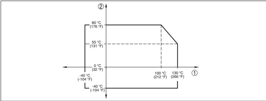
Fig. 37: Derating de température VEGABAR 82, version jusqu'à +130 °C (+266 °F)
