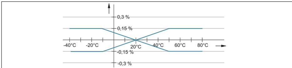
Fig. 36: Variation thermique sortie courant
