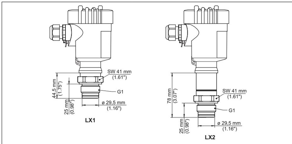
Fig. 44: VEGABAR 82, filetage pour adaptateur hygiénique
