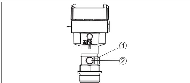
Fig. 11: Position de l'élément filtre - version Ex d
