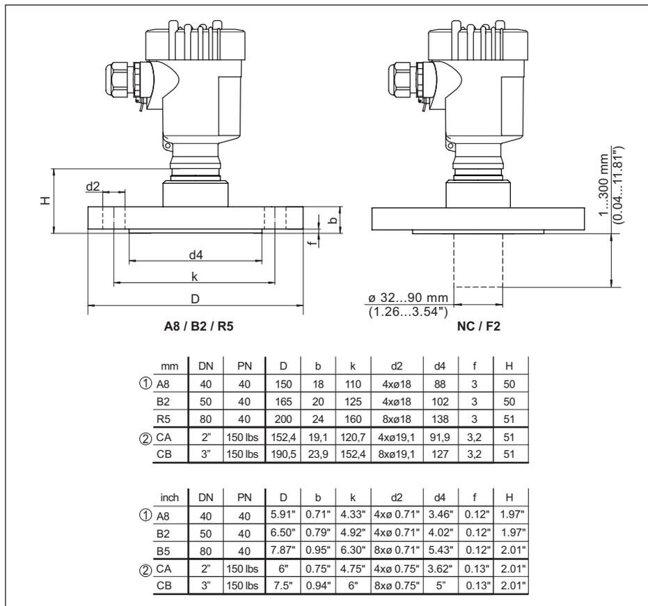
Fig. 46: VEGABAR 82, raccord à bride
