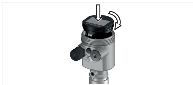
Fig. 26: Empleo del módulo de visualización y configuración en carcasa de una sola cámara el compartimiento de conexión
