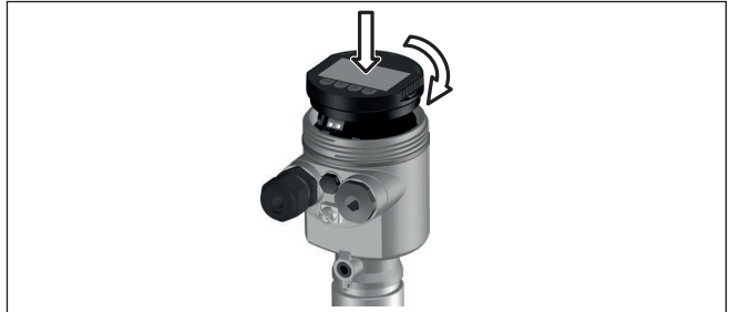
Rys. 26: Wkładanie modułu wyświetlającego i obsługowego do komory układu elektronicznego w obudowie jednokomorowej
