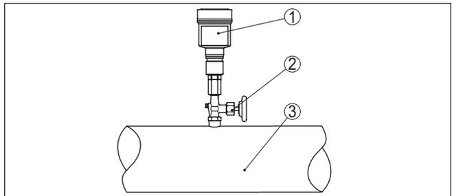
Abb. 15: Messanordnung bei Prozessdruckmessung von Gasen in Rohrleitungen
