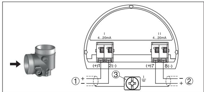
Abb. 23: Anschlussraum Zweikammergehäuse, Zusatzelektronik - Zusätzlicher Stromausgang
