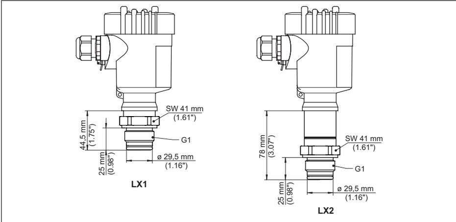
Abb. 59: VEGABAR 82, Gewinde für Hygieneadapter
