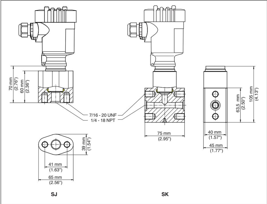
Abb. 64: VEGABAR 82, Anschluss nach IEC 61518
