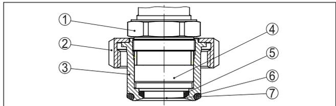
Abb. 41: VEGABAR 82, Aufbau aseptischer Anschluss mit Nutüberwurfmutter
