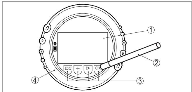
Abb. 36: Anzeige- und Bedienelemente - mit Bedienung über Magnetstift
