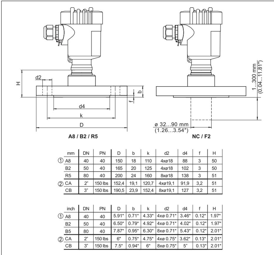
Abb. 61: VEGABAR 82, Flanschanschluss
