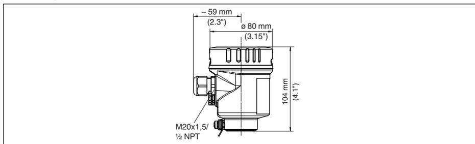
Abb. 55: Gehäuseausführung in Schutzart IP69K (mit eingebautem Anzeige- und Bedienmodul vergrößert sich die Gehäusehöhe um 9 mm/0.35 in)
