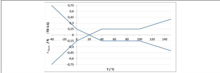
Abb. 45: Basis-Temperaturfehler  $F_{TBasis}$  bei TD 1 : 1
