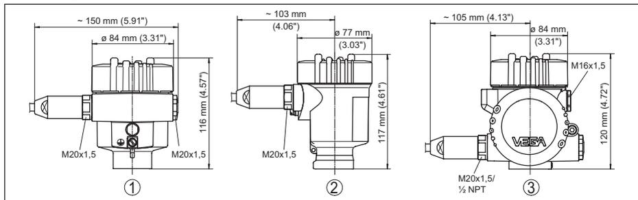
Abb. 54: Gehäuseausführungen in Schutzart IP66/IP68 (1 bar), (mit eingebautem Anzeige- und Bedienmodul vergrößert sich die Gehäusehöhe um 9 mm/0.35 in bzw. 18 mm/0.71 in)
