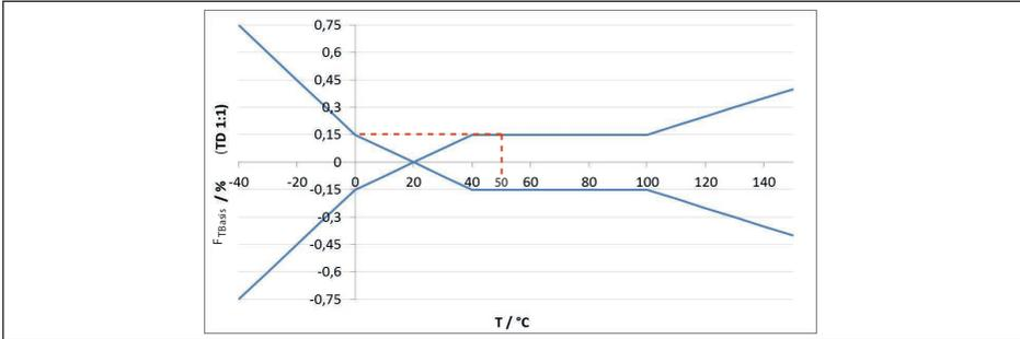
Abb. 49: Ermittlung des Basis-Temperaturfehlers für das Beispiel oben:  $F_{TBasis} = 0,15\%$
