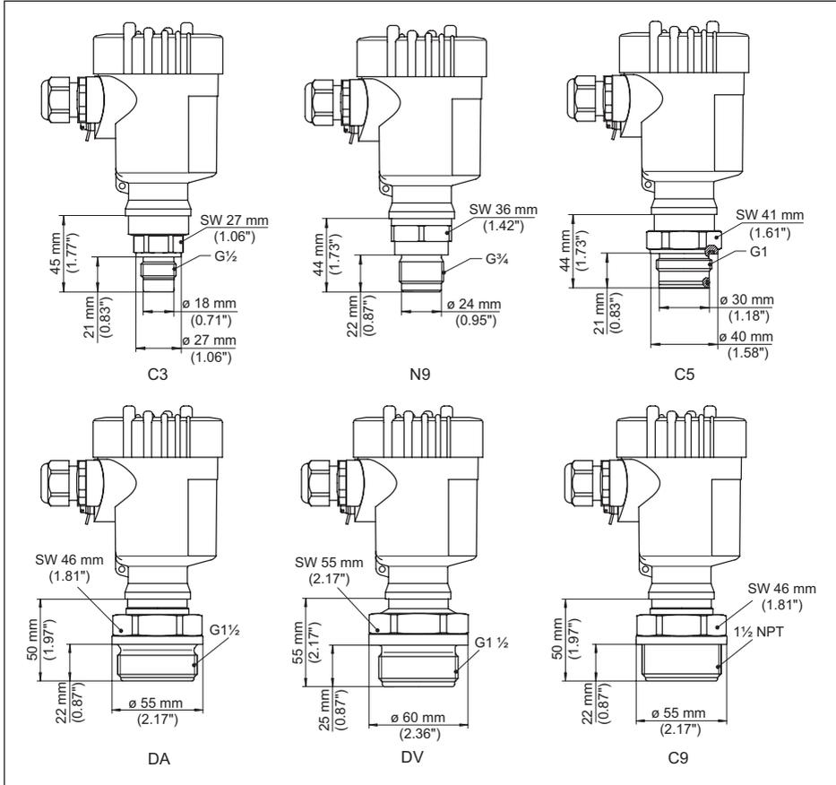
Abb. 58: VEGABAR 82, Gewindeanschluss frontbündig
