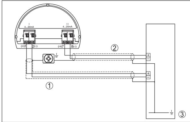
Abb. 32: Anschlussbeispiel VEGABAR 82 zu zusätzlicher Stromausgang
