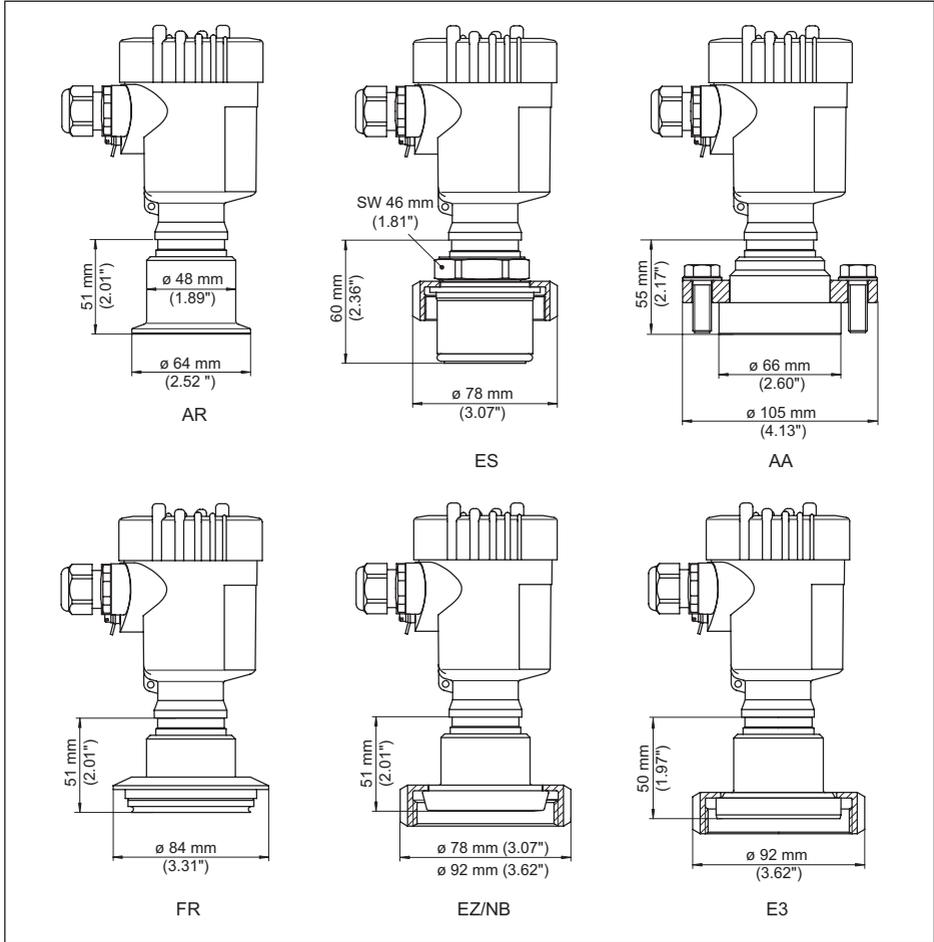
Abb. 60: VEGABAR 82, Hygieneanschluss
