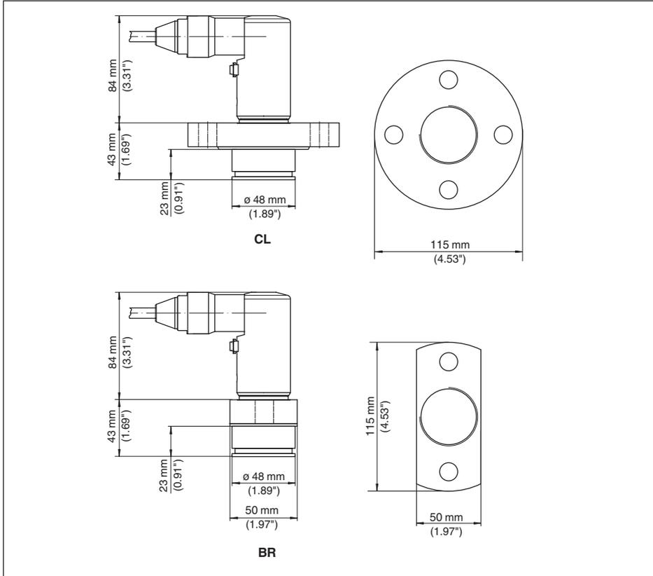
Abb. 63: VEGABAR 82, Tubusanschluss für Stoffauflauf
