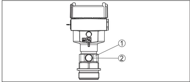
Abb. 12: Position des Filterelementes - Ex d-Ausführung
