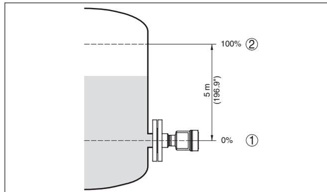
Abb. 37: Parametrierbeispiel Min./Max.-Abgleich Füllstandmessung
