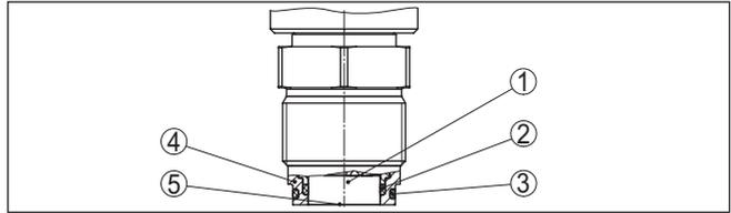
Abb. 6: Frontbündiger Einbau der Messzelle (Beispiel: M30 x 1,5)
