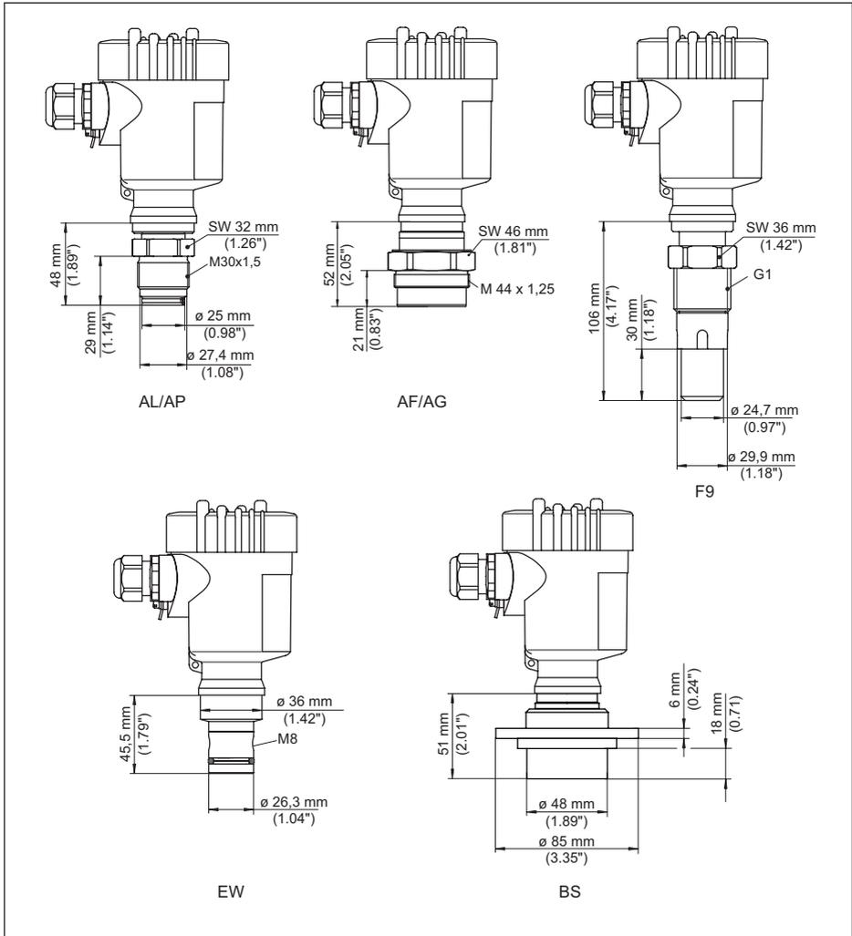
Abb. 62: VEGABAR 82, Tubusanschluss
