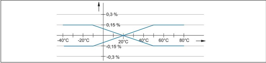
Abb. 46: Thermische Änderung Stromausgang
