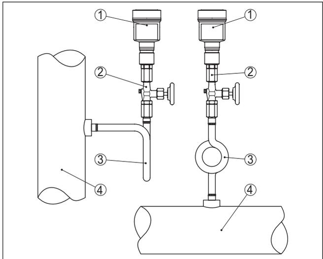
Fig. 16: Configuración de medición para la medición de presión de proceso de vapores en tuberías
