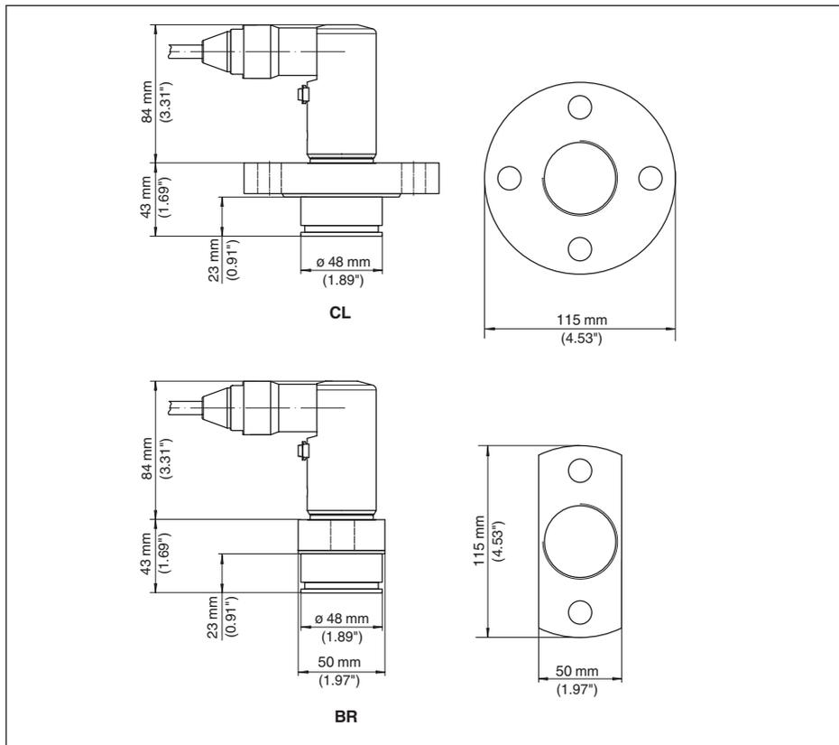
Fig. 62: VEGABAR 82, conexión tubular para alimentación de pasta
