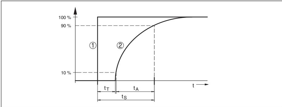
Fig. 41: Comportamiento con variación brusca de las variables de proceso.  $t_T$ : tiempo muerto;  $t_A$ : tiempo de subida;  $t_S$ : tiempo de respuesta gradual
