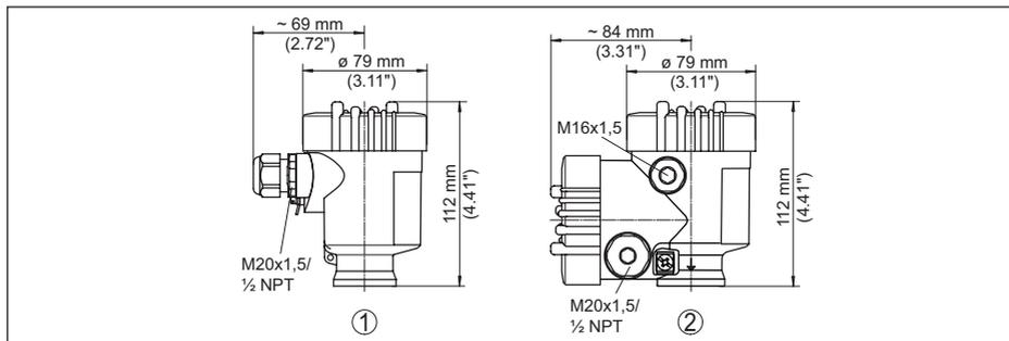
Fig. 49: Variantes de carcasa en grado de protección IP66/IP67; 1 bar (con módulo de visualización y configuración integrado aumenta la altura de la carcasa en 9 mm/0.35 in)
