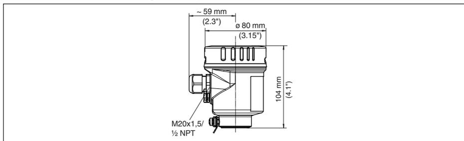
Fig. 54: Versión de carcasa en grado de protección IP69K (con módulo de visualización y configuración integrado aumenta la altura de la carcasa en 9 mm/0.35 in)
