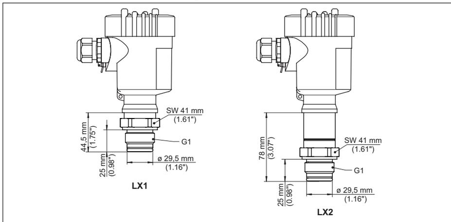
Fig. 58: VEGABAR 82, rosca para adaptador higiénico
