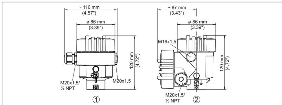
Fig. 50: Variantes de carcasa con tipo de protección IP66/IP68 (0,2 bar), (con el módulo de visualización y configuración montado aumenta la altura de la carcasa en 18 mm/0.71 in)
