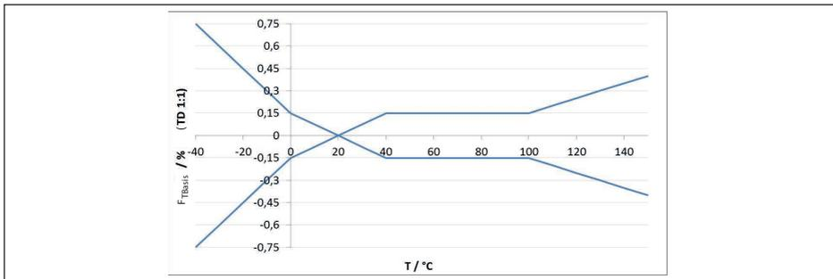
Fig. 42: Error de temperatura básico  $F_{TBasic}$  con TD 1 : 1
