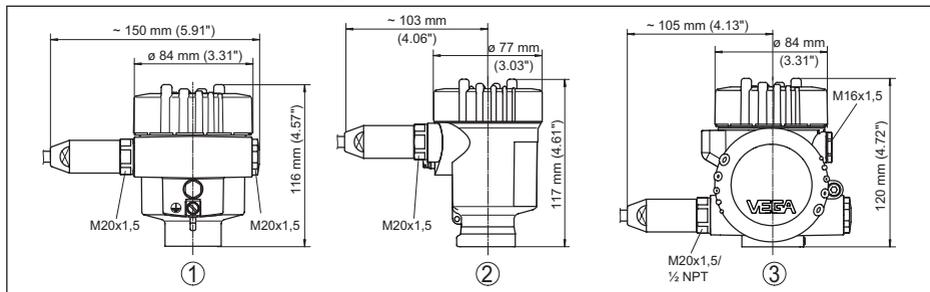
Fig. 53: Variantes de carcasa con tipo de protección IP66/IP68 (1 bar), (con el módulo de visualización y configuración montado aumenta la altura de la carcasa en 9 mm/0.35 in o 18 mm/0.71 in)
