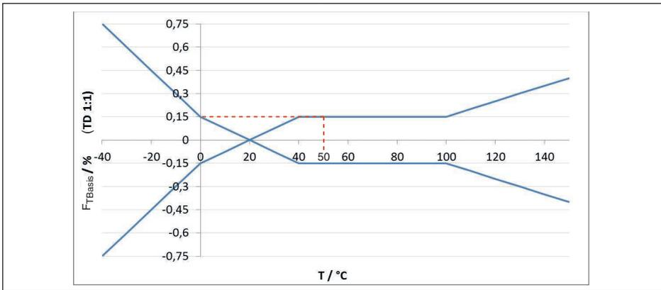
Fig. 48: Determinación del error de temperatura básico para el ejemplo anterior:  $F_{\text{TBasis}} = 0,15 \%$
