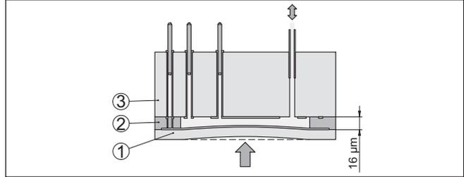
Fig. 3: Estructura de la celda de medición CERTEC®
