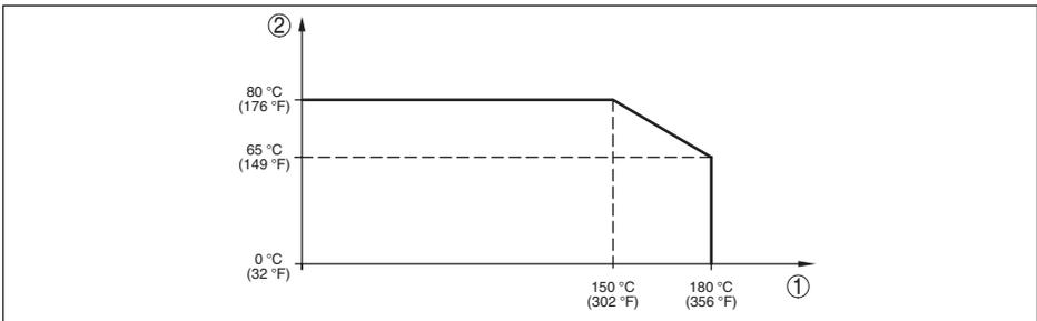
Abb. 37: Temperaturderating VEGABAR 83, Ausführung bis +180 °C (+356 °F)
