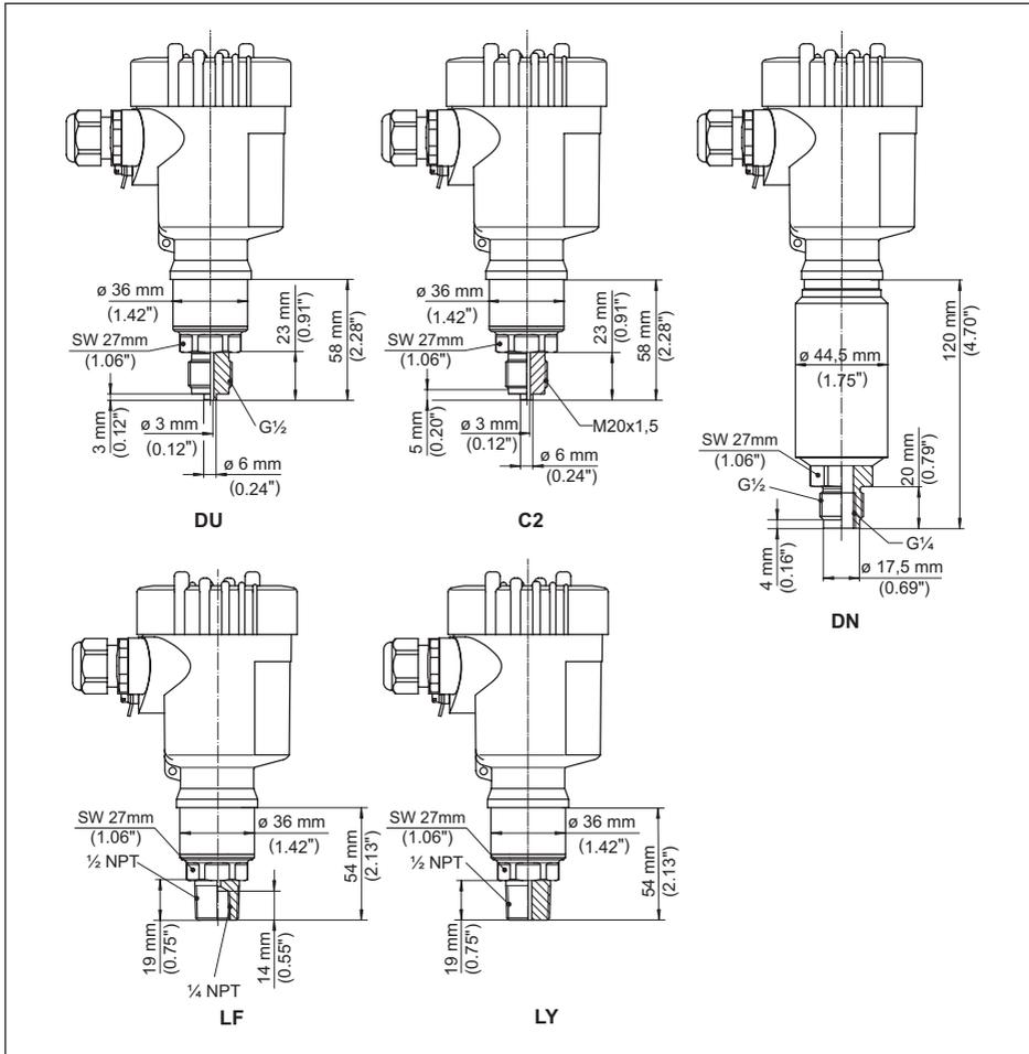
Abb. 42: VEGABAR 83, Gewindeanschluss nicht frontbündig
