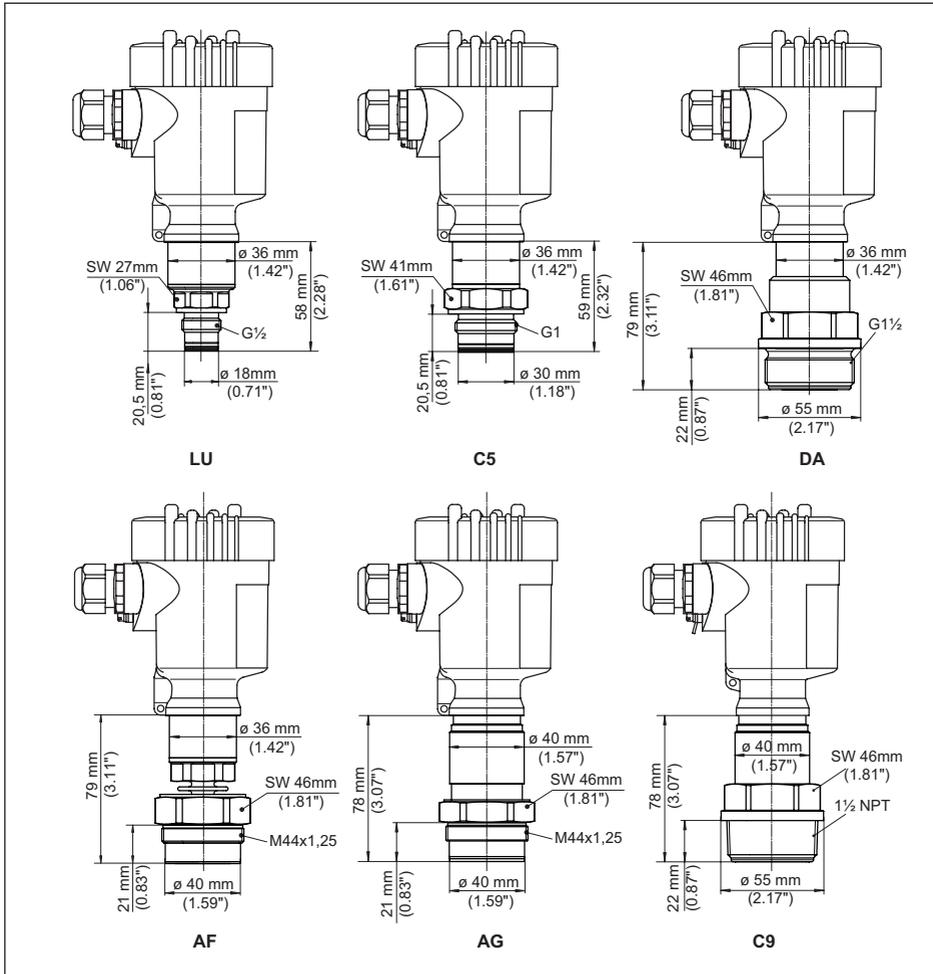
Abb. 43: VEGABAR 83, Gewindeanschluss frontbündig
