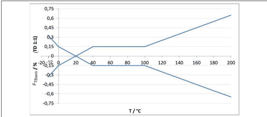
Abb. 32: Basis-Temperaturfehler  $F_{TBasis}$  bei TD 1 : 1
