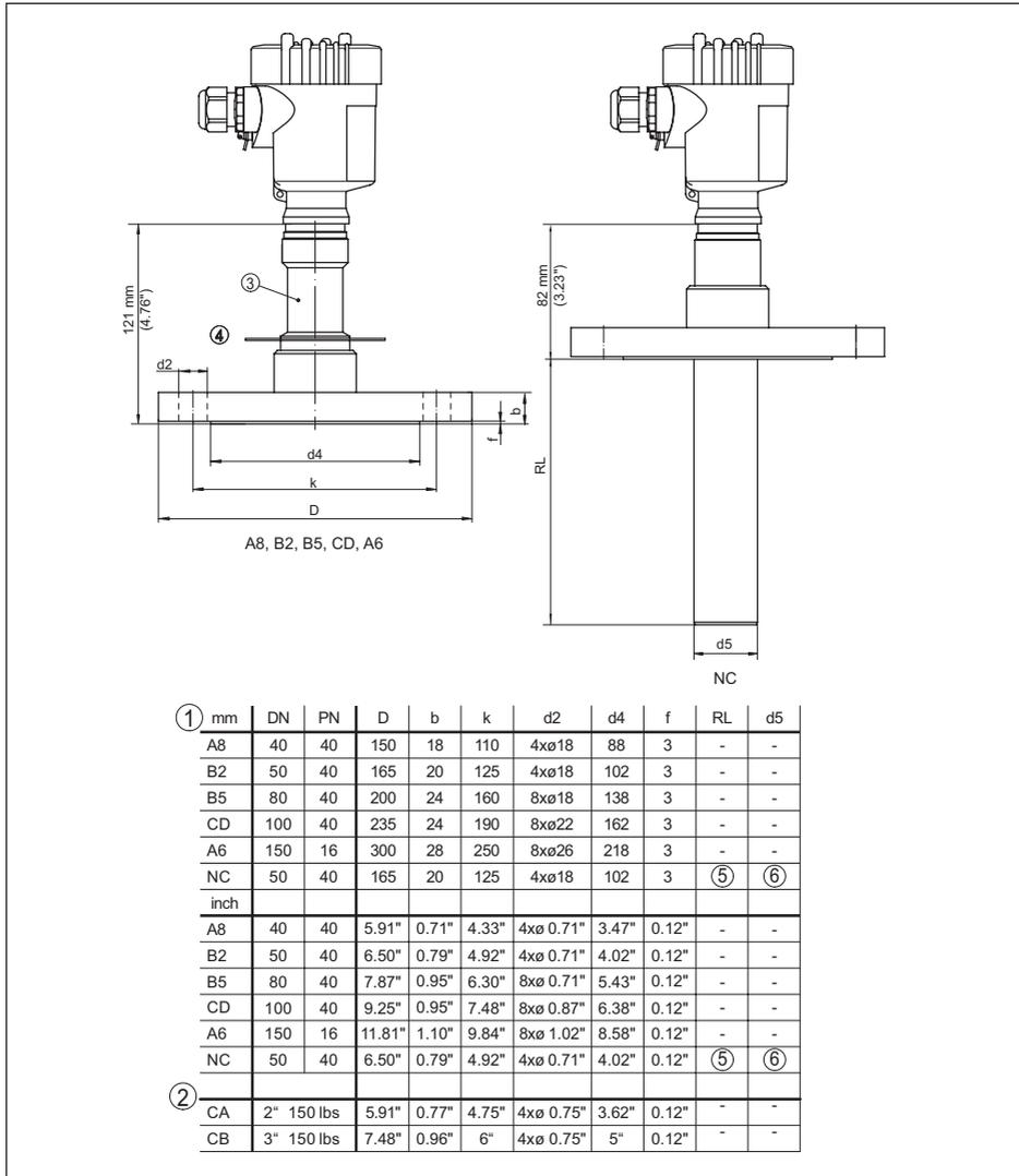
Abb. 47: VEGABAR 83, Flanschanschluss 180 °C/200 °C (METEC®-Messzelle)
