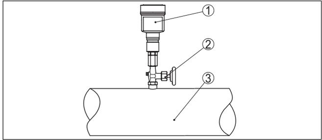
Abb. 12: Messanordnung bei Prozessdruckmessung von Gasen in Rohrleitungen
