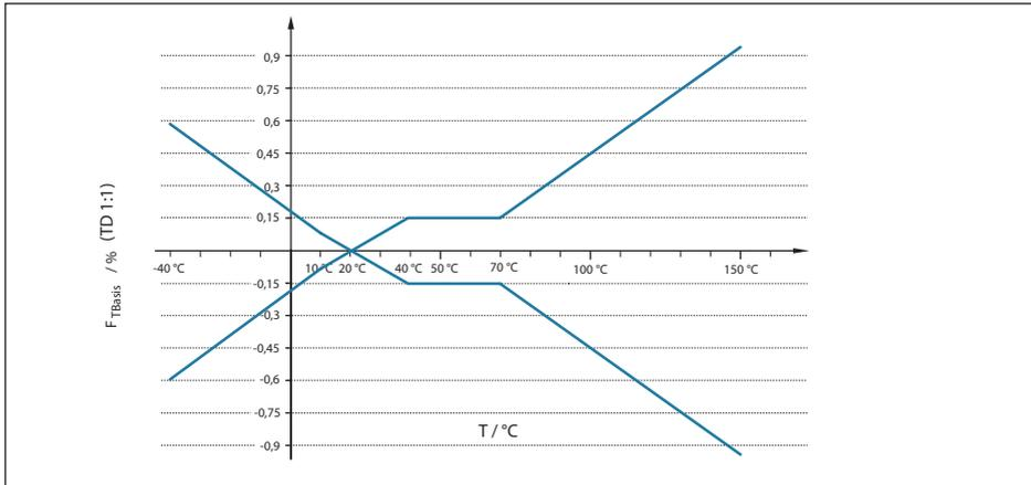
Abb. 31: Basis-Temperaturfehler  $F_{T\text{Basis}}$  bei TD 1 : 1
