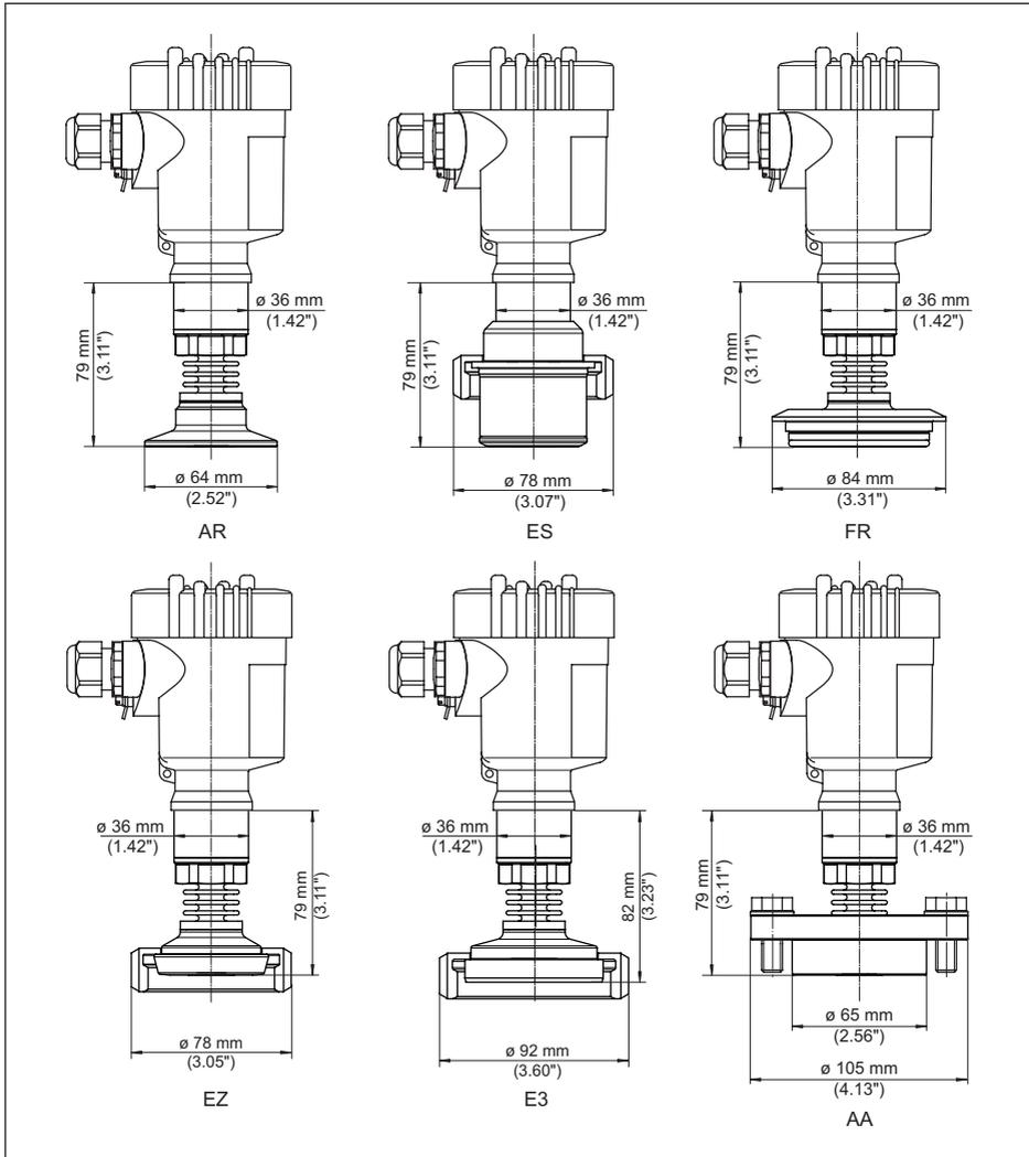
Abb. 44: VEGABAR 83, Hygieneanschluss 150 °C (piezoresistive-/DMS-Messzelle)
