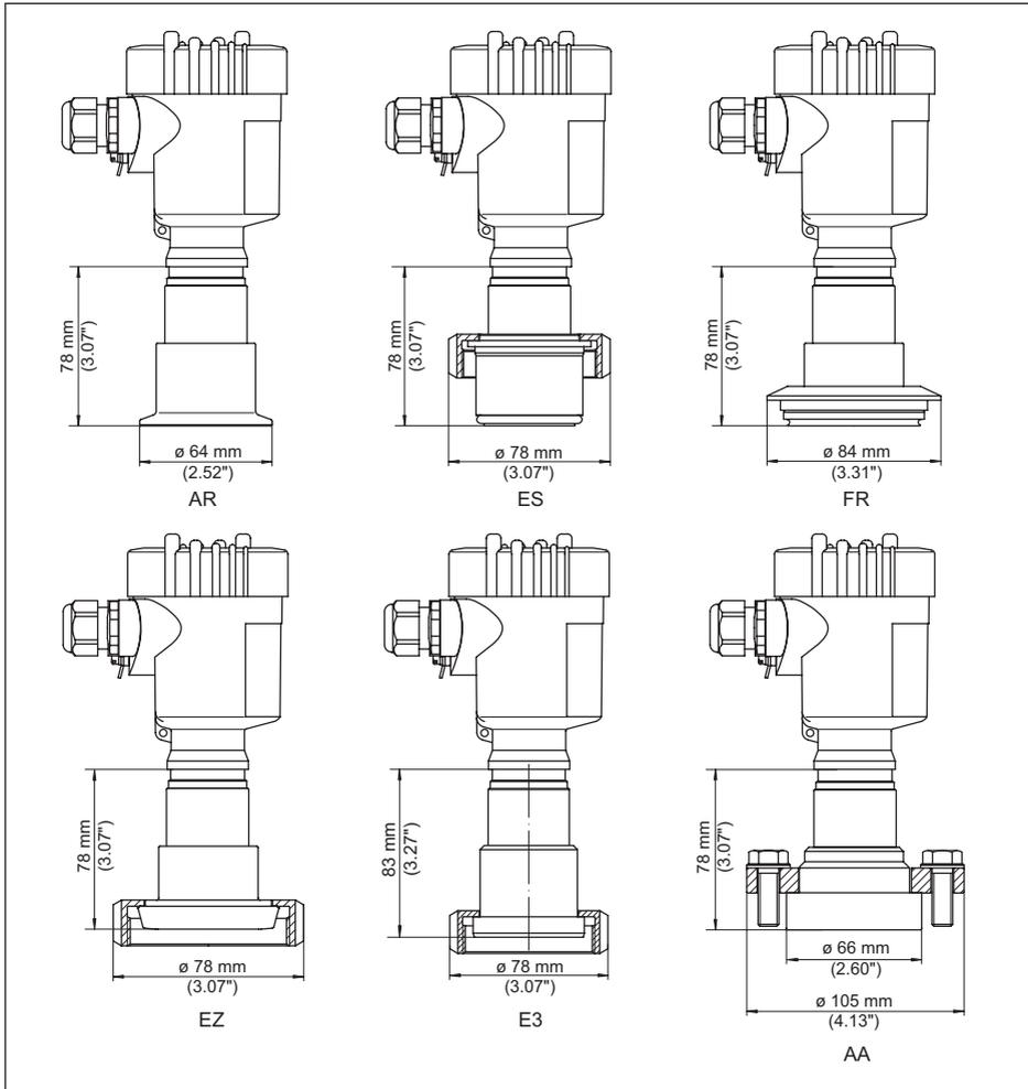
Abb. 45: VEGABAR 83, Hygieneanschluss 150 °C (METEC®-Messzelle)
