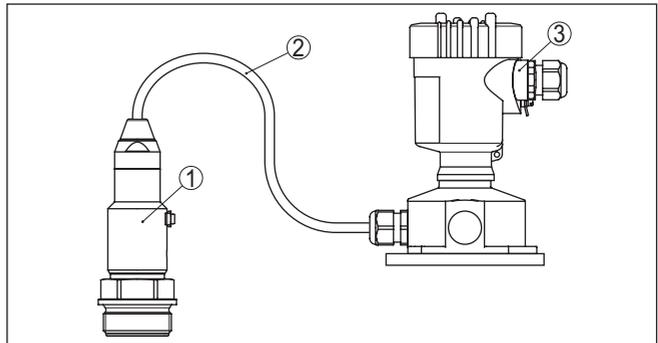
Abb. 20: VEGABAR 83 in IP68-Ausführung 25 bar mit axialem Kabelabgang, externes Gehäuse
