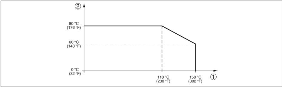
Abb. 36: Temperaturderating VEGABAR 83, Ausführung bis +150 °C (+302 °F)
