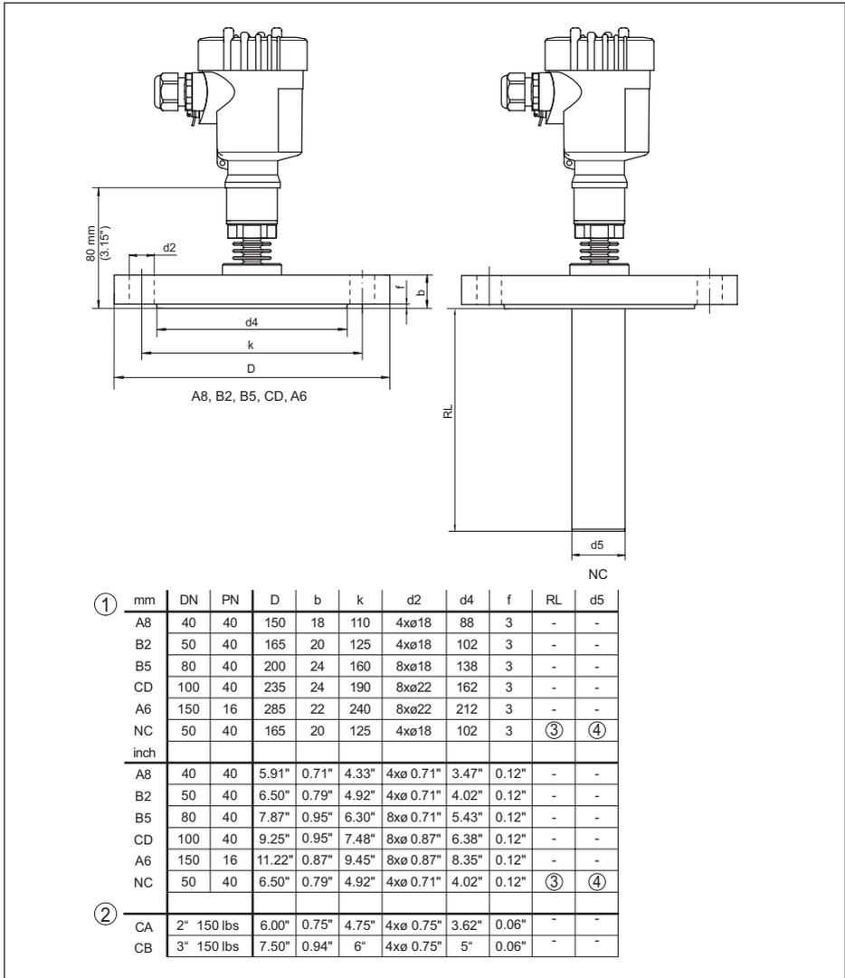
Abb. 46: VEGABAR 83, Flanschsanschluss 150 °C (piezoresistive-/DMS-Messzelle)
