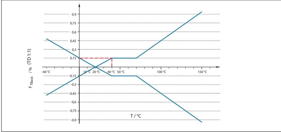
Abb. 39: Ermittlung des Basis-Temperaturfehlers für das Beispiel oben:  $F_{TBasis} = \mathbf{0,15 \%}$
