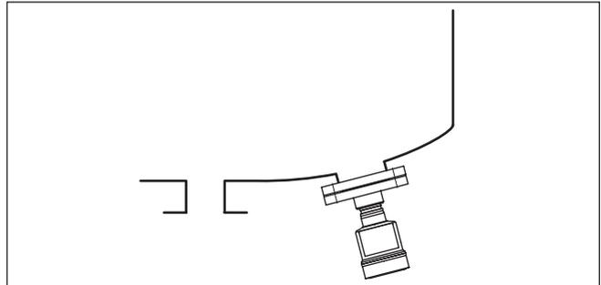
Abb. 15: Messanordnung bei der Füllstandmessung
