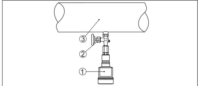
Abb. 14: Messanordnung bei der Prozessdruckmessung von Flüssigkeiten in Rohrleitungen
