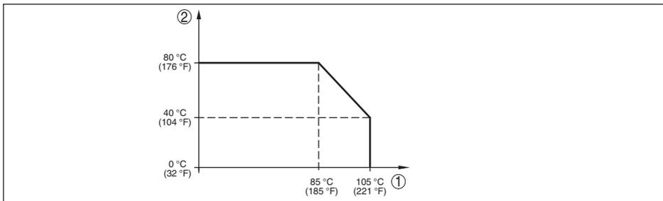
Abb. 34: Temperaturderating VEGABAR 83, Ausführung bis +105 °C (+221 °F)
