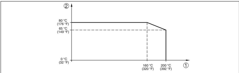
Abb. 38: Temperaturderating VEGABAR 83, Ausführung bis +200 °C (+392 °F)
