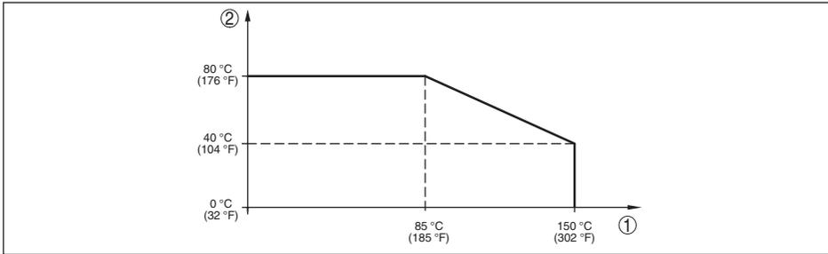
Abb. 35: Temperaturderating VEGABAR 83, Ausführung bis +150 °C (+302 °F)
