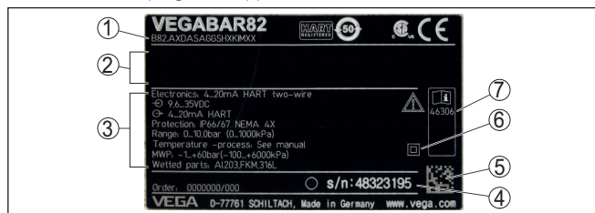
Figura 1: Struttura della targhetta d'identificazione (esempio)
