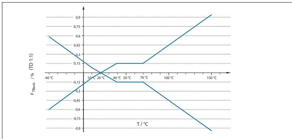
Figura 34: Errore di temperatura base  $F_{TBasis}$  con TD 1 : 1
