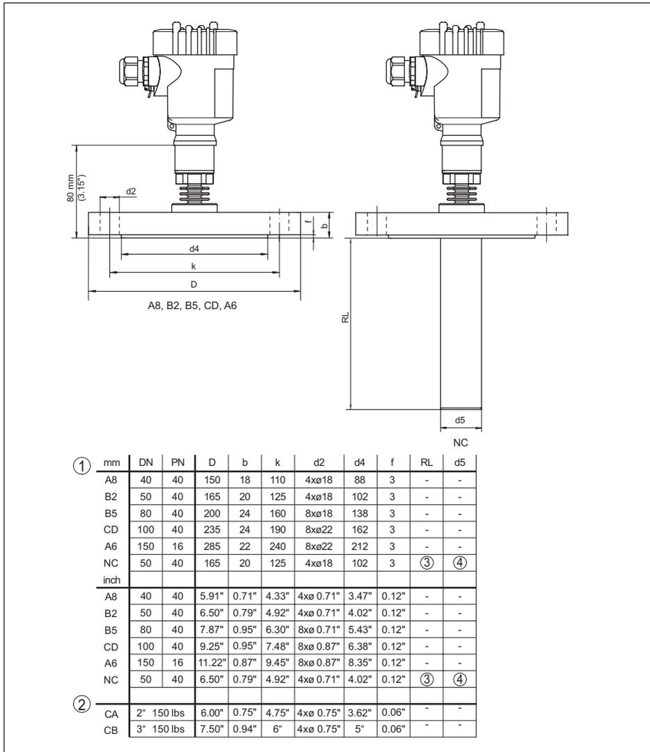
Figura 49: VEGABAR 83, attacco a flangia 150 °C (cella di misura piezoresistiva/DMS)
