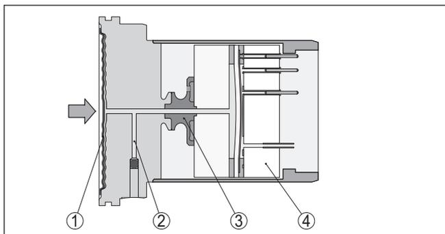
Figura 6: Struttura della cella di misura METEC®
