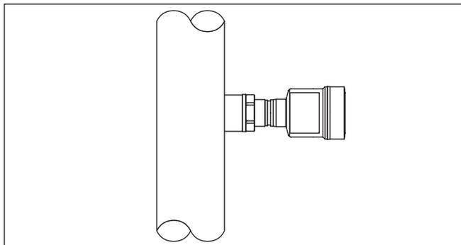
Figura 2: Misura della pressione di processo con VEGABAR 83
