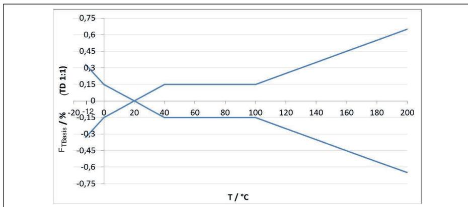
Figura 35: Errore di temperatura base  $F_{T-Basis}$  con TD 1 : 1
