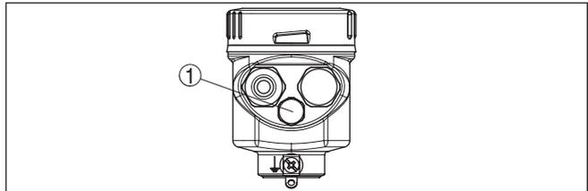
Figura 11: Posizione del filtro - esecuzione IP69K
