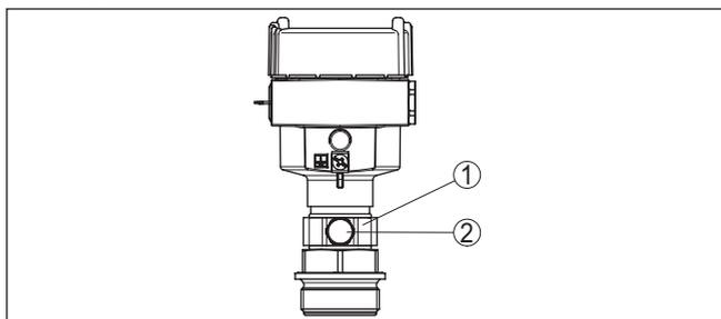
Figura 9: Posizione del filtro - esecuzione Ex-d
