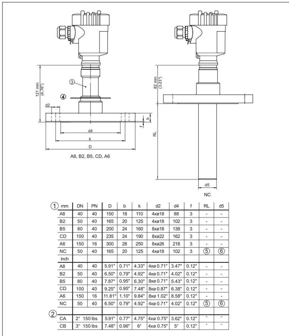
Figura 50: VEGABAR 83, attacco a falgia 180 °C/200 °C (cella di misura METEC®)
