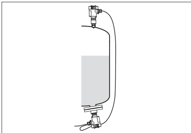
Figura 3: Misura di pressione differenziale elettronica tramite combinazione master/slave
