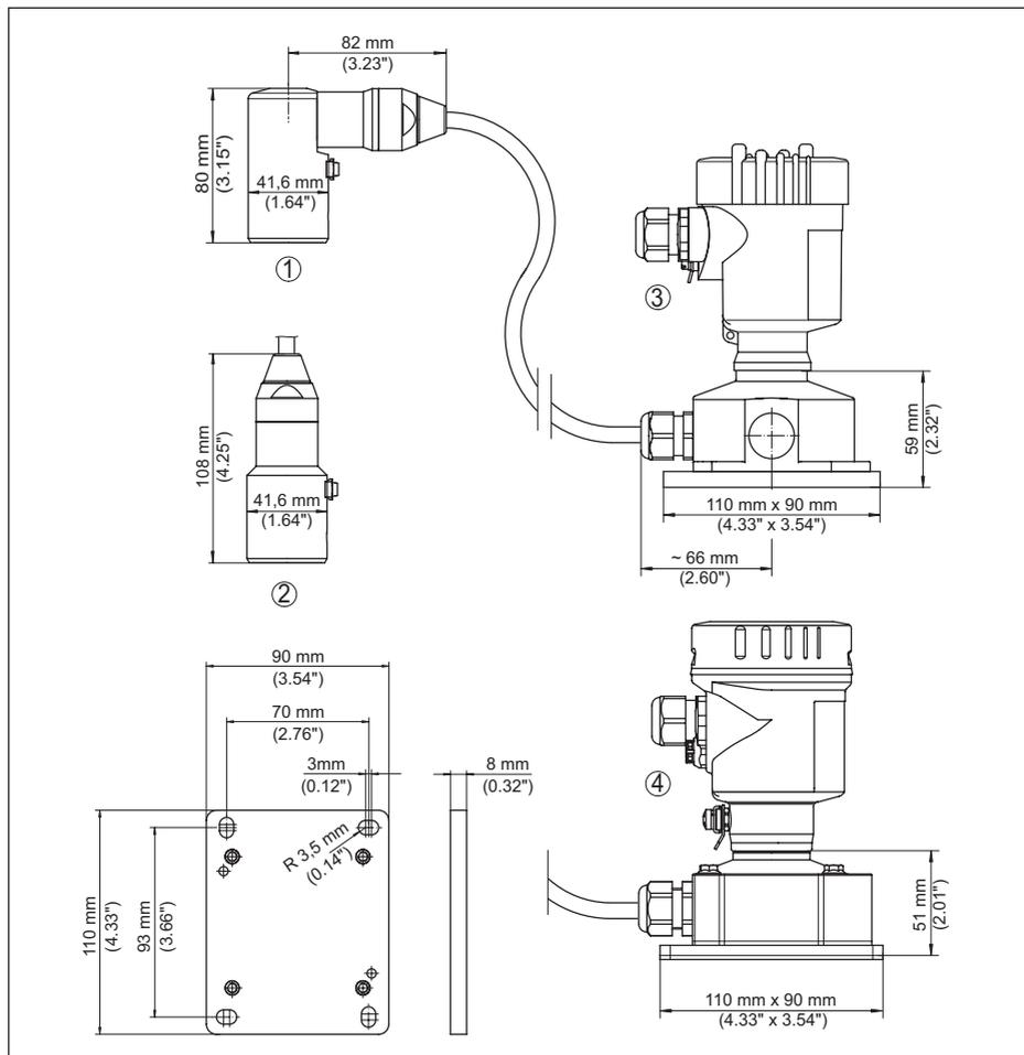
Figura 44: VEGABAR 83, esecuzione IP68 con custodia esterna
