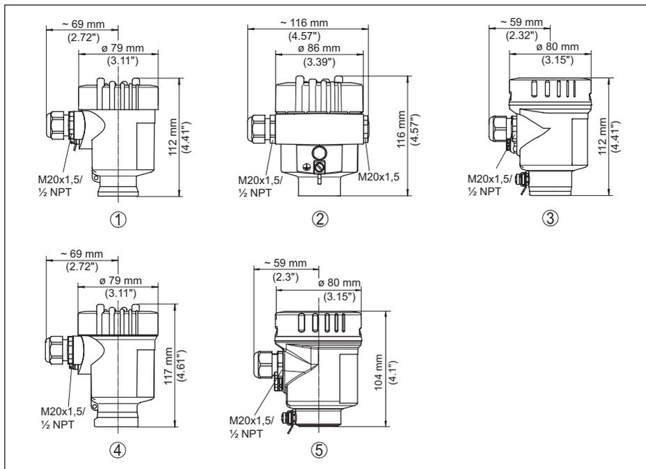
Figura 43: Differenti custodie con grado di protezione IP66/IP67 e IP66/IP68 (0,2 bar), (con tastierino di taratura con display incorporato l'altezza della custodia aumenta di 9 mm/0.35 in ovv. 18 mm/0.71 in)
