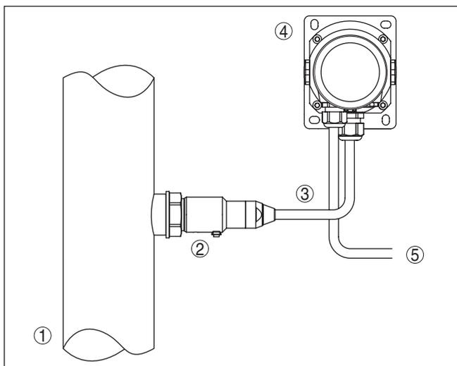
Figura 16: Disposizione dell'unità di processo, custodia esterna
