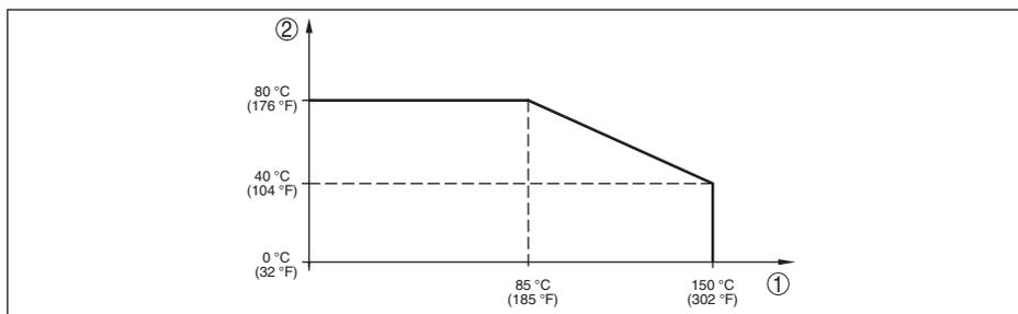
Figura 38: Derating di temperatura VEGABAR 83, esecuzione fino a +150 °C (+302 °F)
