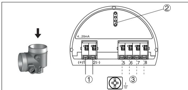
Figura 19: Vano dell'elettronica - custodia a due camere Ex-d-ia
