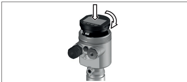
Figura 26: Inserimento del tastierino di taratura con display nel vano dell'elettronica in caso di custodia ad una camera
