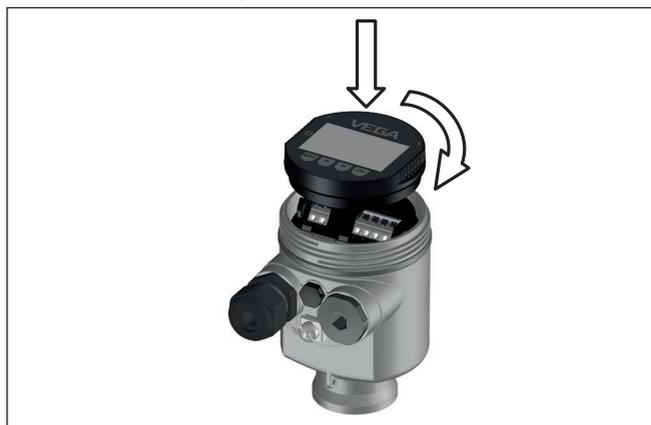
Figura 33: Inserimento del tastierino di taratura con display nel vano dell'elettronica in caso di custodia ad una camera
