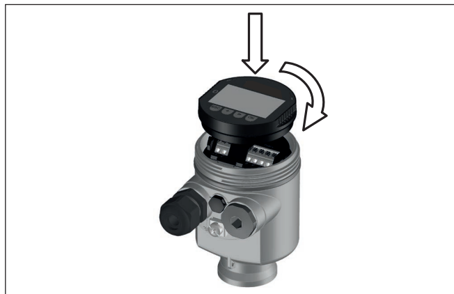
Rys. 32: Wkładanie modułu wyświetlającego i obsługowego do komory układu elektronicznego w obudowie jednokomorowej
