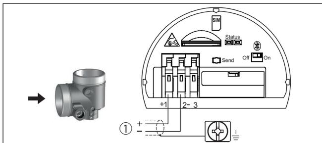
Figura 17: Vano di connessione - modulo radio PLICSMOBILE 81
