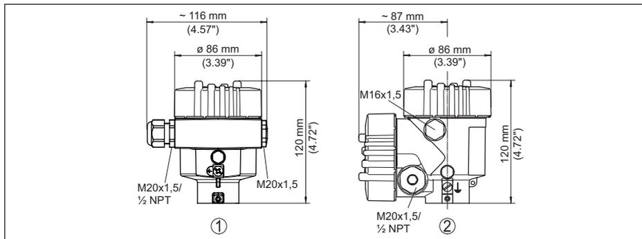
Figura 45: Le differenti custodie con grado di protezione IP66/IP67 (con tastierino di taratura con display incorporato l'altezza della custodia aumenta di 18 mm/0.71 in)
