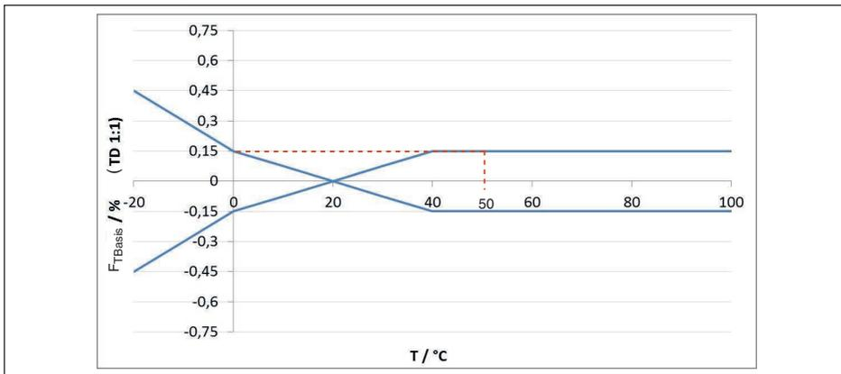
Figura 43: Calcolo dell'errore di temperatura base per il suddetto esempio:  $F_{TBasis} = 0,15\%$
