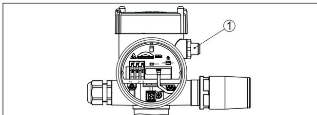
Figura 18: Sensore con modulo radio PLICSMOBILE 81 e connettore M12 x 1
