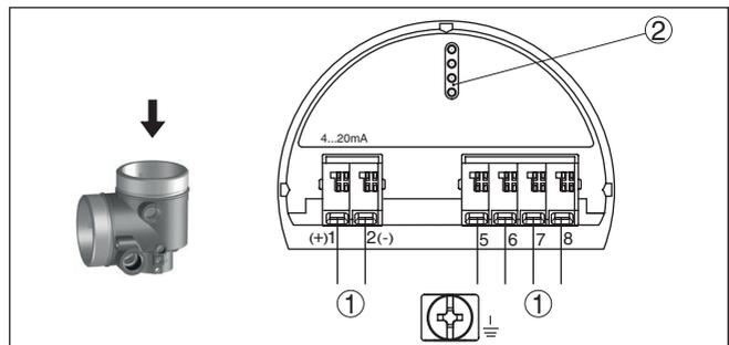
Figura 21: Vano dell'elettronica - custodia a due camere
