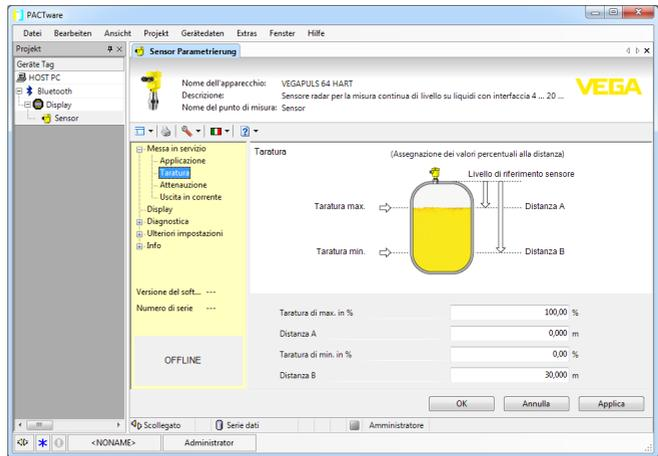
Figura 37: Esempio di una maschera DTM
