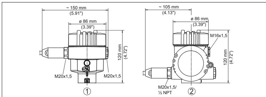
Figura 46: Differenti custodie con grado di protezione IP66/IP68 (1 bar), (con tastierino di taratura con display incorporato l'altezza della custodia aumenta di 18 mm/0.71 in)
