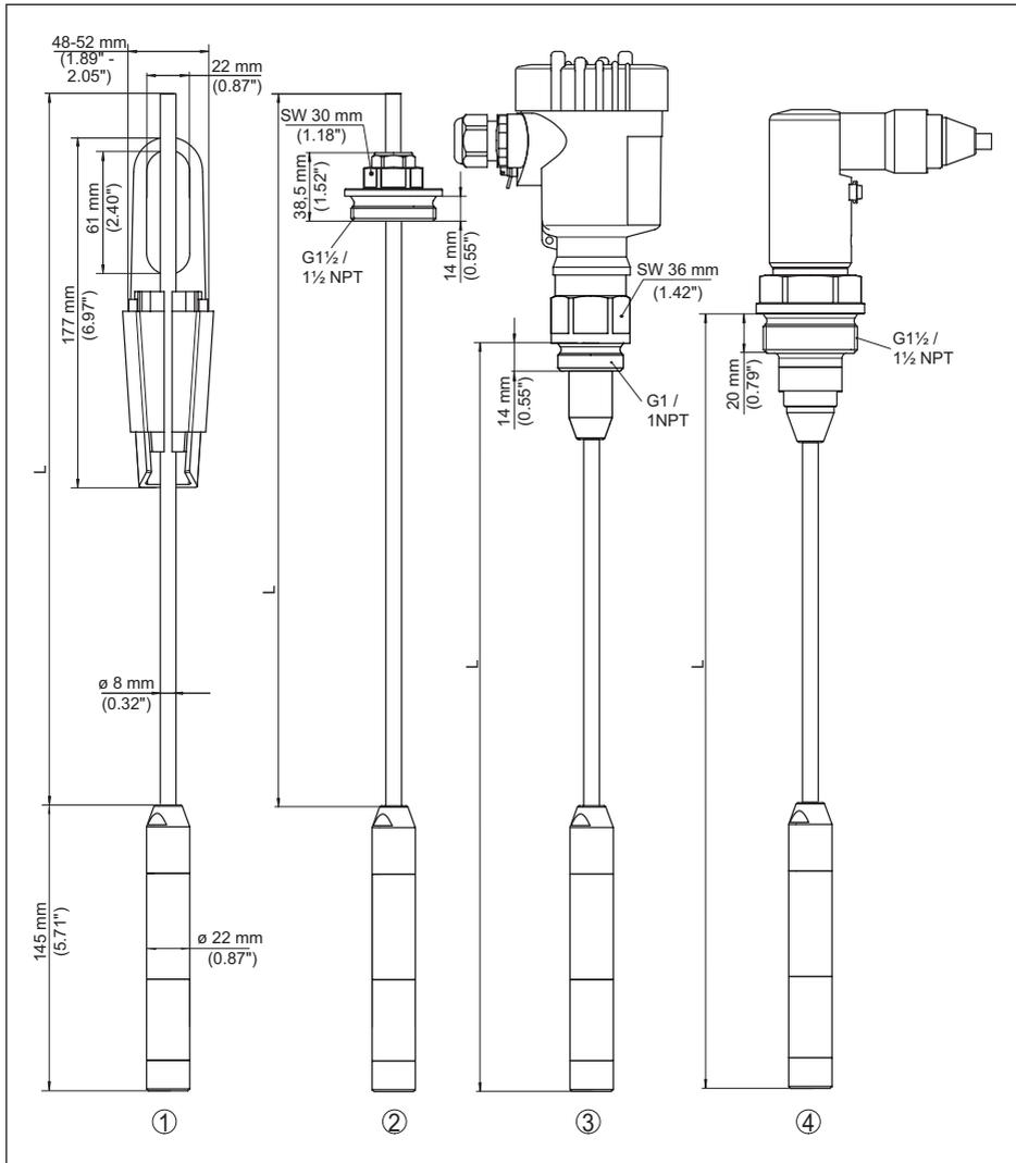
Figura 52: VEGABAR 86, elemento primario di misura 22 mm
