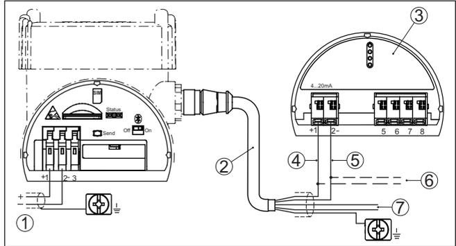
Figura 20: Allacciamento alimentazione in tensione e sensore plics®
