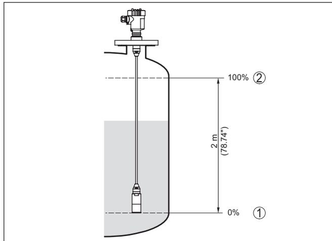
Figura 34: Esempio di parametrizzazione taratura di min./max. per misura di livello
