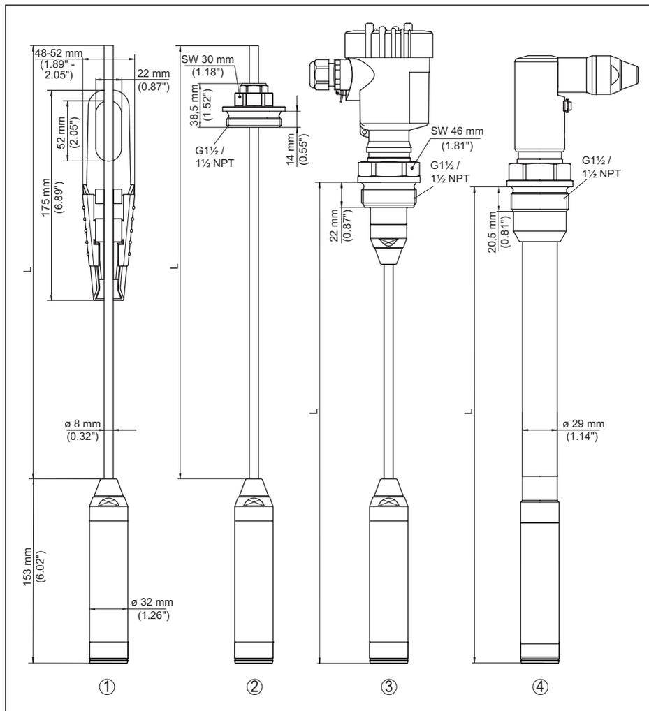
Figura 51: VEGABAR 86, elemento primario di misura 32 mm
