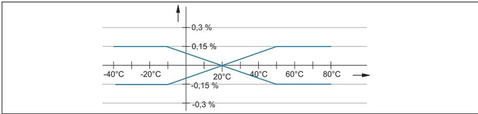
Figura 42: Variazione termica uscita in corrente
