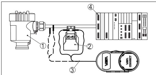
Figura 36: Collegamento del PC via HART alla linea del segnale
