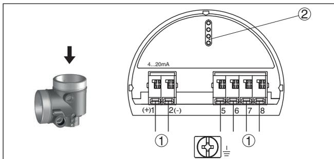
Figura 14: Vano dell'elettronica - custodia a due camere
