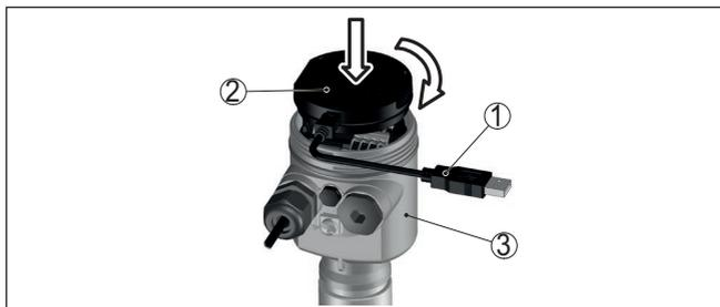
Figura 35: Allacciamento del PC direttamente al sensore tramite adattatore d'interfaccia
