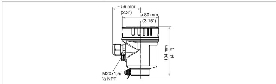
Figura 49: Custodia con grado di protezione IP69K (con tastierino di taratura con display incorporato l'altezza della custodia aumenta di 9 mm/0.35 in)
