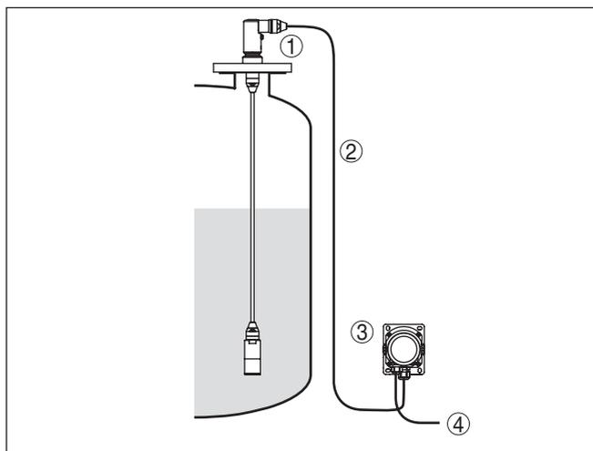
Figura 11: Disposizione punto di misura, custodia esterna
