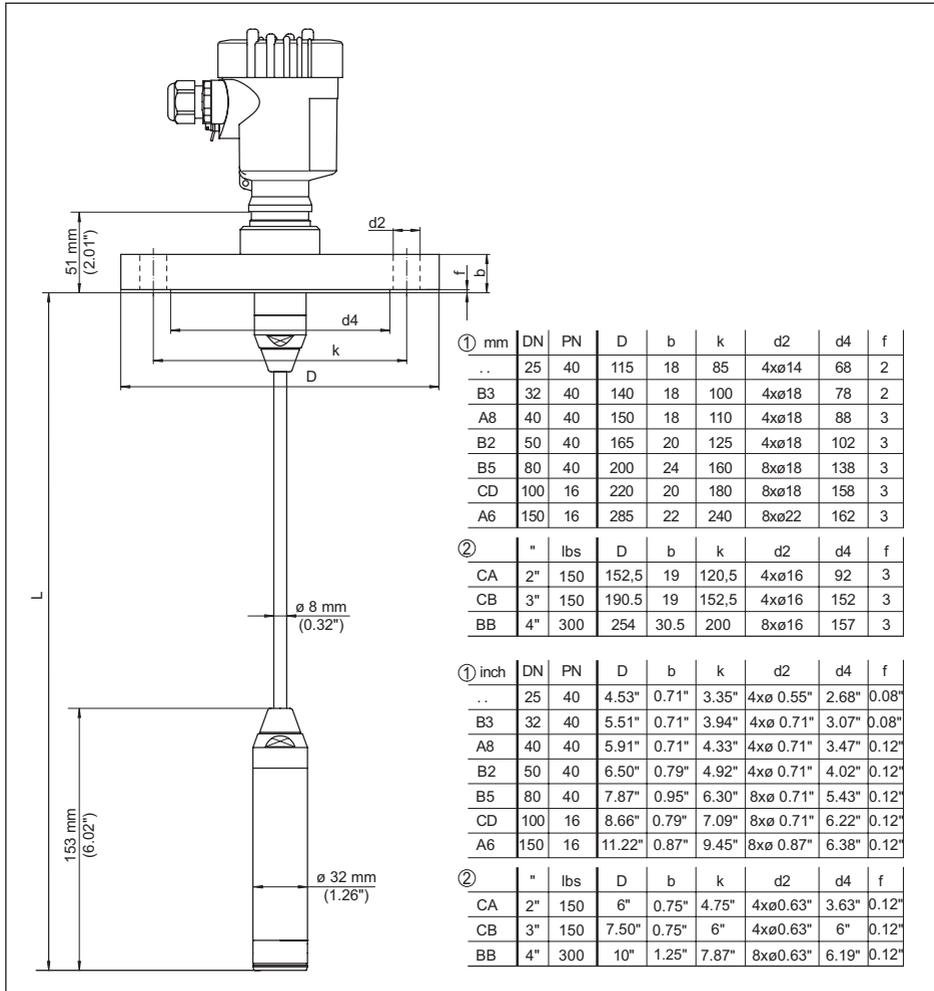
Figura 54: VEGABAR 86, attacco a flangia (esempio: rilevatore del valore di misura 32 mm)
