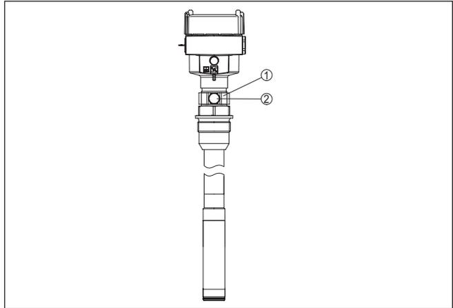
Figura 8: Posizione del filtro - esecuzione Ex-d
