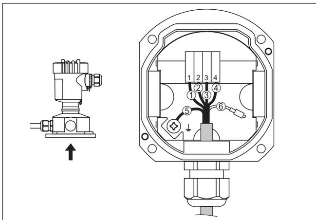
Figura 26: Allacciamento dell'unità di processo nello zoccolo della custodia
