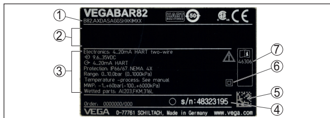
Abb. 1: Aufbau des Typschildes (Beispiel)
