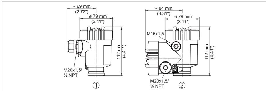
Abb. 40: Gehäuseausführungen in Schutzart IP66/IP67 (mit eingebautem Anzeige- und Bedienmodul vergrößert sich die Gehäusehöhe um 9 mm/0.35 in)
