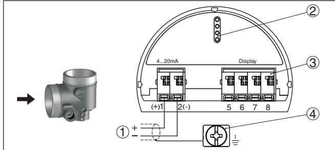
Abb. 14: Anschlussraum - Zweikammergehäuse
