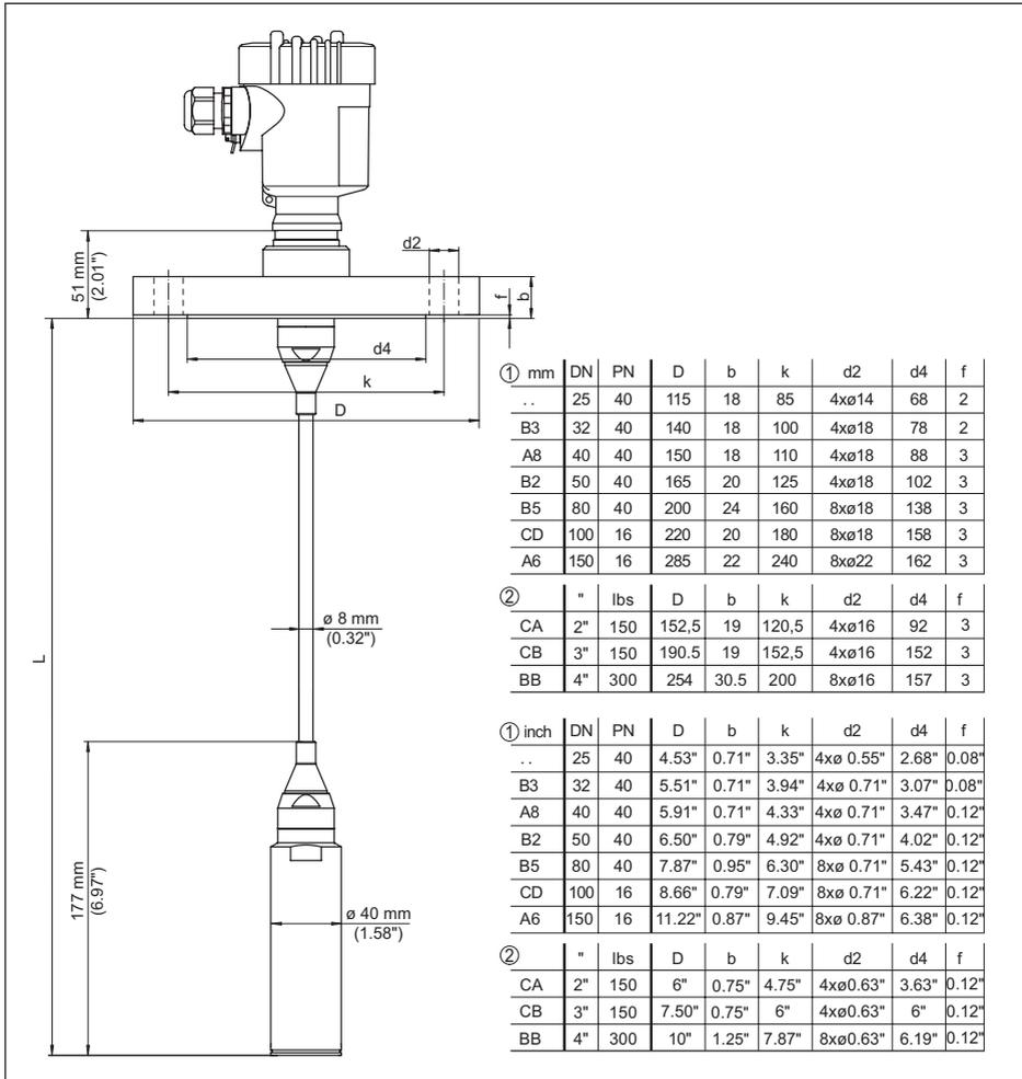
Abb. 48: VEGABAR 87, Flanschanschluss
