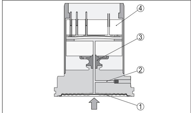
Abb. 3: Aufbau der METEC®-Messzelle beim VEGABAR 87
