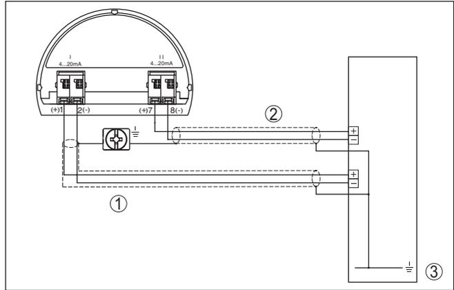
Abb. 25: Anschlussbeispiel VEGABAR 87 zusätzlicher Stromausgang
