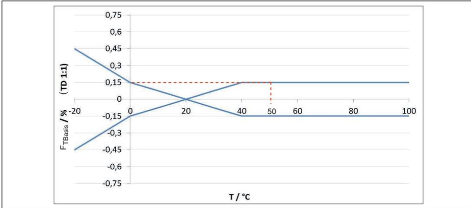
Abb. 39: Ermittlung des Basis-Temperaturfehlers für das Beispiel oben:  $F_{TBasis} = 0,15\%$
