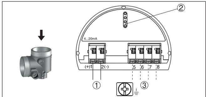
Abb. 17: Elektronikraum - Ex d ia-Zweikammergehäuse
