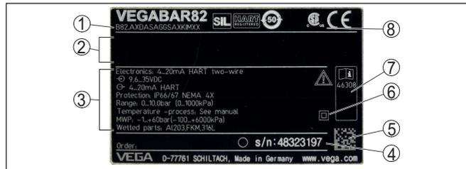
Abb. 1: Aufbau des Typschildes (Beispiel)
