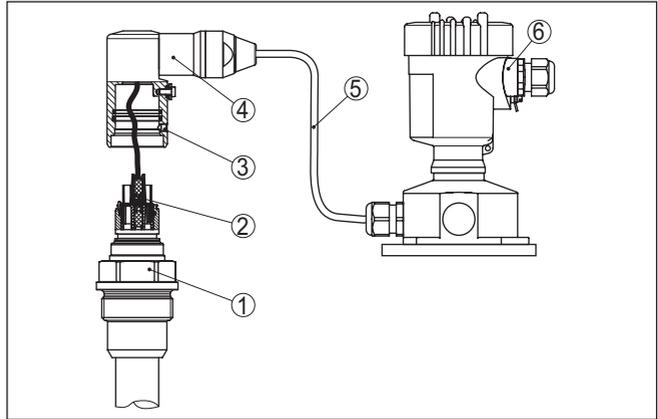
Abb. 35: VEGABAR 87 in IP68-Ausführung 25 bar und seitlichem Kabelabgang, externes Gehäuse
