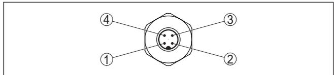
Abb. 20: Sicht auf den M12 x 1-Steckverbinder
