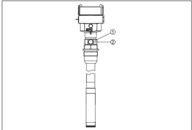
Abb. 7: Position des Filterelementes - Ex d-Ausführung
