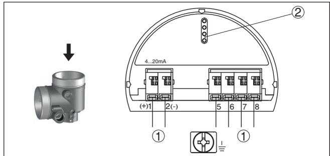
Abb. 13: Elektronikraum - Zweikammergehäuse
