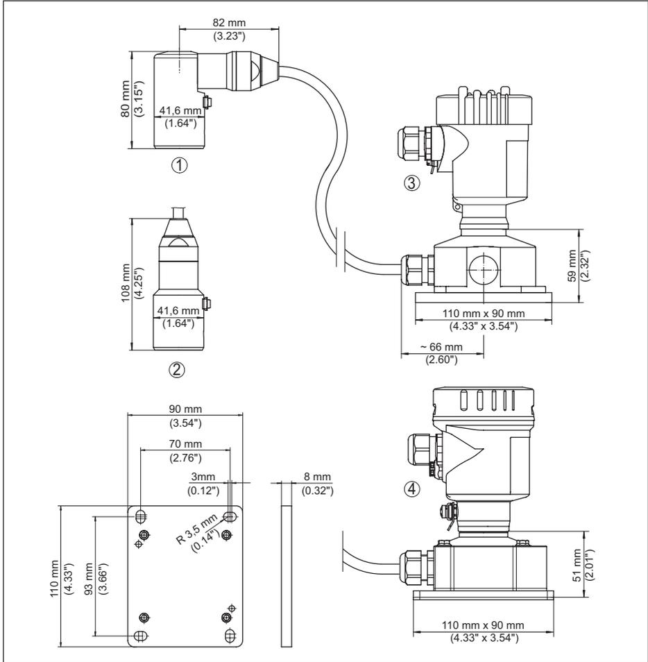
Abb. 46: VEGABAR 87, IP68-Ausführung mit externem Gehäuse
