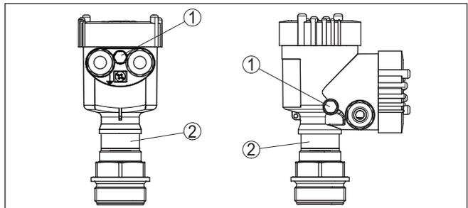
Abb. 8: Position des Filterelementes - gasdichte Durchführung
