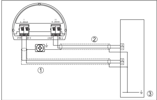
Abb. 25: Anschlussbeispiel VEGABAR 87 zusätzlicher Stromausgang
