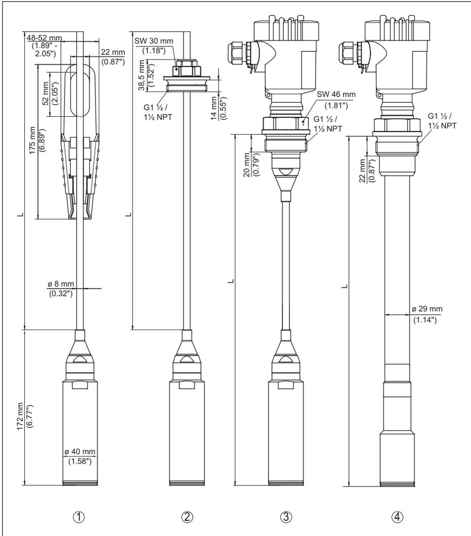
Abb. 47: VEGABAR 87, Standardanschlüsse
