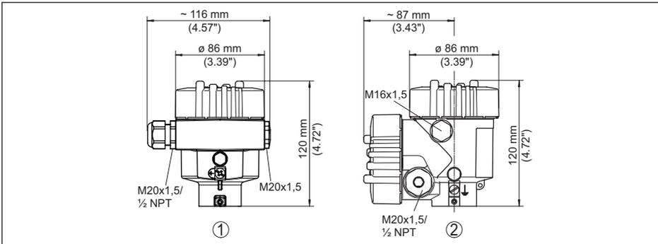
Abb. 41: Gehäuseausführungen in Schutzart IP66/IP68 (0,2 bar), (mit eingebautem Anzeige- und Bedienmodul vergrößert sich die Gehäusehöhe um 18 mm/0.71 in)
