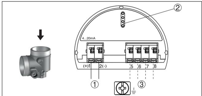
Abb. 17: Elektronikraum - Ex d ia-Zweikammergehäuse
