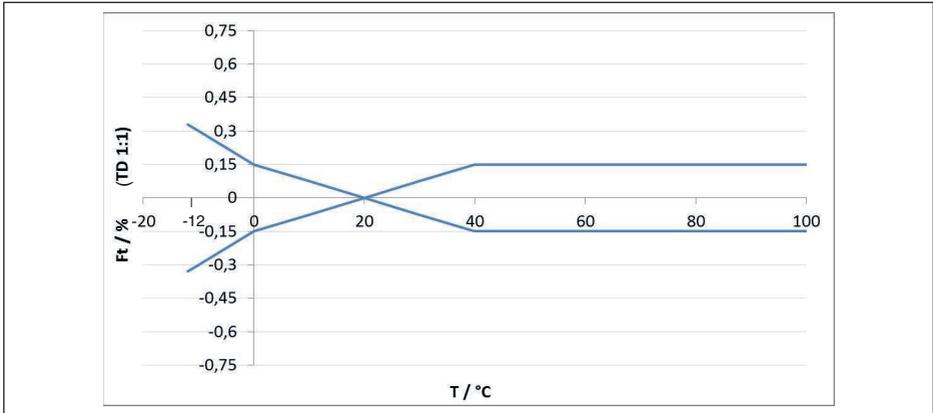
Abb. 37: Basis-Temperaturfehler  $F_{T_{Basis}}$  bei TD 1 : 1
