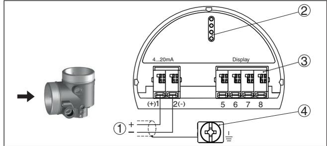
Abb. 14: Anschlussraum - Zweikammergehäuse
