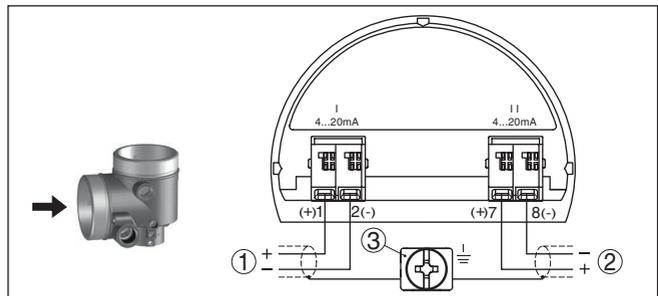
Abb. 15: Anschlussraum Zweikammergehäuse, Zusatzelektronik - Zusätzlicher Stromausgang
