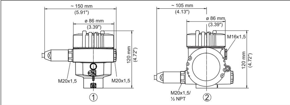
Abb. 39: Gehäuseausführungen in Schutzart IP66/IP68 (1 bar), (mit eingebautem Anzeige- und Bedienmodul vergrößert sich die Gehäusehöhe um 18 mm/0.71 in)
