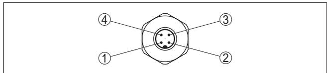
Abb. 18: Sicht auf den M12 x 1-Steckverbinder
