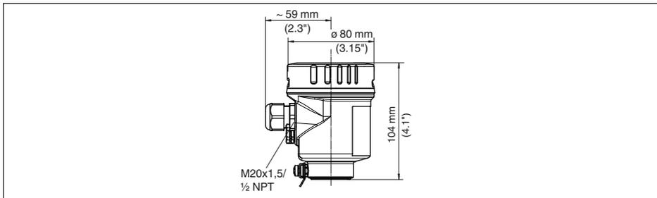
Abb. 42: Gehäuseausführung in Schutzart IP69K (mit eingebautem Anzeige- und Bedienmodul vergrößert sich die Gehäusehöhe um 9 mm/0.35 in)
