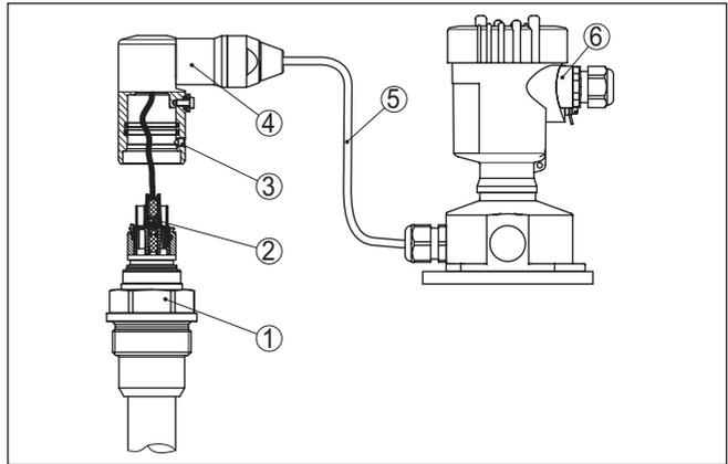
Abb. 30: VEGABAR 87 in IP68-Ausführung 25 bar und seitlichem Kabelabgang, externes Gehäuse
