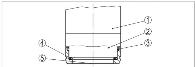
Abb. 5: Frontbündiger Einbau der keramischen Messzelle mit Doppeldichtung
