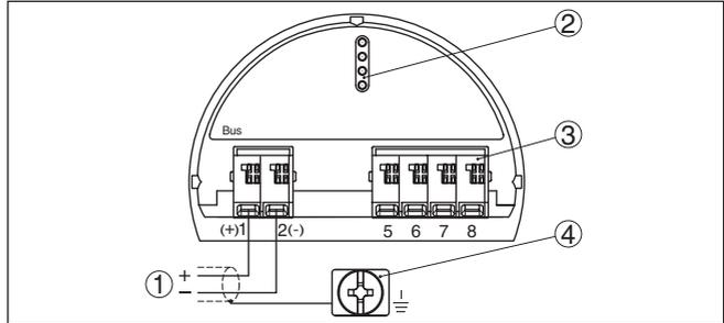
Abb. 16: Anschlussraum - Zweikammergehäuse
