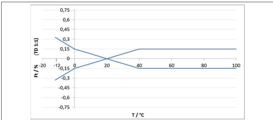
Abb. 32: Basis-Temperaturfehler  $F_{T_{Basis}}$  bei TD 1 : 1
