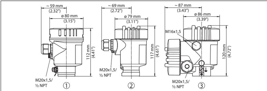
Abb. 40: Gehäuseausführungen in Schutzart IP66/IP68 (0,2 bar), (mit eingebautem Anzeige- und Bedienmodul vergrößert sich die Gehäusehöhe um 9 mm/0.35 in bzw. 18 mm/0.71 in)
