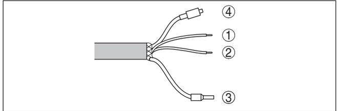
Abb. 18: Aderbelegung Anschlusskabel
