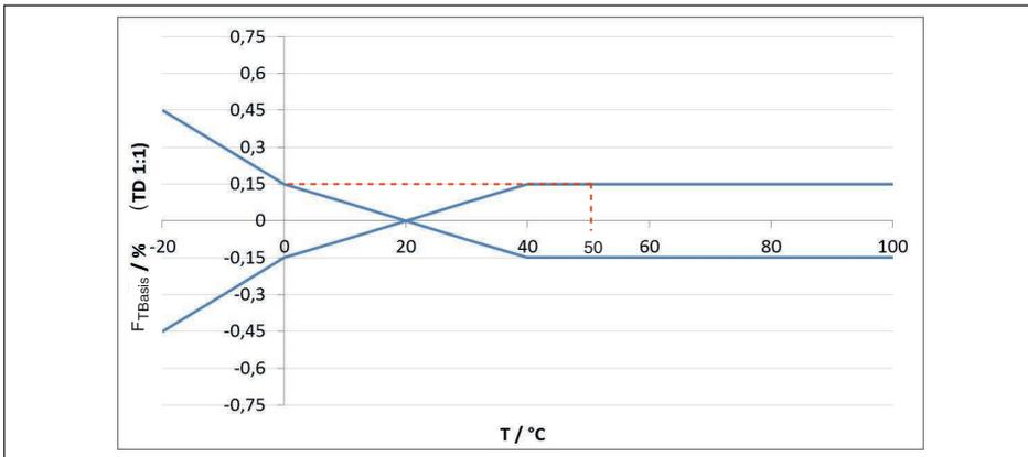
Abb. 36: Ermittlung des Basis-Temperaturfehlers für das Beispiel oben:  $F_{TBasis} = 0,15\%$
