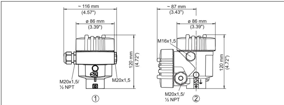
Abb. 38: Gehäuseausführungen in Schutzart IP66/IP68 (0,2 bar), (mit eingebautem Anzeige- und Bedienmodul vergrößert sich die Gehäusehöhe um 18 mm/0.71 in)
