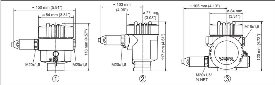
Abb. 41: Gehäuseausführungen in Schutzart IP66/IP68 (1 bar), (mit eingebautem Anzeige- und Bedienmodul vergrößert sich die Gehäusehöhe um 9 mm/0.35 in bzw. 18 mm/0.71 in)
