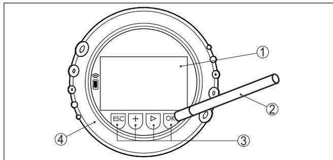
Abb. 25: Anzeige- und Bedienelemente - mit Bedienung über Magnetstift
