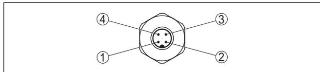
Abb. 17: Sicht auf den M12 x 1-Steckverbinder
