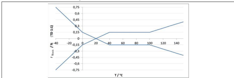
Fig. 31: Error de temperatura básico  $F_{TBasis}$  con TD 1 : 1
