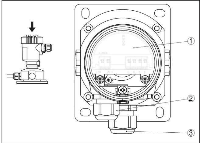
Fig. 23: Compartimento de la electrónica y de conexiones
