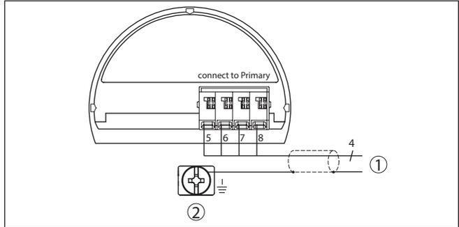
Fig. 25: Esquema de conexiones VEGABAR 82 dispositivo secundario
