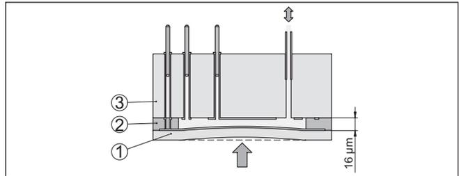
Fig. 2: Estructura de la celda de medición CERTEC®
