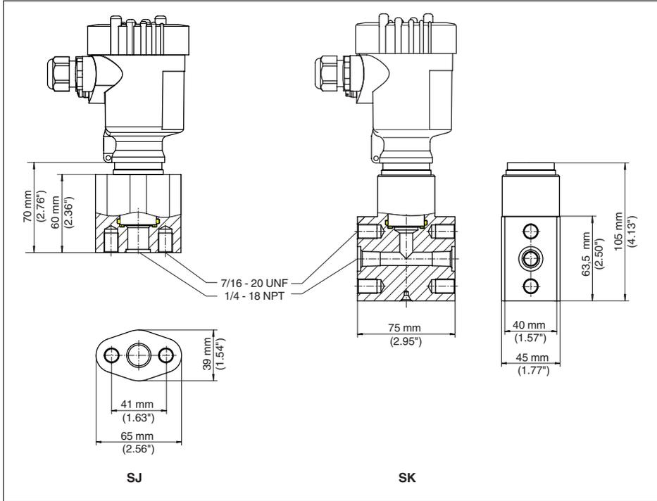
Fig. 45: VEGABAR 82, conexión según IEC 61518
