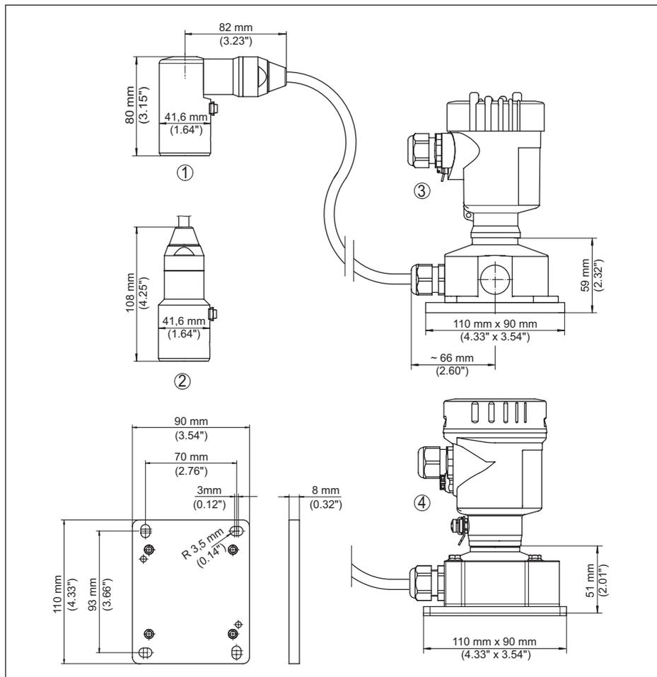
Fig. 37: VEGABAR 82, Versión IP68 con carcasa externa
