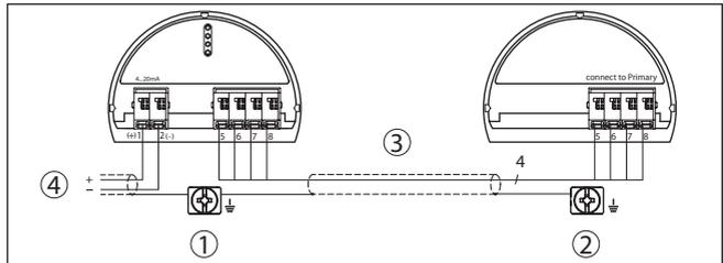
Fig. 26: Ejemplo de conexión presión diferencial electrónica
