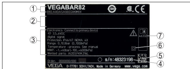
Figura 1: Struttura della targhetta d'identificazione (esempio)
