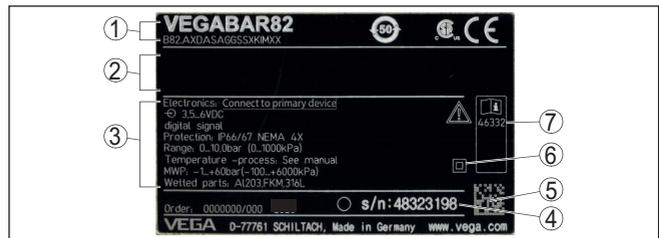
Abb. 1: Aufbau des Typschildes (Beispiel)
