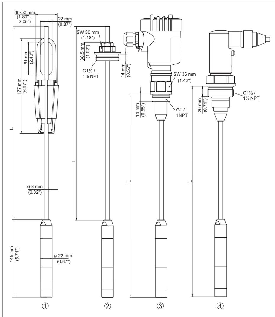
Figura 30: VEGABAR 86, elemento primario di misura 22 mm
