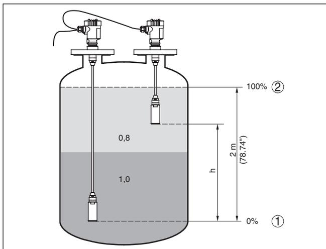
Figura 21: Esempio di parametrizzazione taratura di min./max. per misura d'interfaccia
