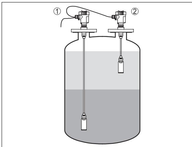
Figura 2: Esempio misura elettronica di pressione differenziale per la misura d'interfaccia
