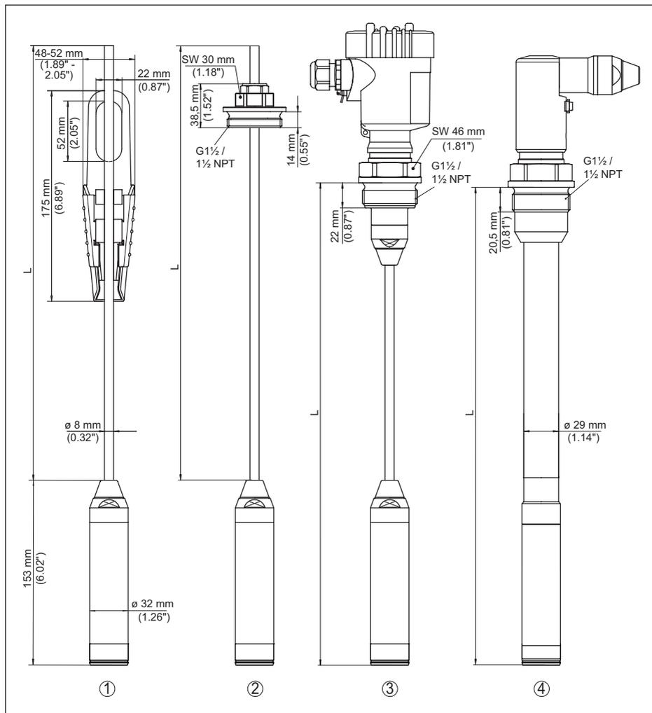
Figura 29: VEGABAR 86, elemento primario di misura 32 mm
