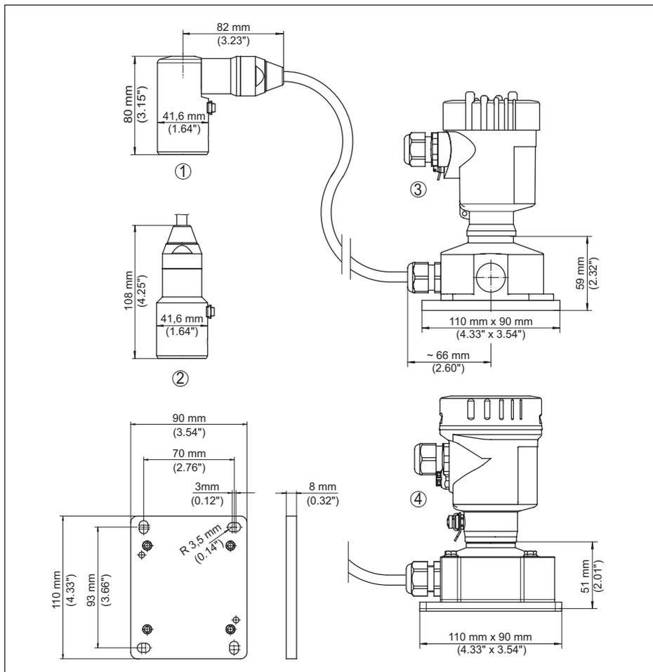
Figura 28: VEGABAR 86, esecuzione IP68 con custodia esterna
