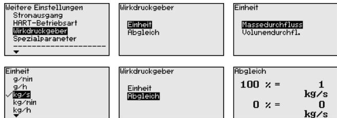
Weiterhin wird der Abgleich für den Volumen- bzw. Massendurchfluss bei 0 % bzw. 100 % durchgeführt.
