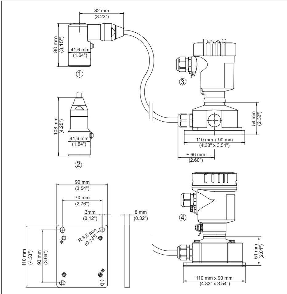
Abb. 28: VEGABAR 87, IP68-Ausführung mit externem Gehäuse
