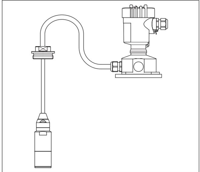
Abb. 16: VEGABAR 87 in IP68-Ausführung 25 bar, nicht-Ex und axialem Kabelabgang, externes Gehäuse
