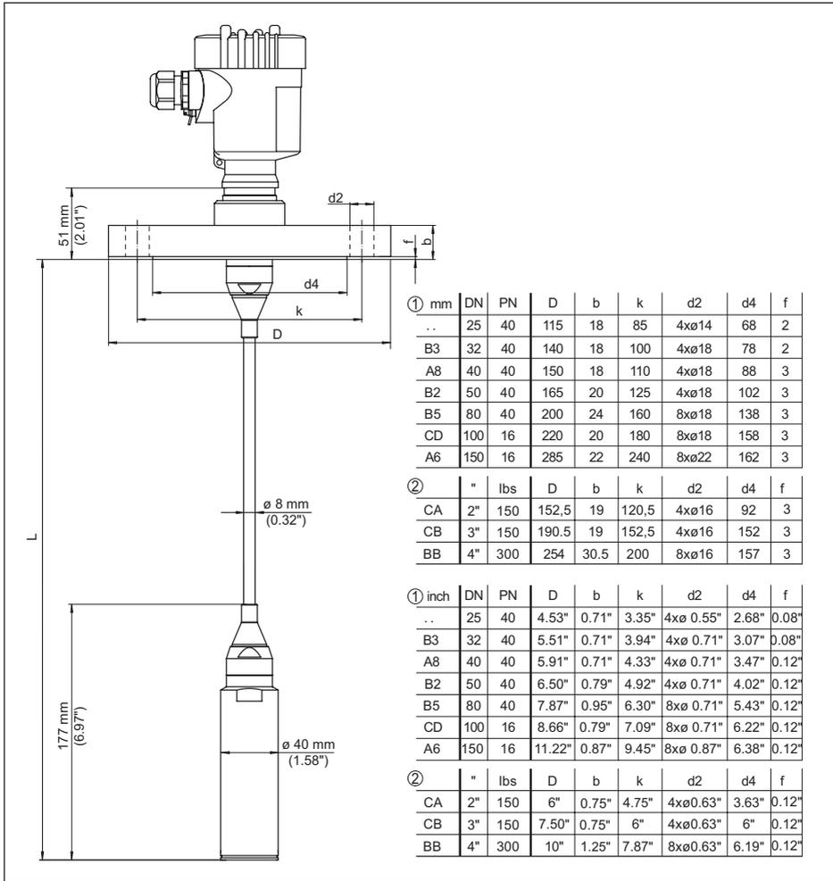
Abb. 30: VEGABAR 87, Flanschanschluss
