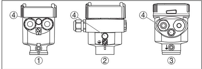
Abb. 6: Position des Filterelementes - Nicht-Ex- und Ex ia-Ausführung
