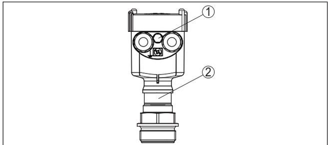
Abb. 7: Position des Filterelementes - gaskichte Durchführung
