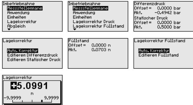
Bei der automatischen Lagekorrektur wird der aktuelle Messwert als Korrekturwert übernommen. Er darf dabei nicht durch Füllgutbedeckung oder einen statischen Druck verfälscht sein.
