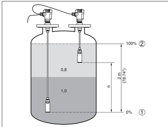
Figura 22: Esempio di parametrizzazione taratura di min./max. per misura d'interfaccia
