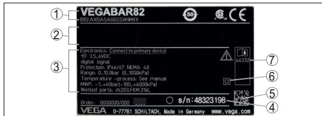
Figura 1: Struttura della targhetta d'identificazione (esempio)
