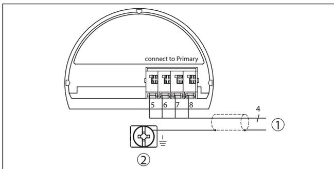
Figura 20: Schema di collegamento VEGABAR 87 secondary device
