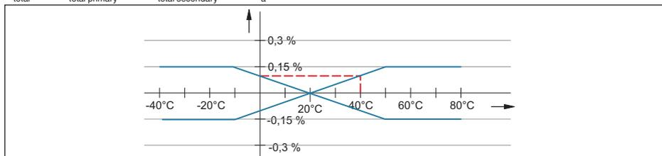
Figura 27:  $F_a$  dovuto a variazione termica dell'uscita in corrente, in questo esempio = 0,1%
