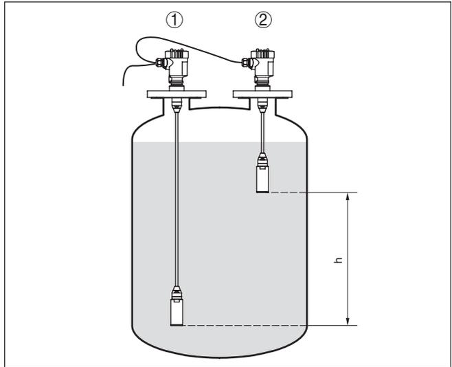
Figura 12: Configurazione di misura per la misura di densità,  $h$  = distanza tra i due punti di misura
