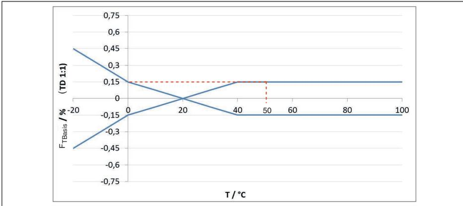
Figura 26: Calcolo dell'errore di temperatura base per il suddetto esempio:  $F_{TBasis} = 0,15\%$
