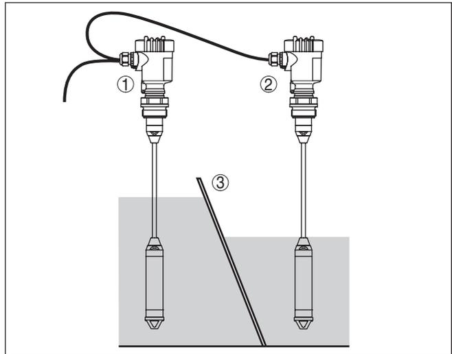
Figura 10: Configurazione di misura per la misura della differenza di altezza
