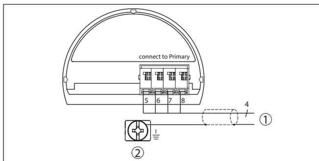
Figura 16: Schema di collegamento VEGABAR 87 secondary device
