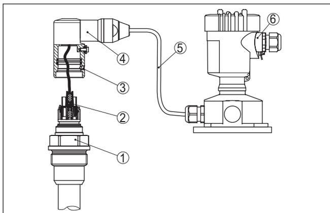
Figura 23: VEGABAR 87 in esecuzione IP68 25 bar e uscita del cavo laterale, custodia esterna
