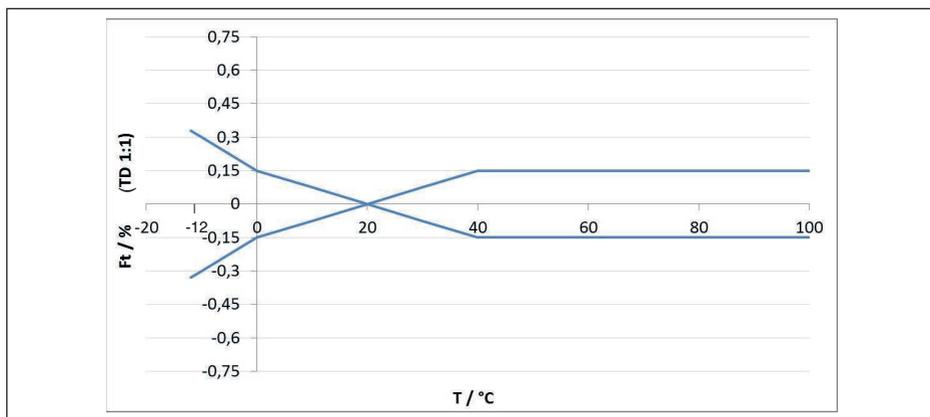
Figura 25: Errore di temperatura base  $F_{TBasis}$  con TD 1 : 1
