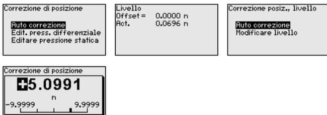
Per la correzione automatica di posizione si assume l'attuale valore di misura come valore di correzione. Questo valore non deve essere falsificato a causa di immersione nel prodotto o pressione statica.
