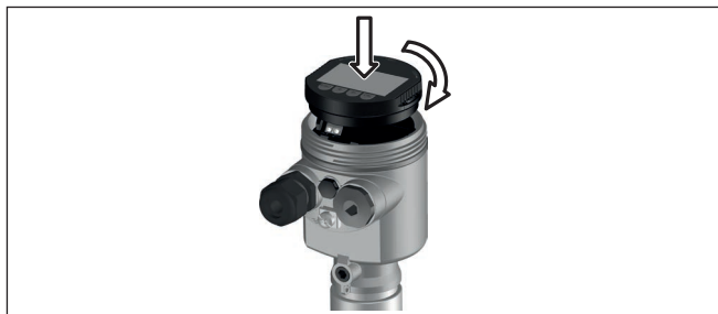
插图. 18: 将显示和调整模块装入单腔式壳体的电子部件腔中
