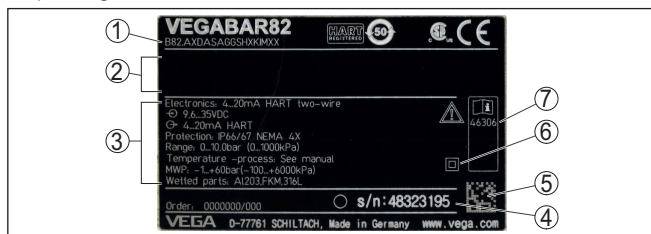
Fig. 1: Opbouw van de typeplaat (voorbeeld)
