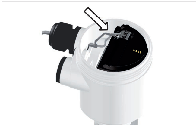
Abb. 12: Anschlusschritte 5 und 6 - Einkammergehäuse
