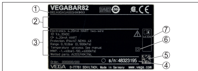
Abb. 1: Aufbau des Typschildes (Beispiel)
