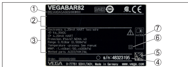
Figura 1: Struttura della targhetta d'identificazione (esempio)
