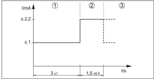
插图. 3: 功能测试的过程图表
