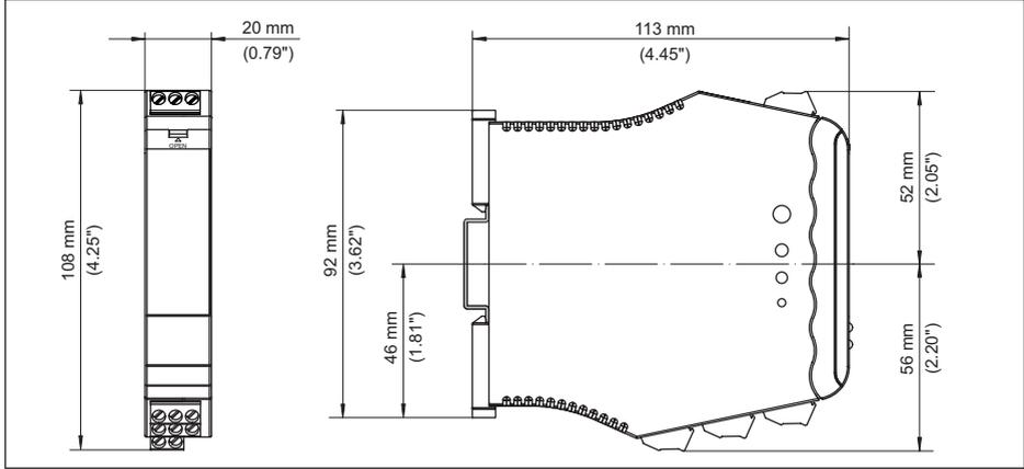
Fig. 20: Medidas VEGATOR 111
