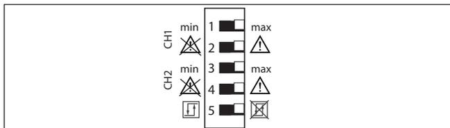
Figura 3: Commutatori DIL VEGATOR 112
