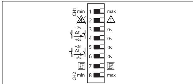
Abb. 2: DIL-Schalter VEGATOR 122
