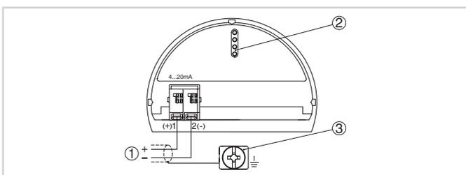
Vano dell'elettronica e di connessione, custodia a una camera
