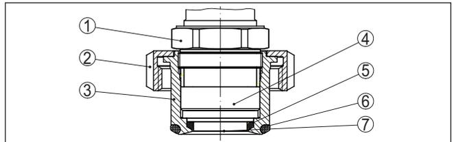
Abb. 33: VEGABAR 82, Aufbau aseptischer Anschluss mit Nutüberwurfmutter
