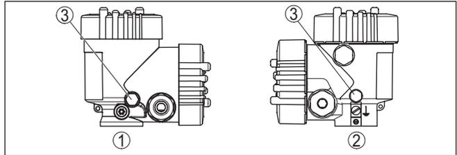
Abb. 11: Position des Filterelementes
