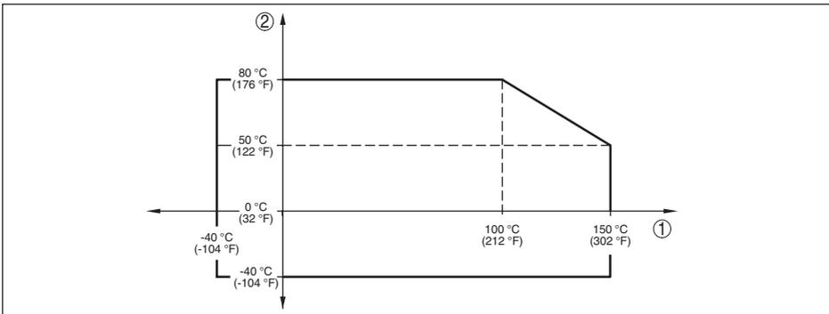
Abb. 39: Temperaturderating VEGABAR 82, Ausführung bis +150 °C (+302 °F)
