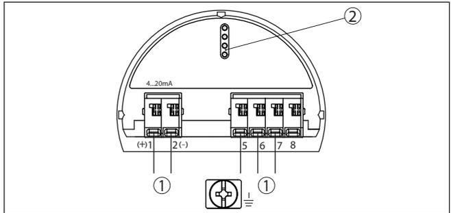
Abb. 19: Elektronikraum - Zweikammergehäuse
