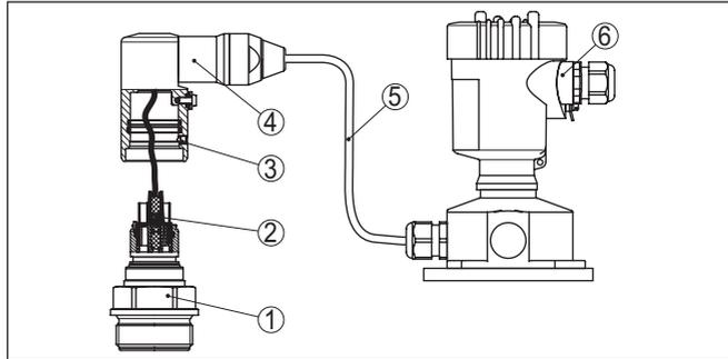
Abb. 35: VEGABAR 82 in IP68-Ausführung 25 bar und seitlichem Kabelabgang, externes Gehäuse
