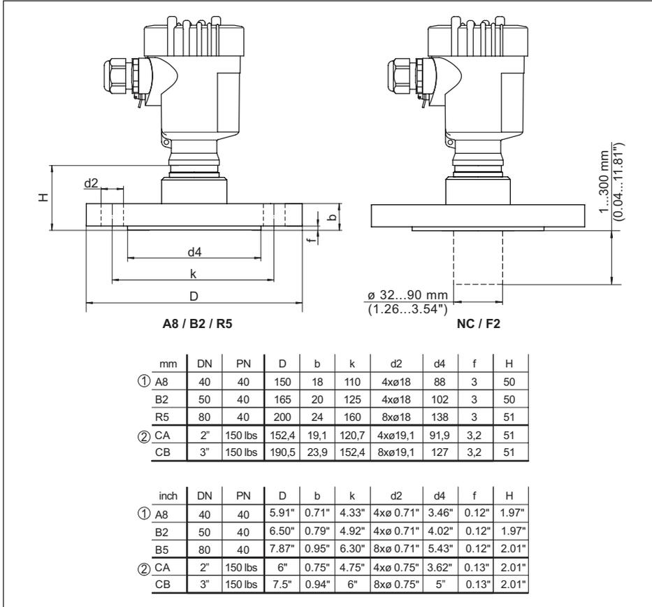
Abb. 48: VEGABAR 82, Flanschanschluss
