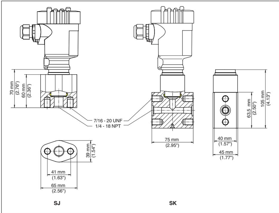
Abb. 51: VEGABAR 82, Anschluss nach IEC 61518
