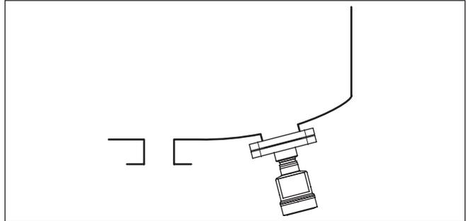
Abb. 15: Messanordnung bei Füllstandmessung
