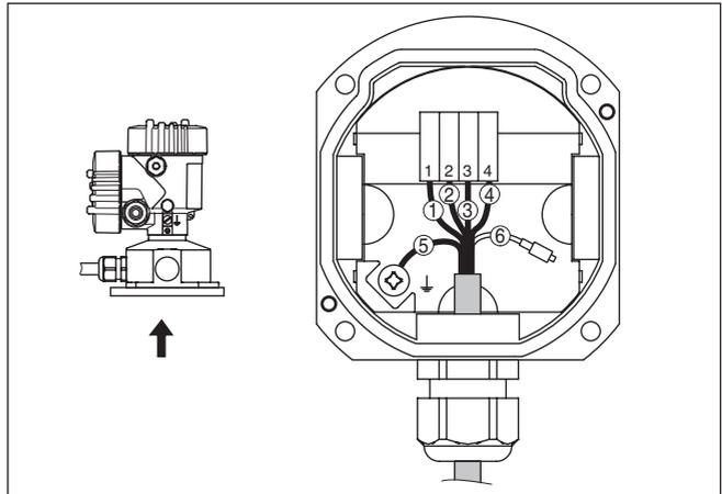
Abb. 23: Anschluss des Sensors im Gehäusesockel
