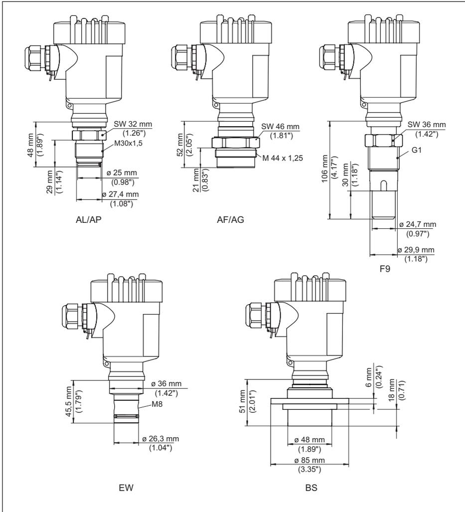
Abb. 49: VEGABAR 82, Tubusanschluss
