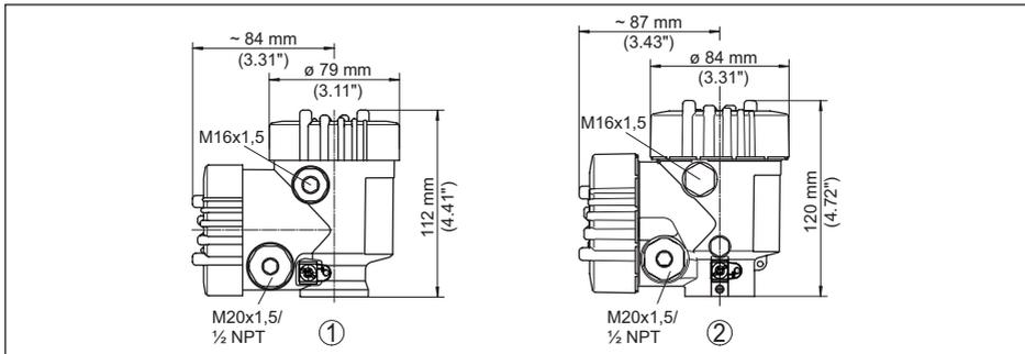
Abb. 42: Maße Gehäuse (mit eingebautem Anzeige- und Bedienmodul vergrößert sich die Gehäusehöhe um 9 mm/0.35 in bzw. 18 mm/0.71 in)
