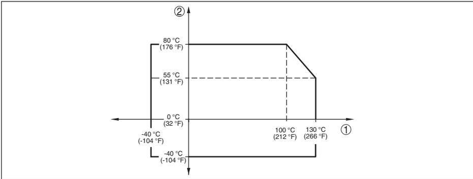
Abb. 38: Temperaturderating VEGABAR 82, Ausführung bis +130 °C (+266 °F)
