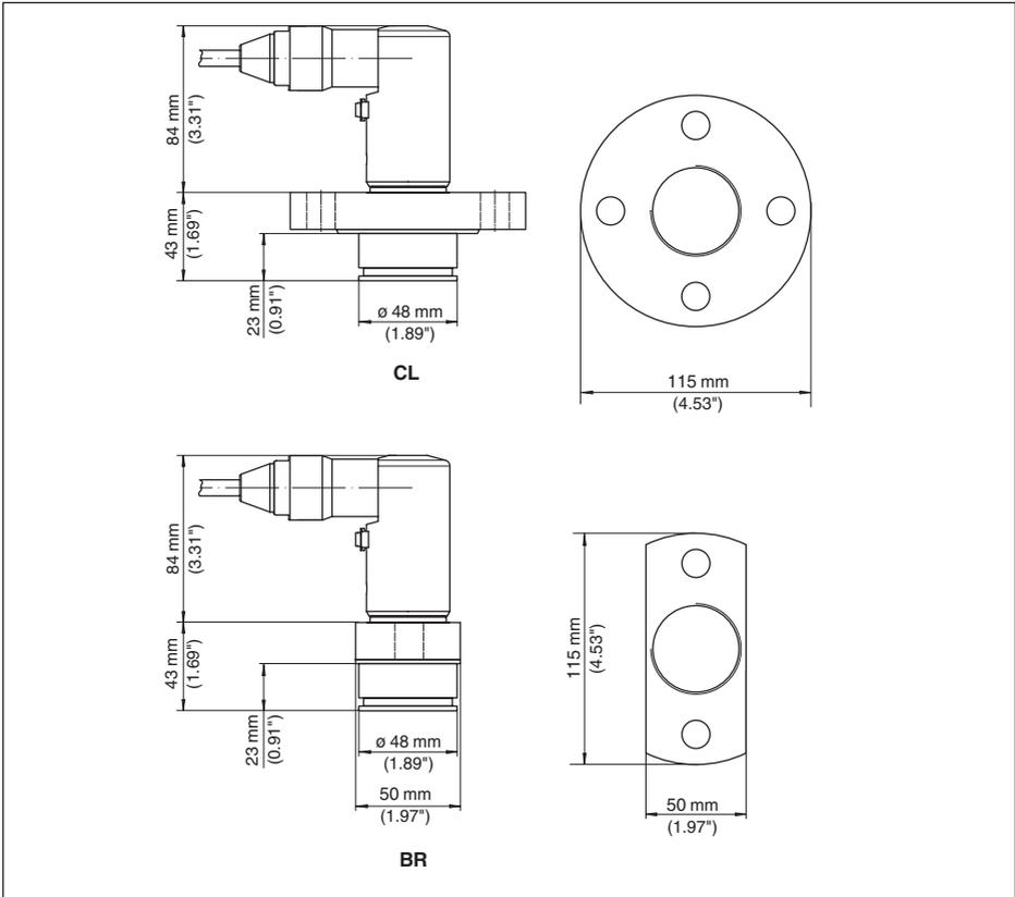
Abb. 50: VEGABAR 82, Flanschanschluss für die Papierindustrie: CL = absolut frontbündig für Stoffauflauf, BR = absolut frontbündig für Stoffauflauf (Flansch 2-fach abgefacht)
