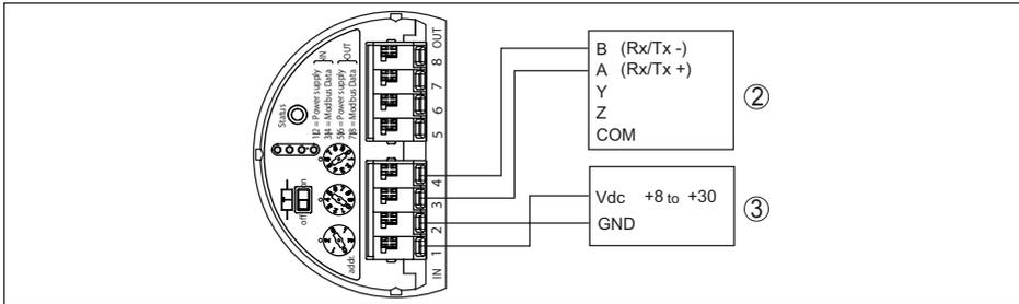
Abb. 40: Anschluss des VEGABAR 82 an RTU Fisher ROC 809
