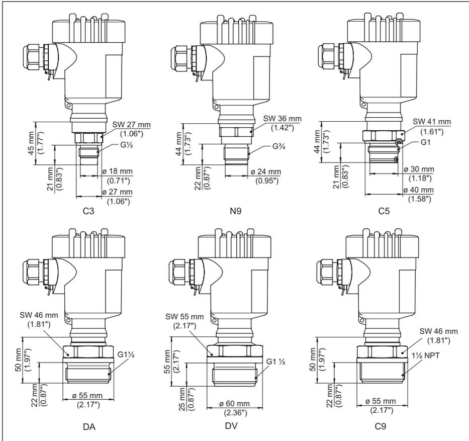
Abb. 45: VEGABAR 82, Gewindeanschluss frontbündig
