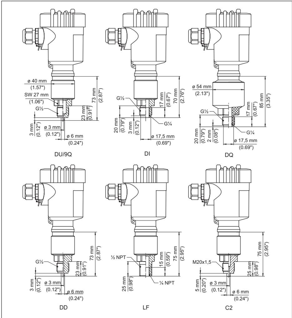
Abb. 44: VEGABAR 82, Gewindeanschluss nicht frontbündig
