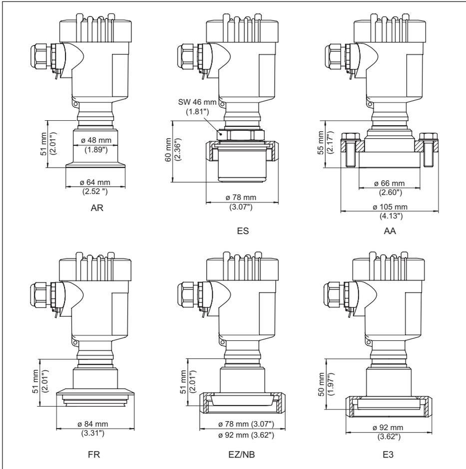
Abb. 47: VEGABAR 82, Hygieneanschluss
