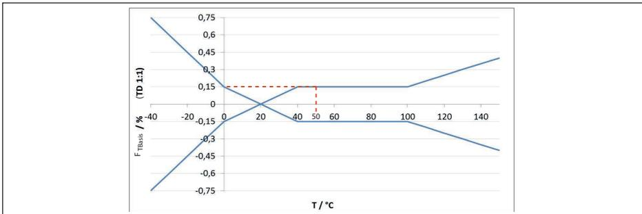
Abb. 41: Ermittlung des Basis-Temperaturfehlers für das Beispiel oben:  $F_{T\text{Basis}} = \mathbf{0,15 \%}$
