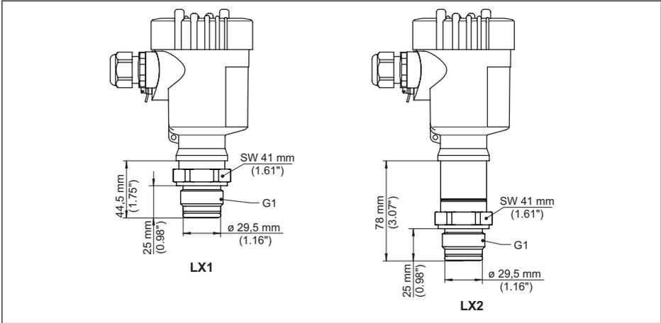
Abb. 46: VEGABAR 82, Gewinde für Hygieneadapter
