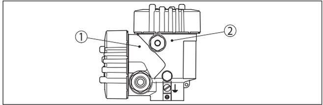
Abb. 18: Position von Anschlussraum (Modbuselektronik) und Elektronikraum (Sensorelektronik)
