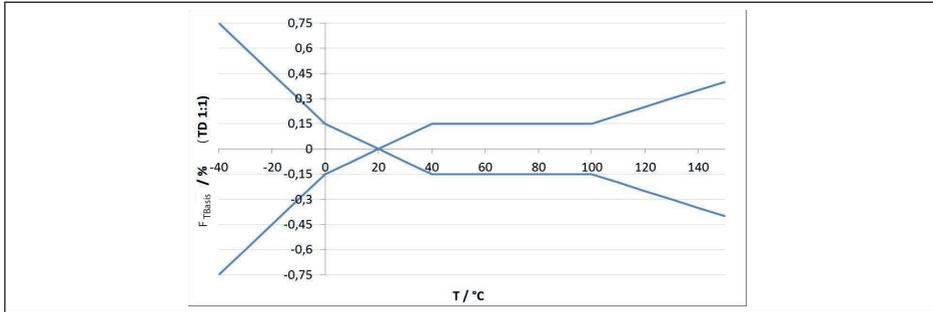
Abb. 37: Basis-Temperaturfehler  $F_{T_{Basis}}$  bei TD 1 : 1
