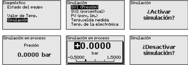
Seleccionar la magnitud de simulación deseada y ajustar el valor numérico deseado.
