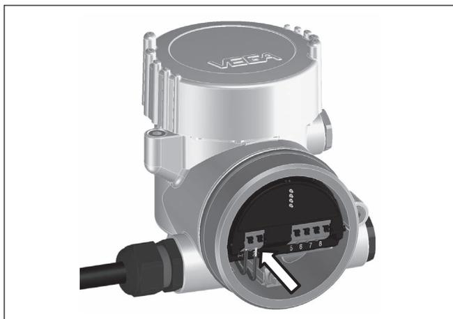
Figura 9: Operazioni di collegamento 5 e 6
