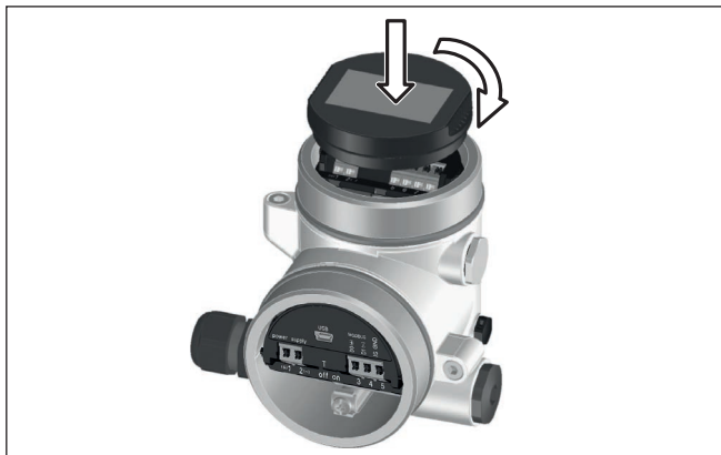
Abb. 16: Einsetzen des Anzeige- und Bedienmoduls
