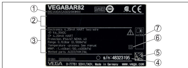
Abb. 1: Aufbau des Typschildes (Beispiel)
