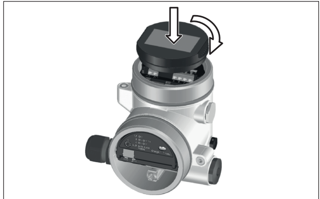
Abb. 6: Einsetzen des Anzeige- und Bedienmoduls
