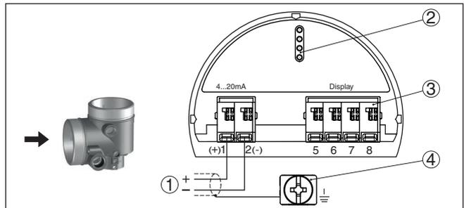
Abb. 4: Anschlussraum - Zweikammergehäuse
